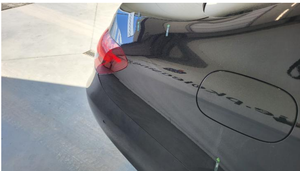
Photo 47. Błotnik tylny P / Ściana boczna P - Wgniecenie/odkształcenie 1
