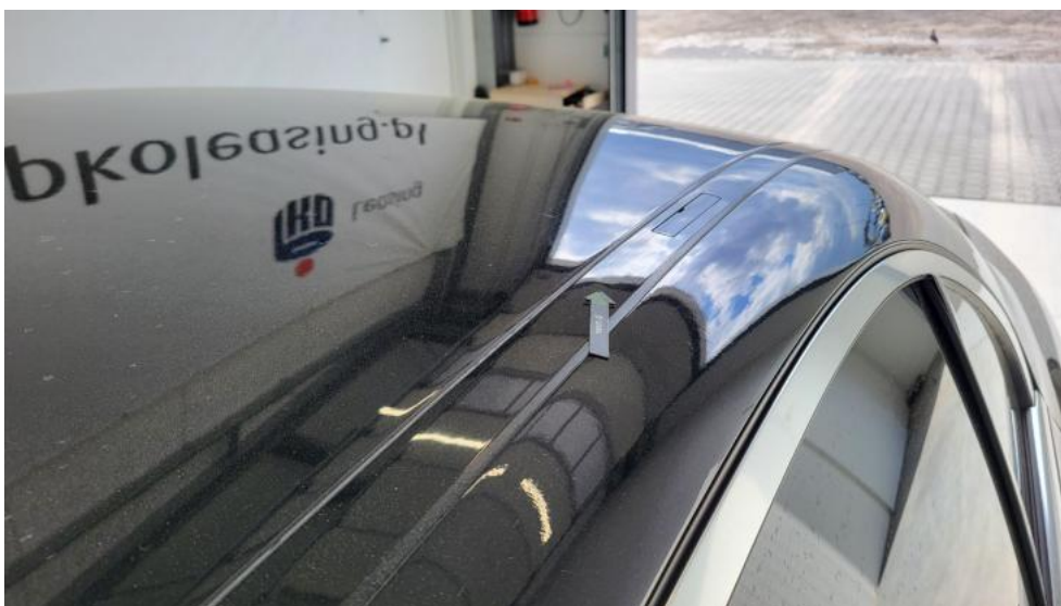
Photo 50. Listwy dachu lew. - Wgniecenie/odkształcenie 1
