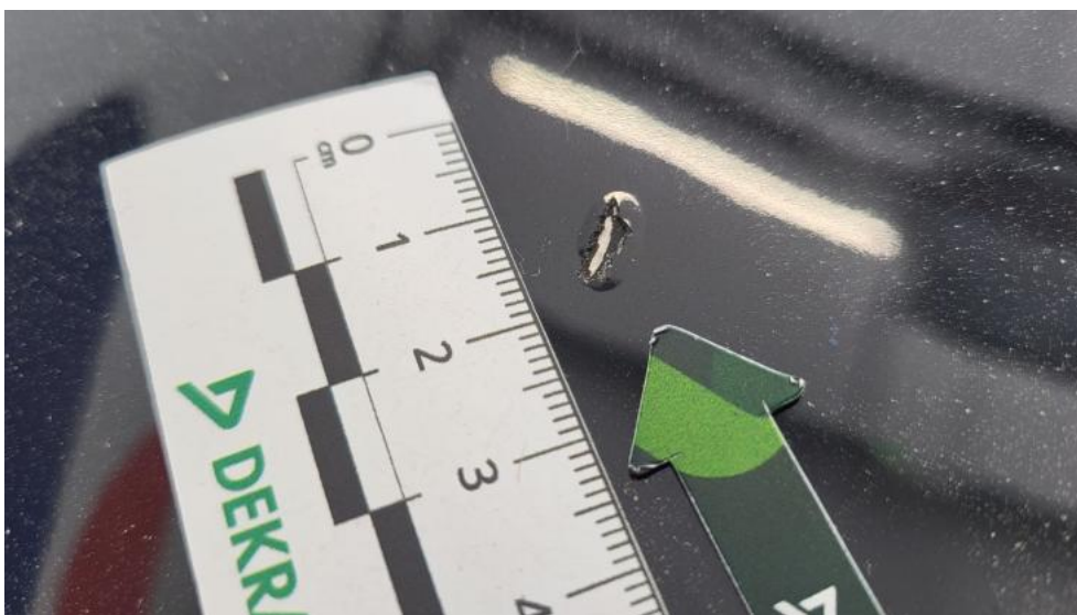
Photo 42. Pokrywa komory silnika - Rysa/odprysk 1
