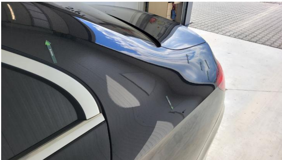
Photo 51. Błotnik tylny L / Ściana boczna L - Wgniecenie/odkształcenie 1
