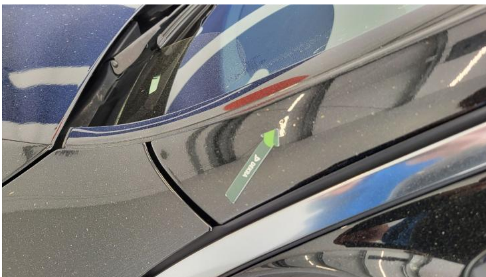
Photo 58. Słupek przedni L - Wgniecenie/odkształcenie 1
