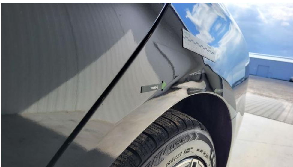
Photo 52. Błotnik tylny L / Ściana boczna L - Wgniecenie/odkształcenie 2
