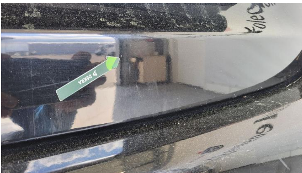
Photo 48. Pokrywy bagażnika - Wgniecenie/odkształcenie 1
