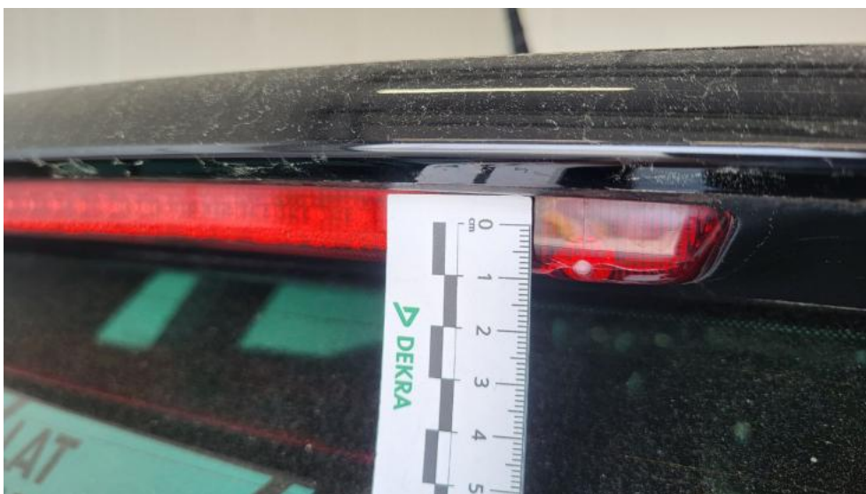
Fot. 52. Dodatkowa lampa stopu - Pęknięcie/rozerwanie 1
