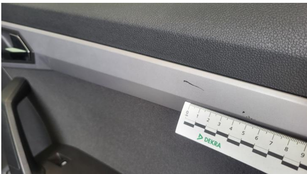
Fot. 70. Tapicerka drzwi przednich P - Rysa/odprysk 1
