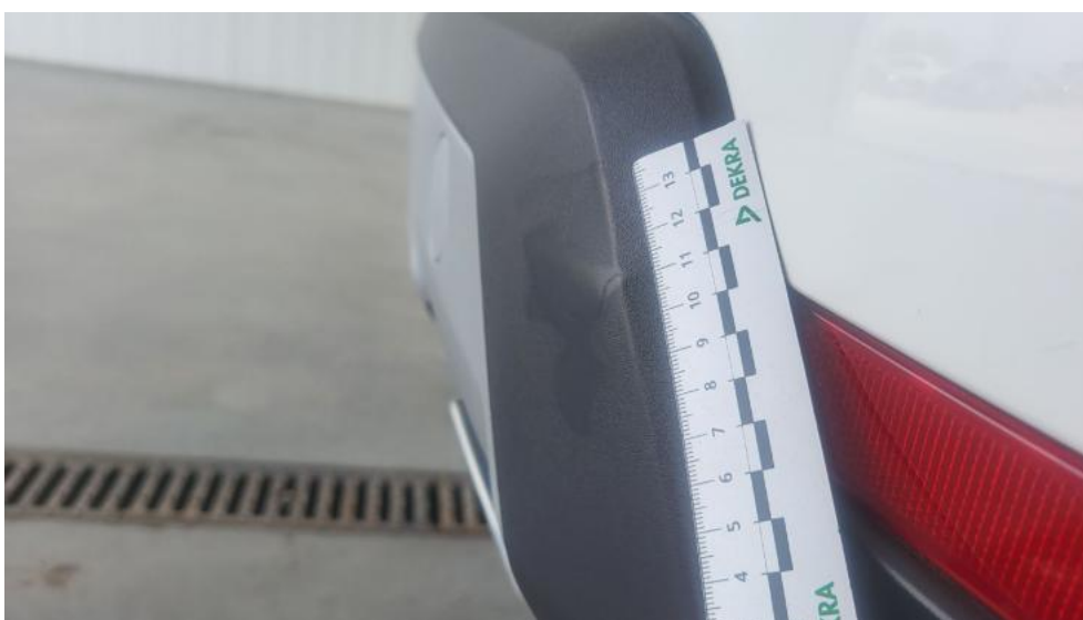
Fot. 54. Zderzak tylny cz dolna - Wgniecenie/odkształcenie 1
