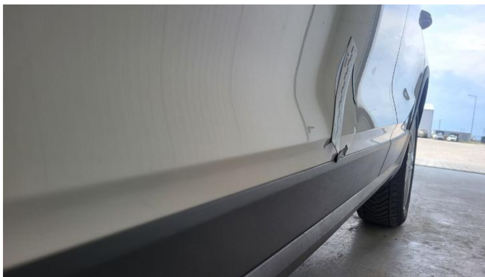
Fot. 57. Drzwi przed L - Wgniecenie/odkształcenie 1
