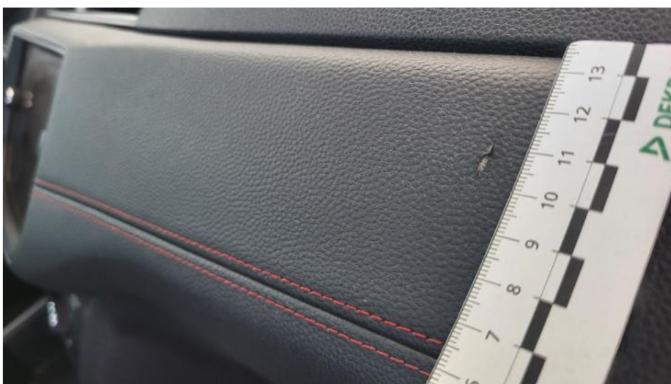
Fot. 62. Deska rozdzielcza - Pęknięcie/rozerwanie 1
