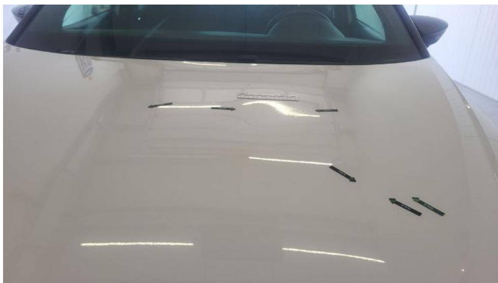
Fot. 40. Pokrywa komory silnika - Wgniecenie/odkształcenie 1
