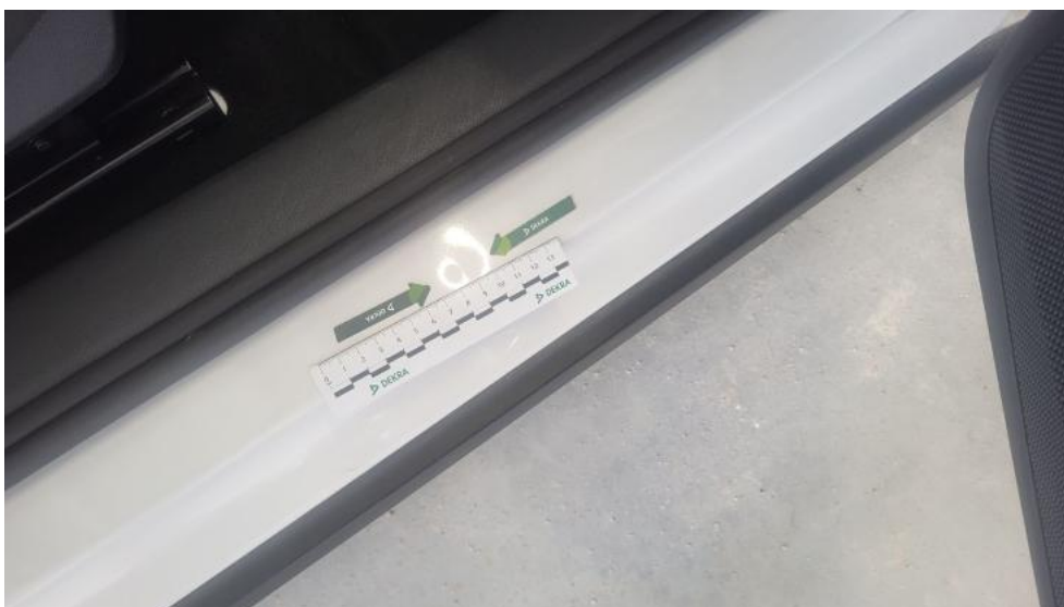
Fot. 48. Próg P - Wgniecenie/odkształcenie 1
