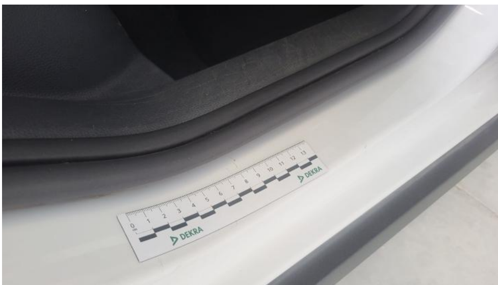
Fot. 47. Próg P - Rysa/odprysk 1
