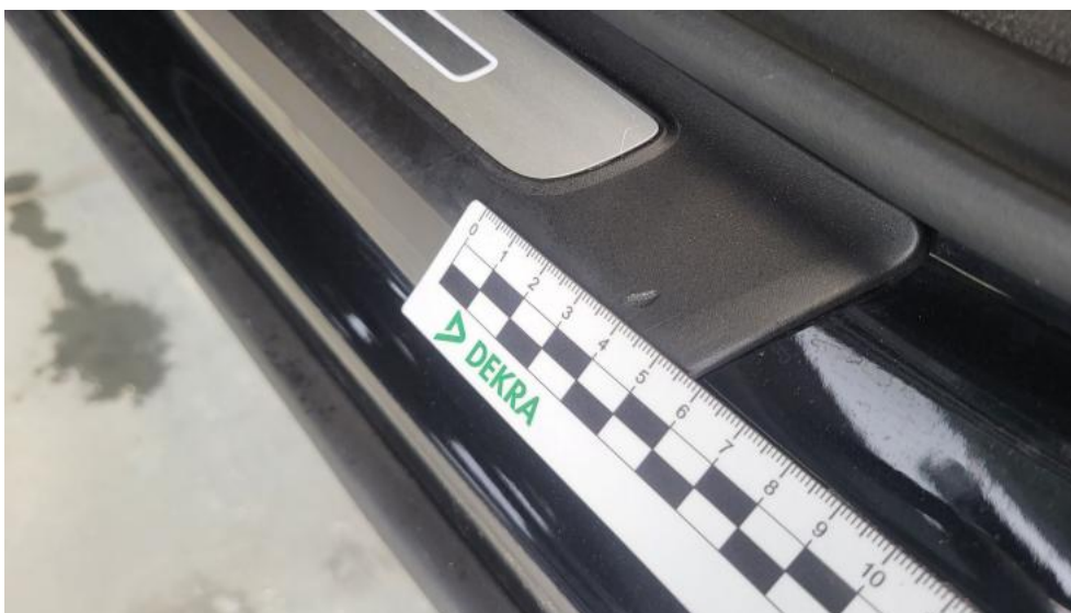
Fot. 81. Próg L - Wgniecenie/odkształcenie 1
