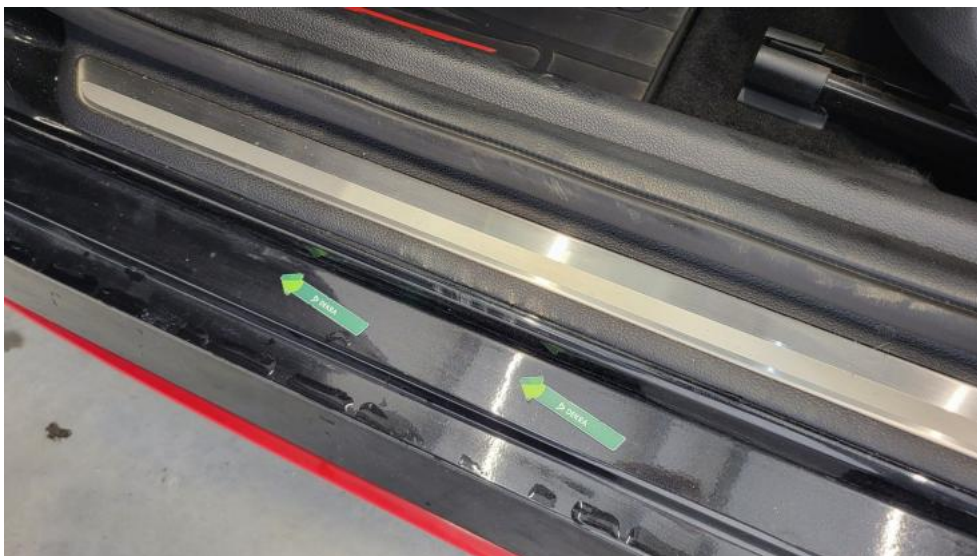
Fot. 69. Próg L - Wgniecenie/odkształcenie 1
