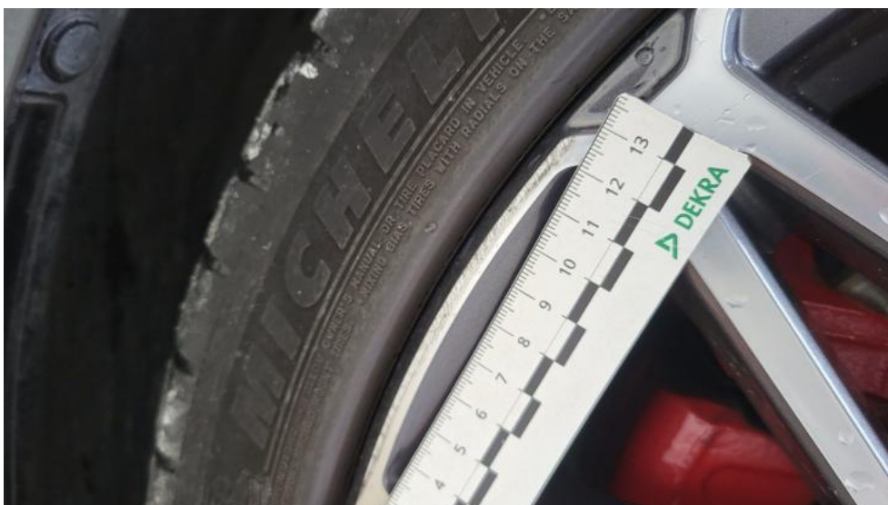
Fot. 70. Felga Aluminiowa przednia L - Rysa/odprysk 1
