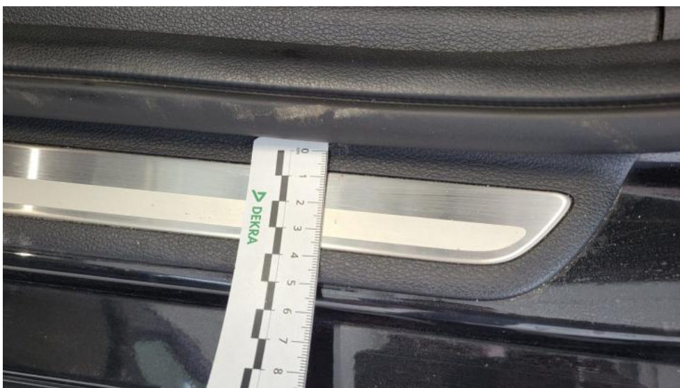
Fot. 76. Listwy progowe lew. - Rysa/odprysk 1
