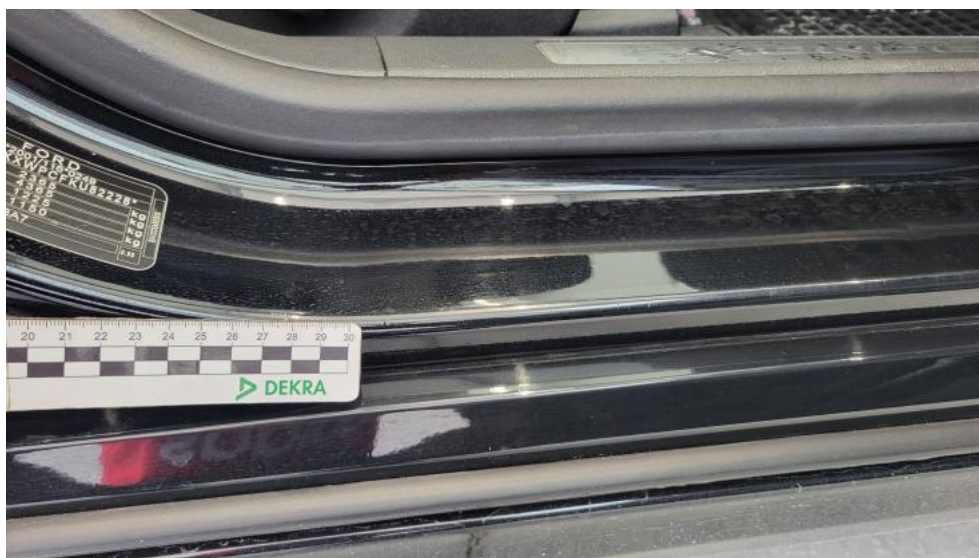
Fot. 50. Próg P - Rysa/odprysk 1
