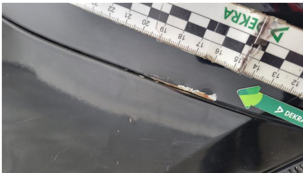
Fot. 55. Błotnik tylny P / Ściana boczna P - Inne 1
