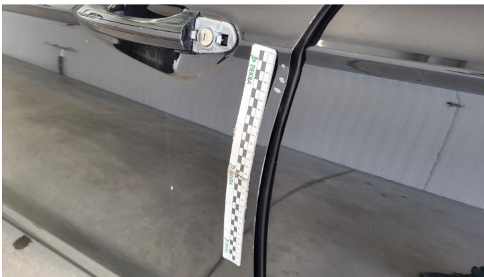
Fot. 63. Drzwi przed L - Rysa/odprysk 1
