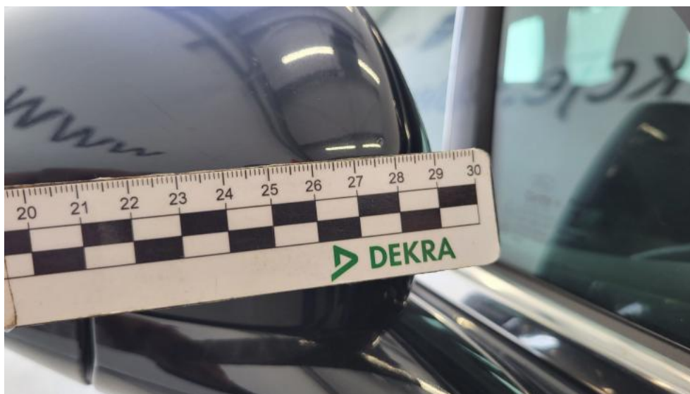
Fot. 49. Lusterko zew P - Rysa/odprysk 1
