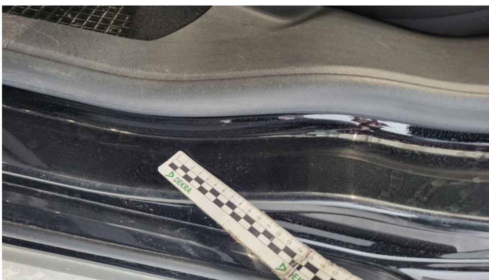
Fot. 66. Próg L - Rysa/odprysk 1
