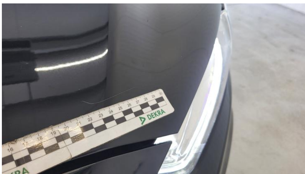
Fot. 40. Pokrywa komory silnika - Rysa/odprysk 2
