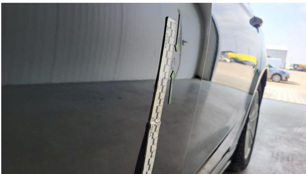
Fot. 64. Drzwi przed L - Wgniecenie/odkształcenie 1
