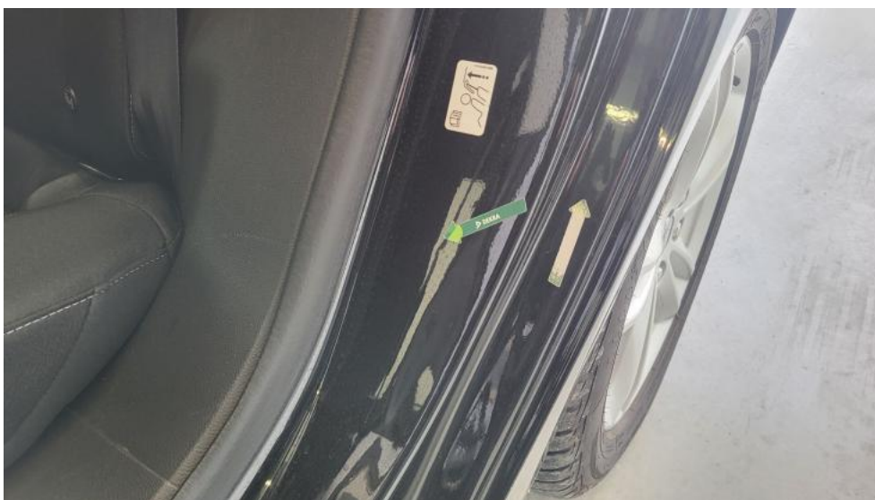
Fot. 62. Błotnik tylny L / Ściana boczna L - Wgniecenie/odkształcenie 2
