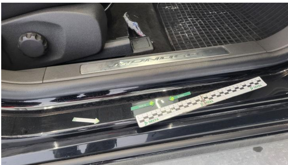
Fot. 51. Próg P - Wgniecenie/odkształcenie 1
