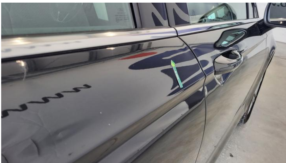
Fot. 48. Drzwi tylne P - Wgniecenie/odkształcenie 1
