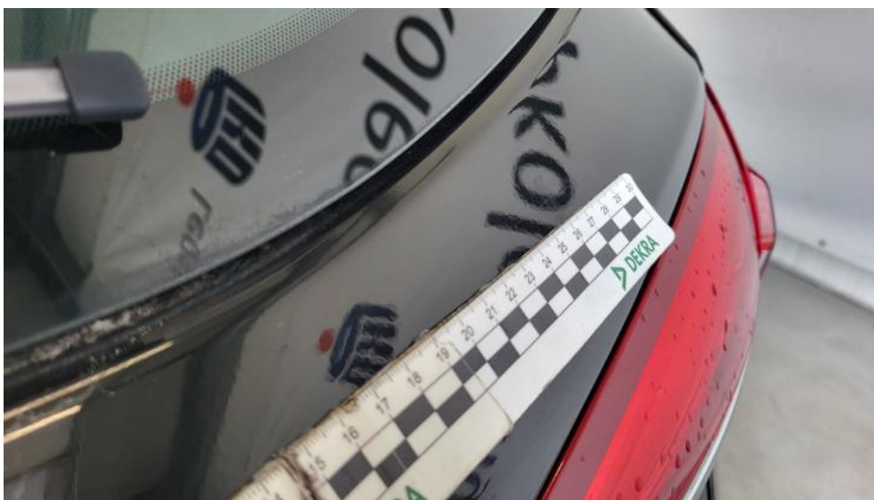
Fot. 57. Pokrywy bagażnika - Rysa/odprysk 1
