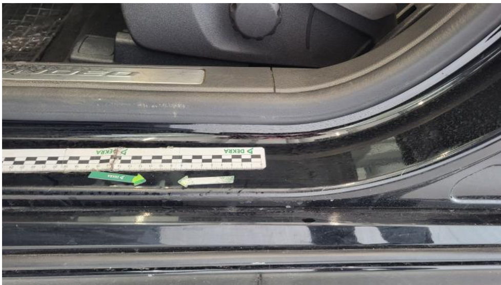
Fot. 67. Próg L - Wgniecenie/odkształcenie 1
