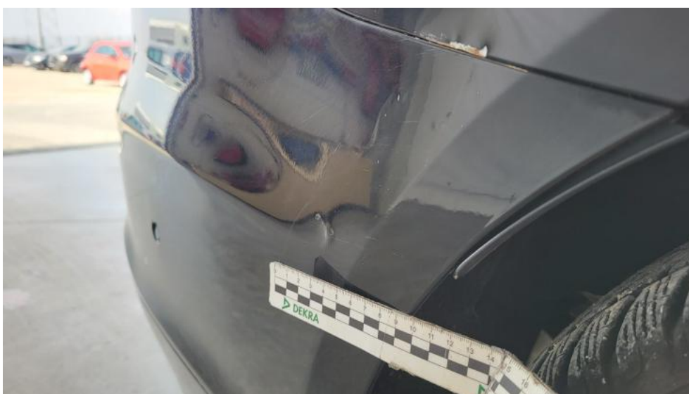
Fot. 60. Zderzak tylny - Wgniecenie/odkształcenie 1
