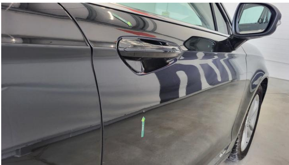
Fot. 46. Drzwi przednie P - Wgniecenie/odkształcenie 1
