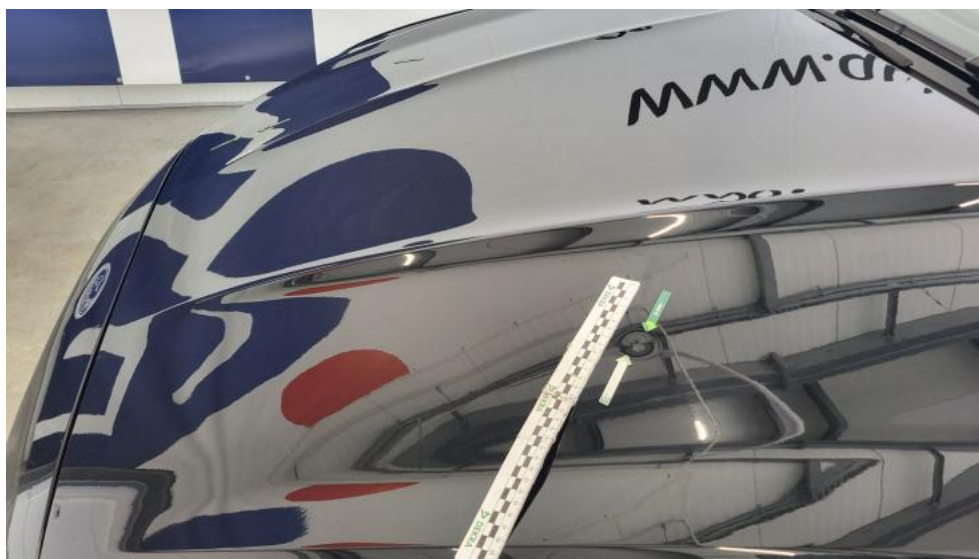
Fot. 41. Pokrywa komory silnika - Wgniecenie/odkształcenie 1
