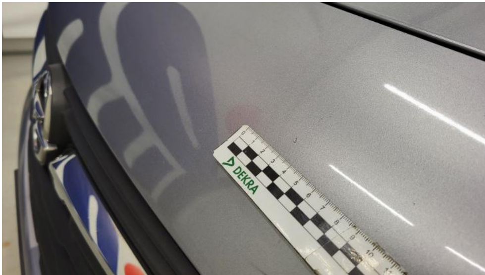
Fot. 35. Zderzak - Rysa/odprysk 1
