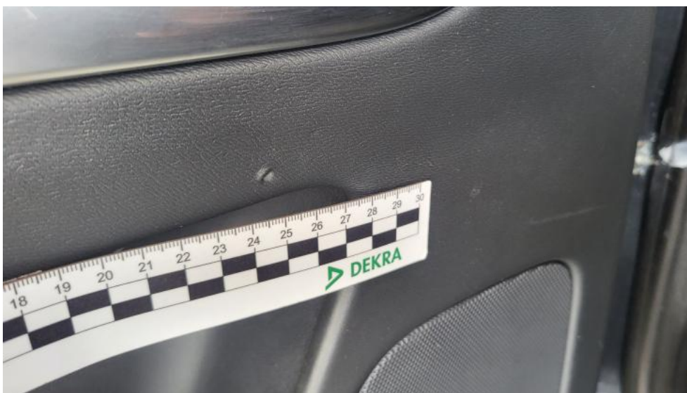
Photo 69. Tapicerka drzwi tylnych L - Wgniecenie/odkształcenie 1
