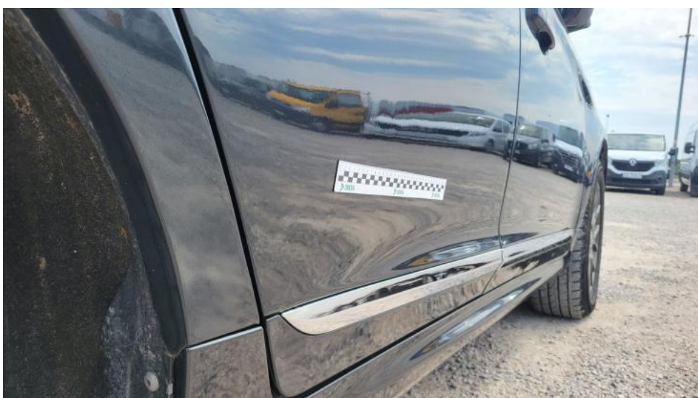
Photo 48. Drzwi tylne P - Wgniecenie/odkształcenie 2
