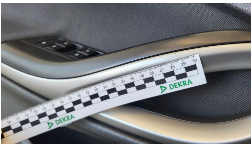
Fot. 72. Uchwyt drzwi prze L - Rysa/odprysk 1
