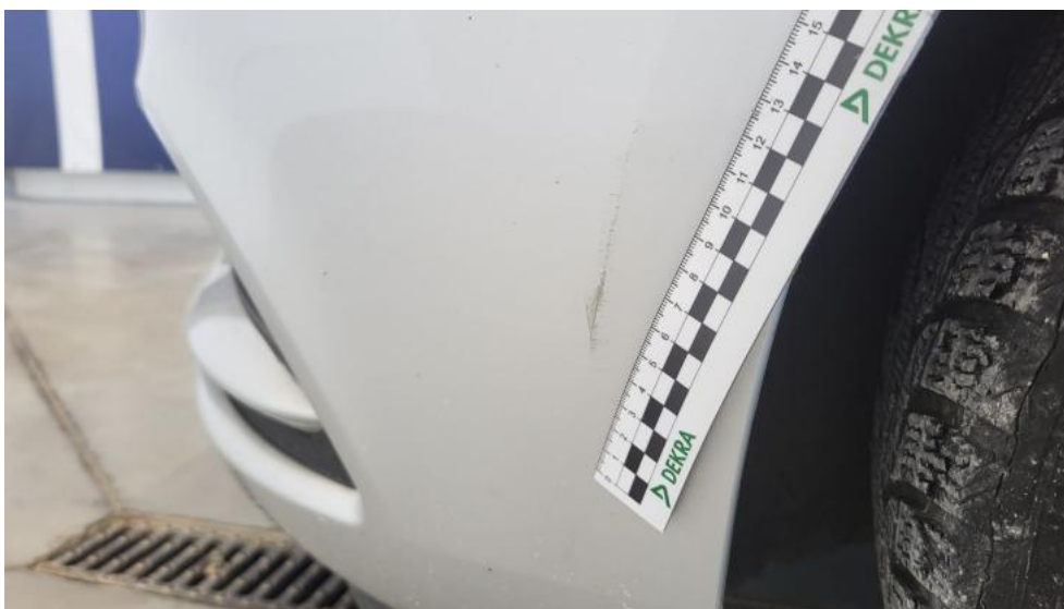
Fot. 41. Zderzak - Rysa/odprysk 1
