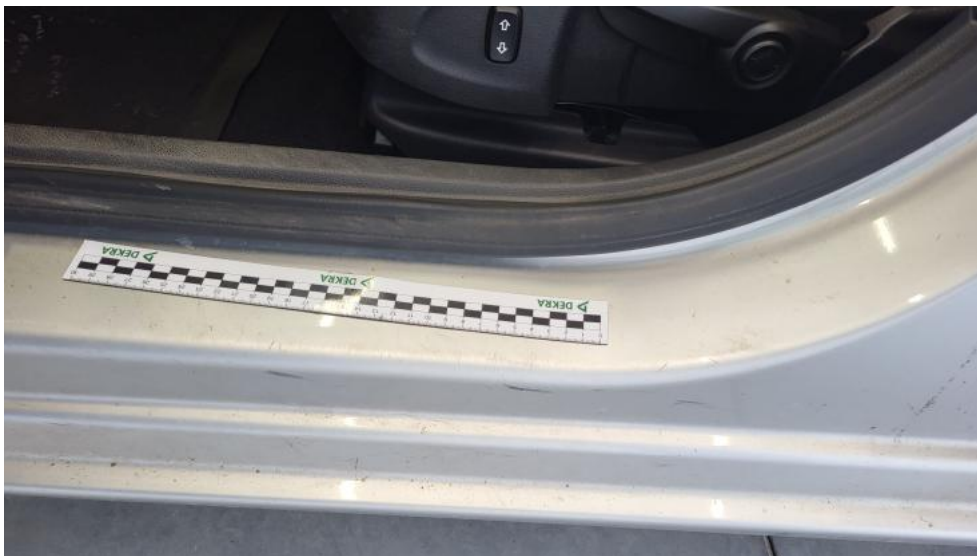
Fot. 65. Próg L - Rysa/odprysk 1
