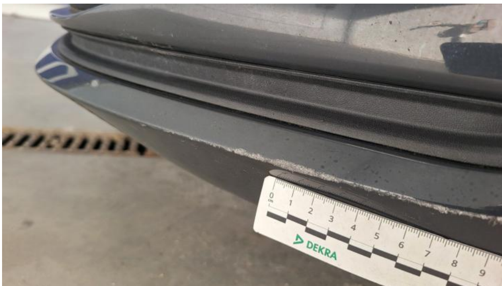
Fot. 45. Zderzak - Rysa/odprysk 2
