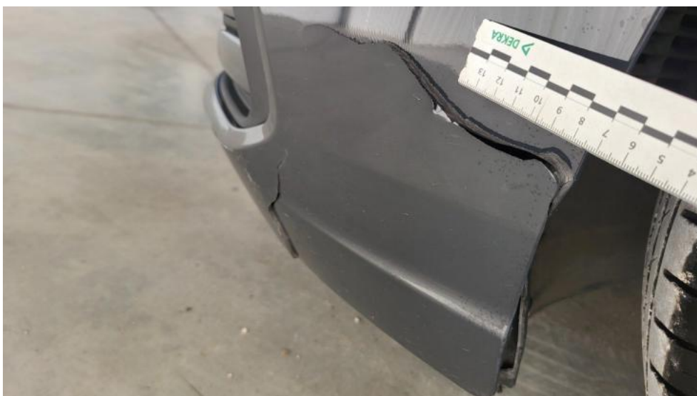
Fot. 46. Zderzak - Pęknięcie/rozerwanie 1
