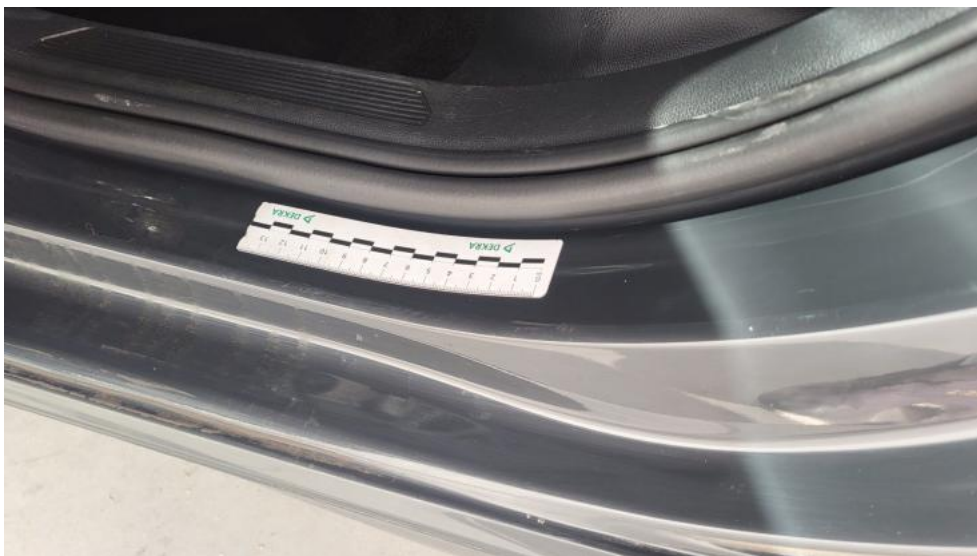
Fot. 73. Próg L - Rysa/odprysk 1
