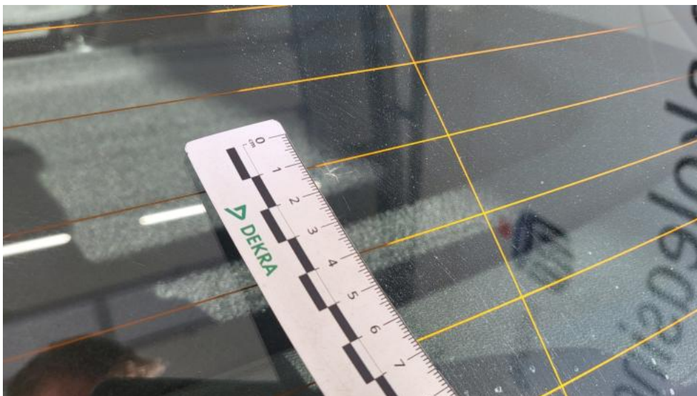
Fot. 59. Szyba tylna - Rysa/odprysk 1
