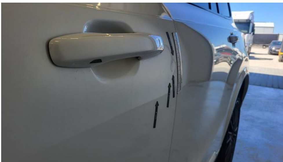
Photo 59. Drzwi przed L - Wgniecenie/odkształcenie 1
