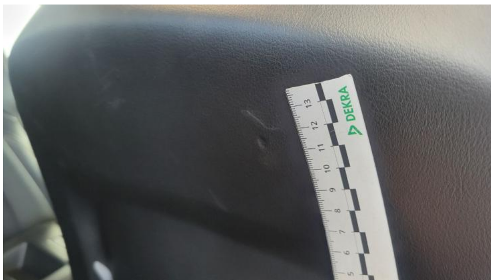
Photo 64. Fotel prz. praw. - Wgniecenie/odkształcenie 1
