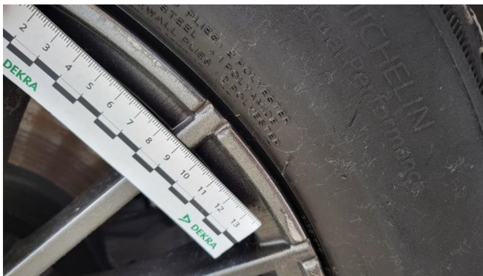
Photo 45. Felga aluminiowa przednia P - Rysa/odprysk 1
