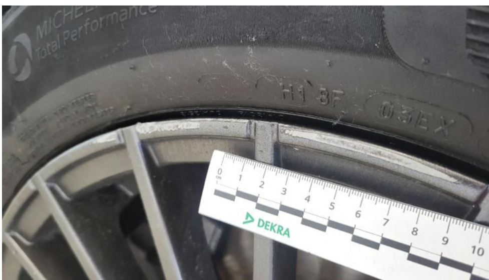
Photo 62. Felga Aluminiowa przednia L - Rysa/odprysk 1
