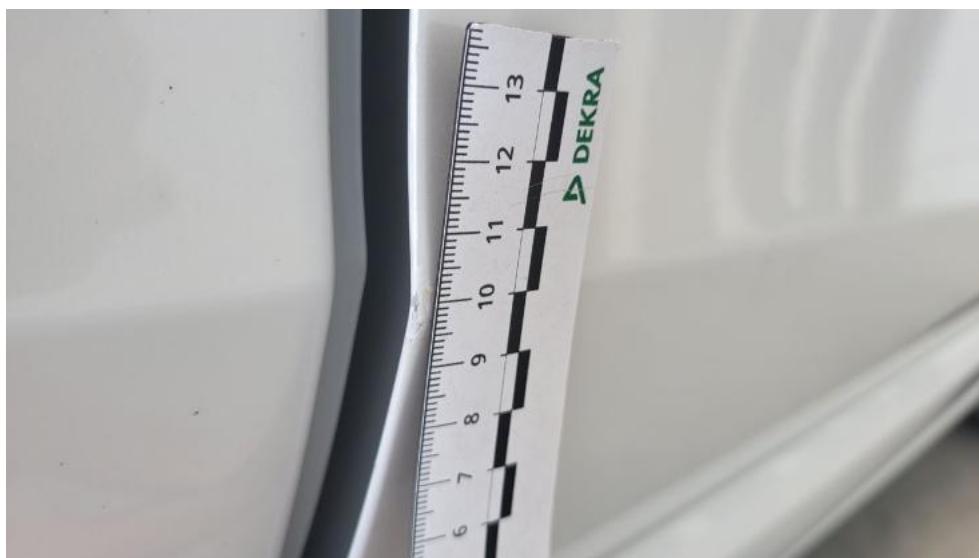
Photo 46. Drzwi przednie P - Rysa/odprysk 1
