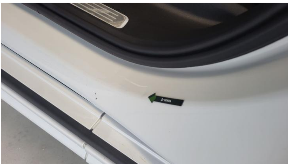
Photo 61. Próg L - Wgniecenie/odkształcenie 1
