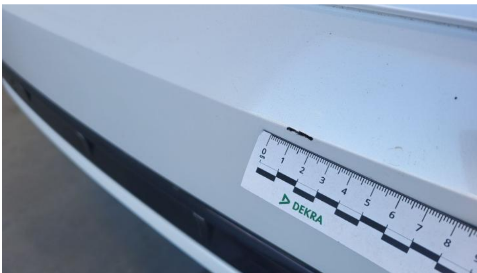
Photo 51. Zderzak tylny - Rysa/odprysk 1
