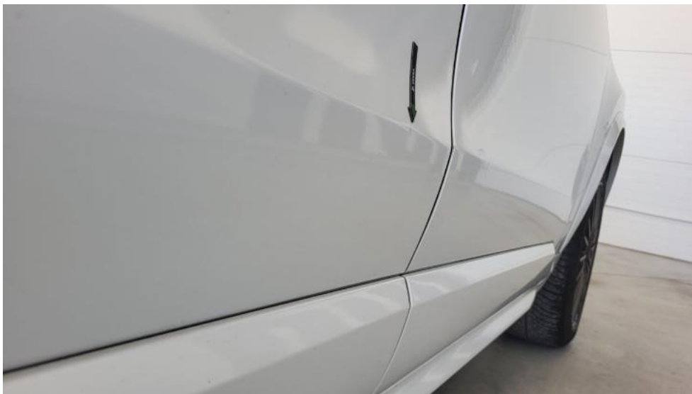
Photo 49. Drzwi tylne P - Wgniecenie/odkształcenie 1
