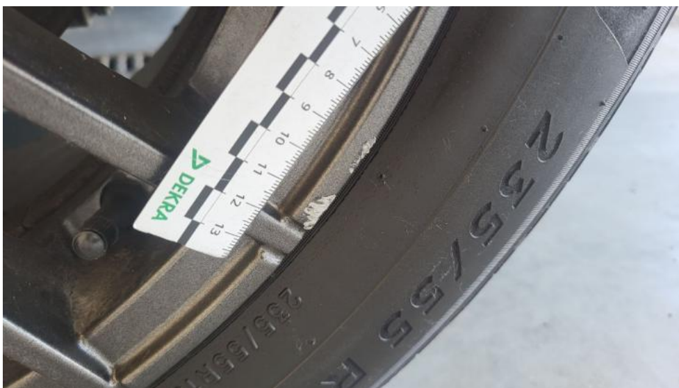
Photo 57. Felga aluminiowa tylna L - Rysa/odprysk 1
