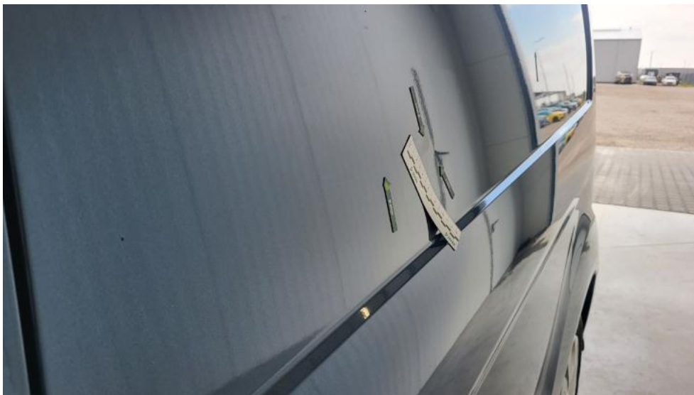
Fot. 51. Błotnik tylny L / Ściana boczna L - Wgniecenie/odkształcenie 1
