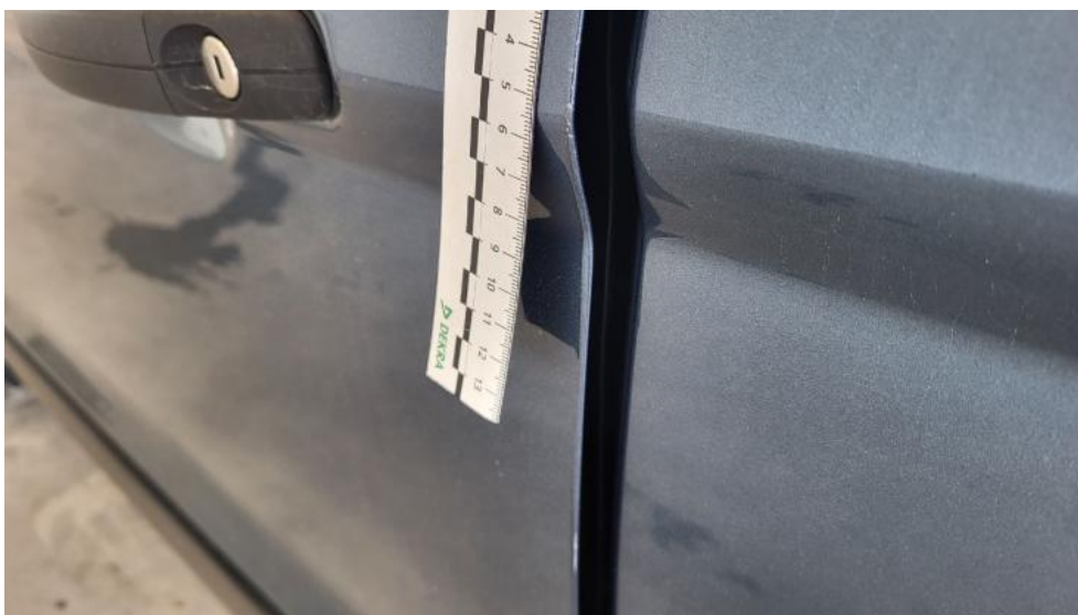
Fot. 52. Drzwi przed L - Rysa/odprysk 1
