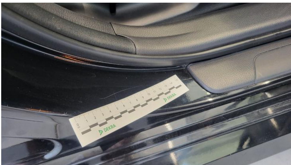
Photo 48. Próg P - Rysa/odprysk 1
