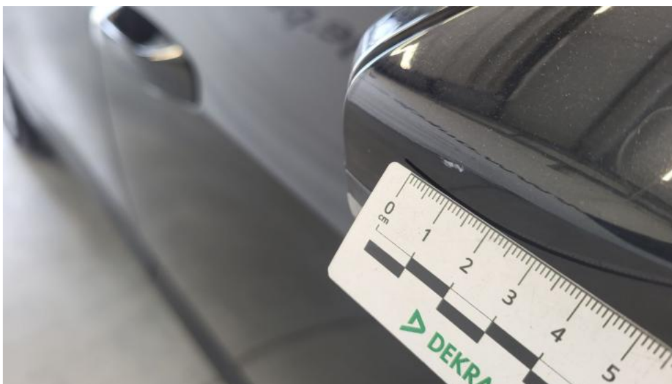
Photo 46. Lusterko zew P - Rysa/odprysk 1
