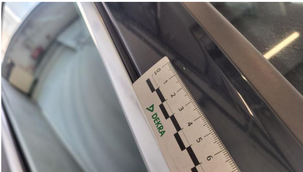
Photo 47. Stupek przedni P - Rysa/odprysk 1
