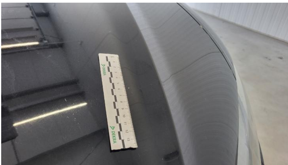
Photo 39. Pokrywa komory silnika - Rysa/odprysk 1
