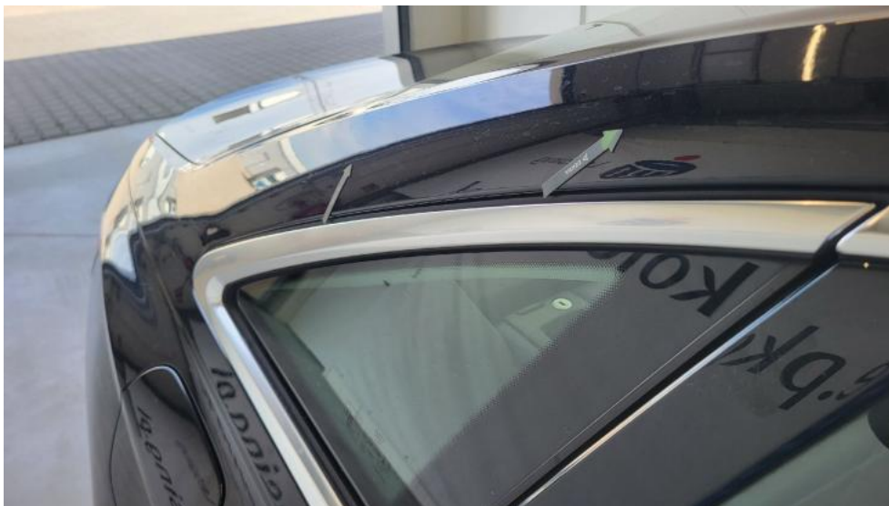
Photo 49. Błotnik tylny P / Ściana boczna P - Wgniecenie/odkształcenie 1
