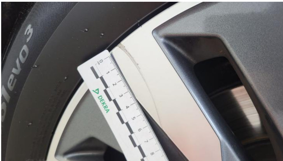
Photo 59. Felga Aluminiowa przednia L - Rysa/odprysk 1
