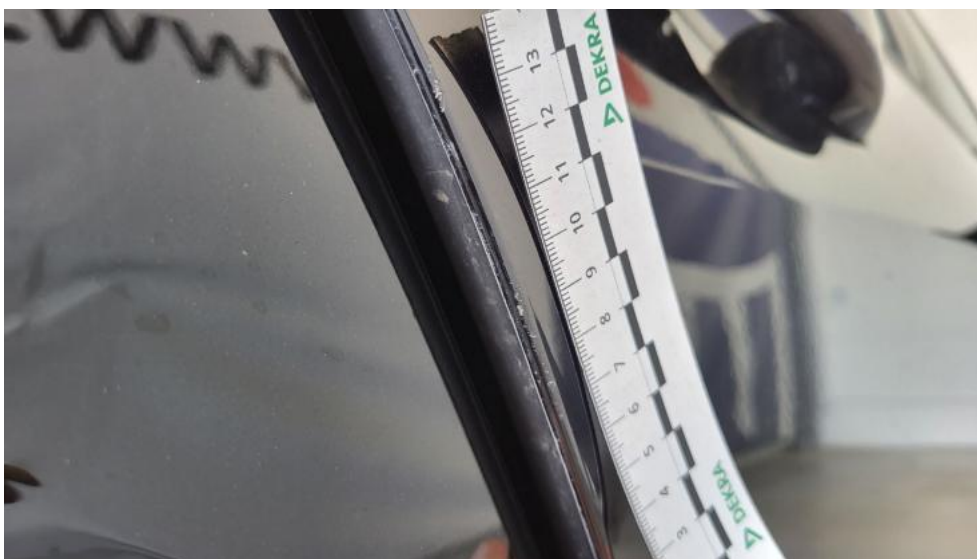
Photo 45. Drzwi tylne P - Rysa/odprysk 1
