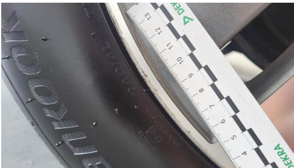
Photo 50. Felga aluminiowa tylna P - Rysa/odprysk 1
