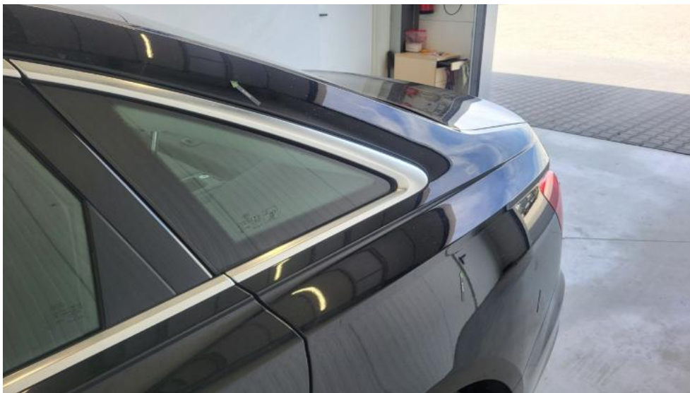
Photo 55. Błotnik tylny L / Ściana boczna L - Wgniecenie/odkształcenie 1
