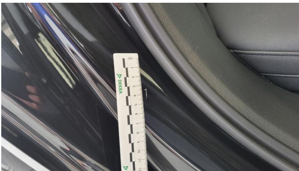
Photo 48. Błotnik tylny P / Ściana boczna P - Rysa/odprysk 1
