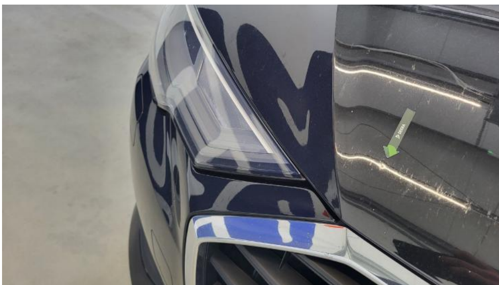
Photo 40. Pokrywa komory silnika - Wgniecenie/odkształcenie 1
