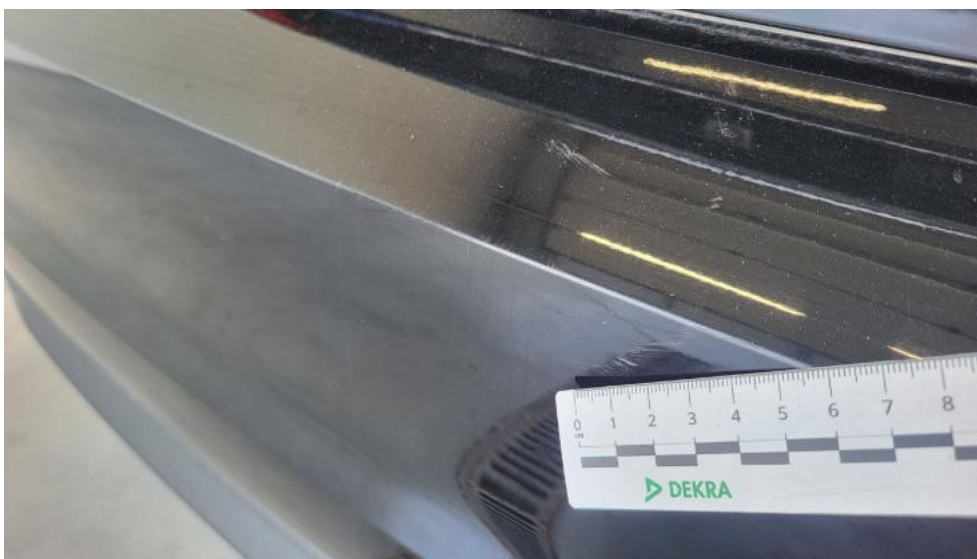
Photo 51. Zderzak tylny - Rysa/odprysk 1
