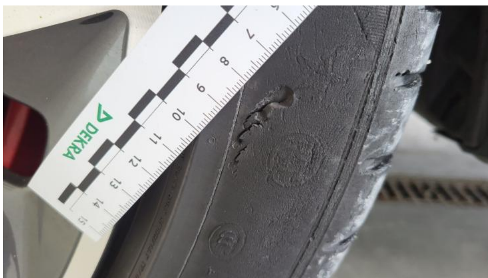
Fot. 60. Opona przednia L - Pęknięcie/rozerwanie 1
