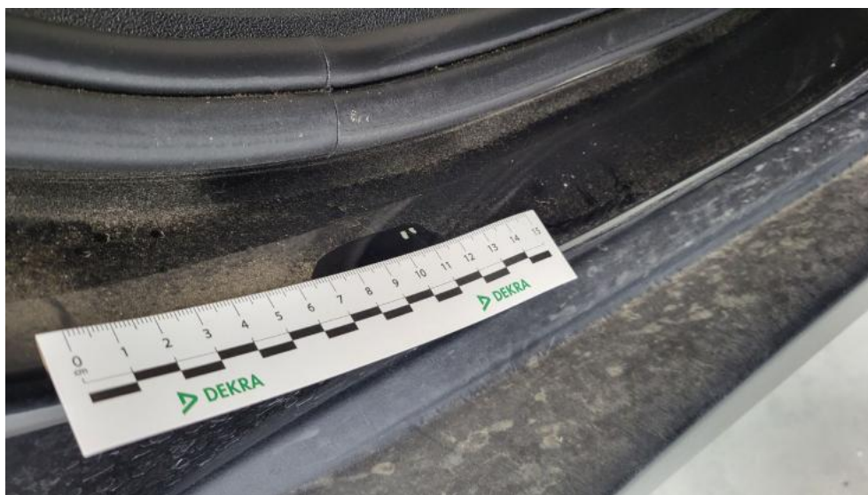
Fot. 47. Próg P - Rysa/odprysk 1
