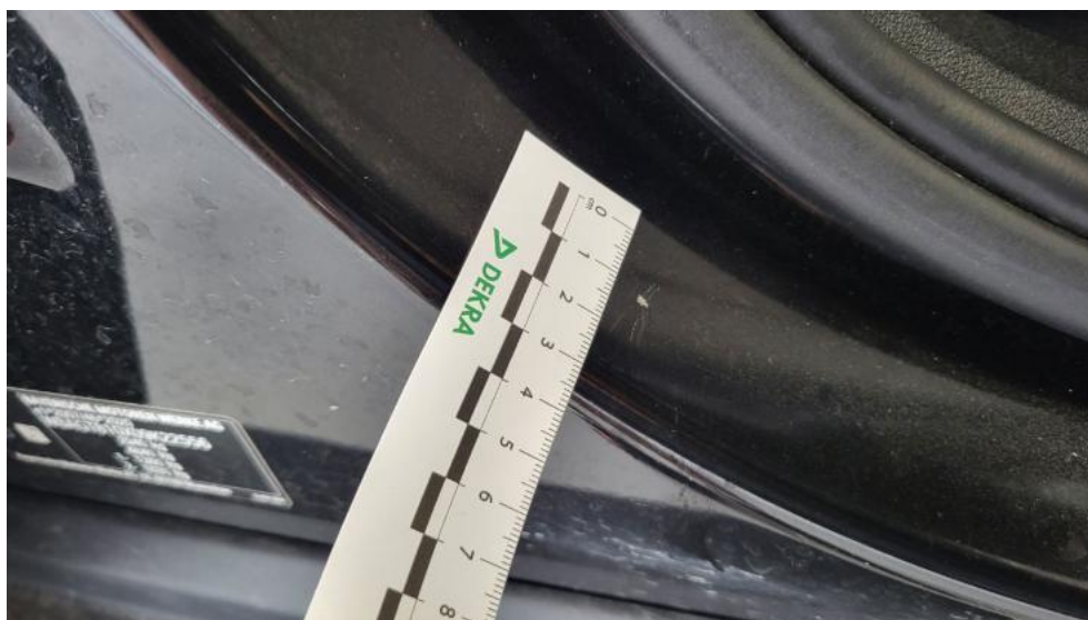
Fot. 48. Słupek środkowy P - Rysa/odprysk 1
