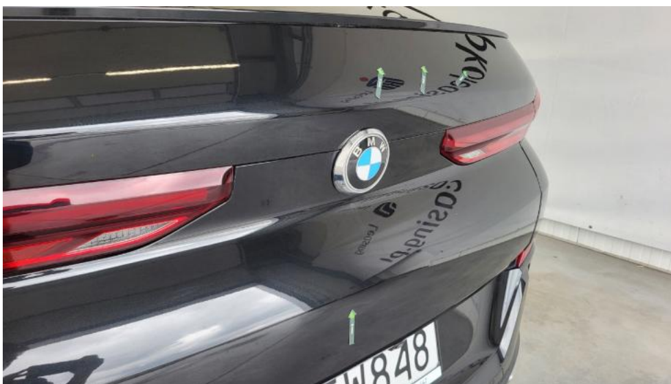
Fot. 53. Pokrywy bagażnika - Wgniecenie/odkształcenie 1
