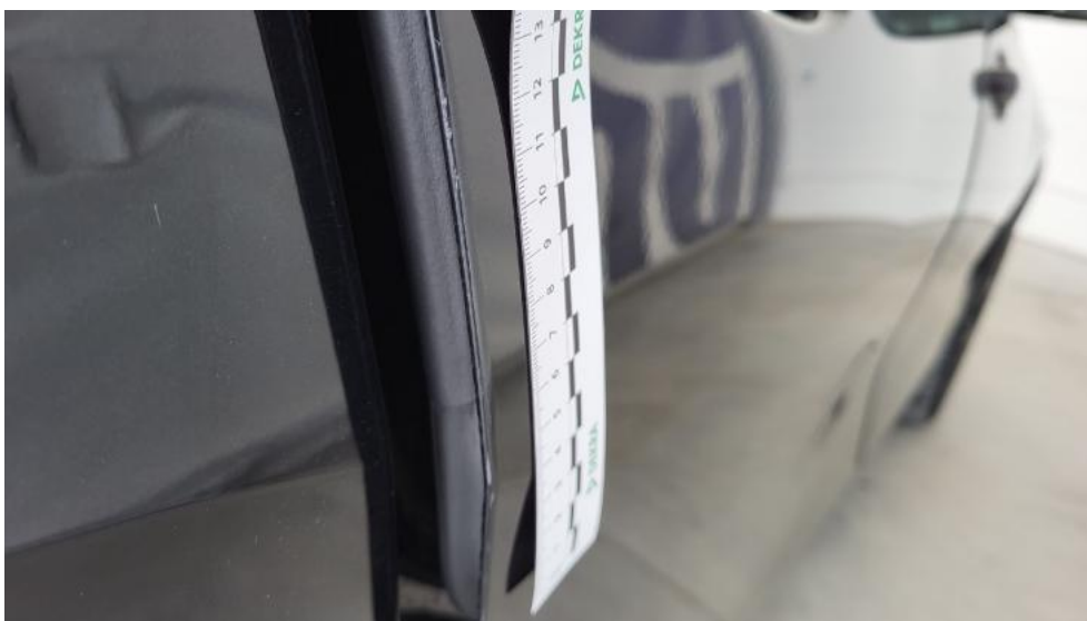
Fot. 46. Drzwi tylne P - Rysa/odprysk 1
