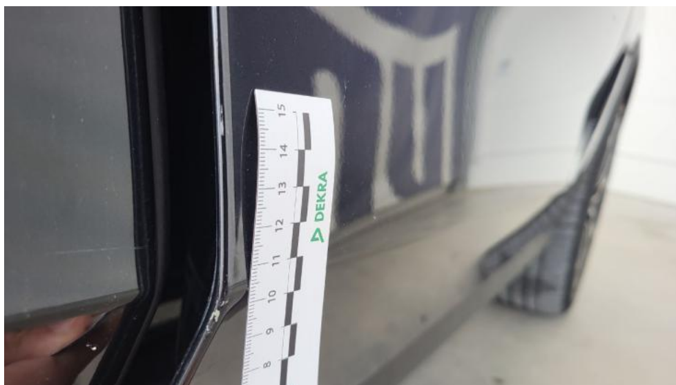
Fot. 44. Drzwi przednie P - Rysa/odprysk 1
