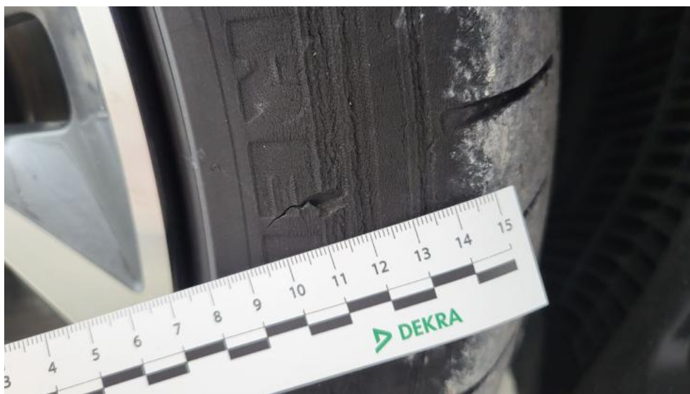
Fot. 43. Opona przednia P - Pęknięcie/rozerwanie 1
