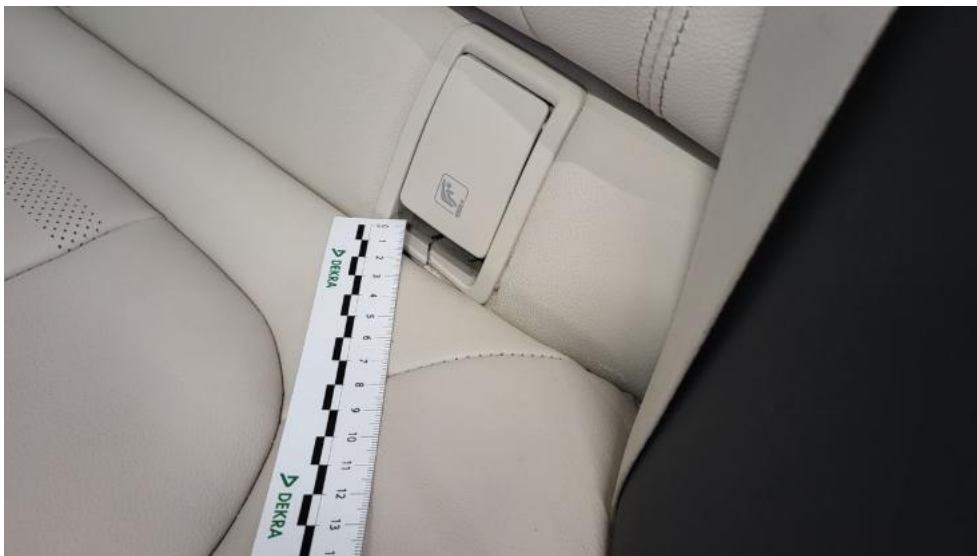
Fot. 63. Kanapa tyl. - Pęknięcie/rozerwanie 1
