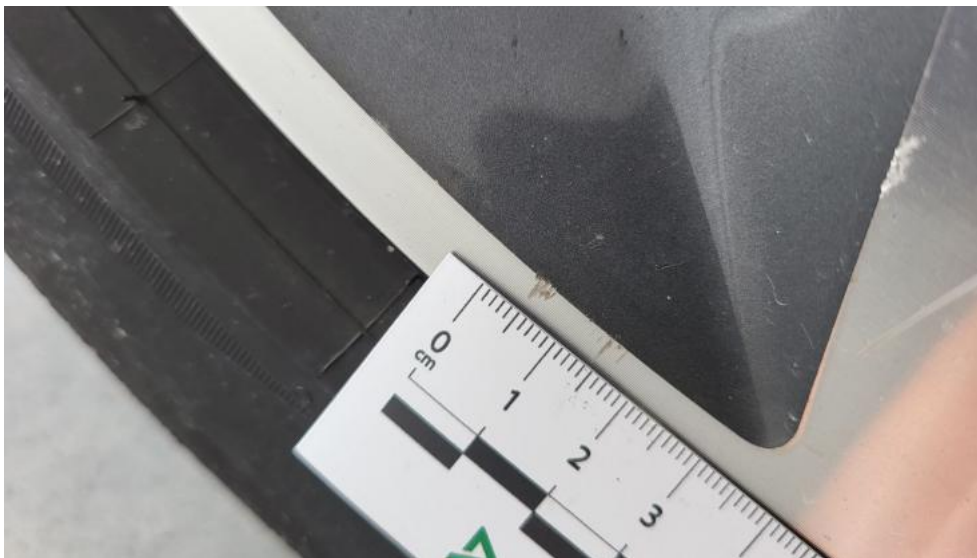
Fot. 51. Felga aluminiowa tylna P - Rysa/odprysk 1
