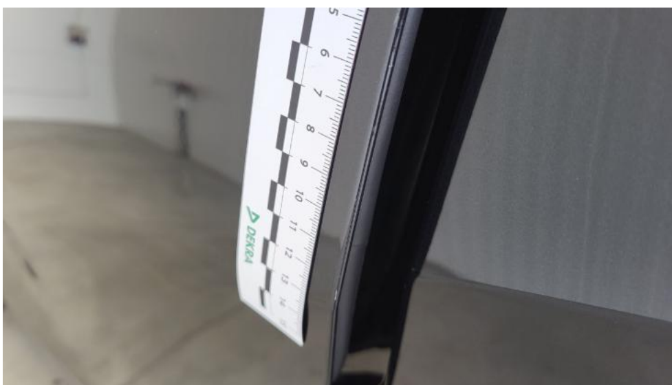
Fot. 58. Drzwi tylne L - Rysa/odprysk 1
