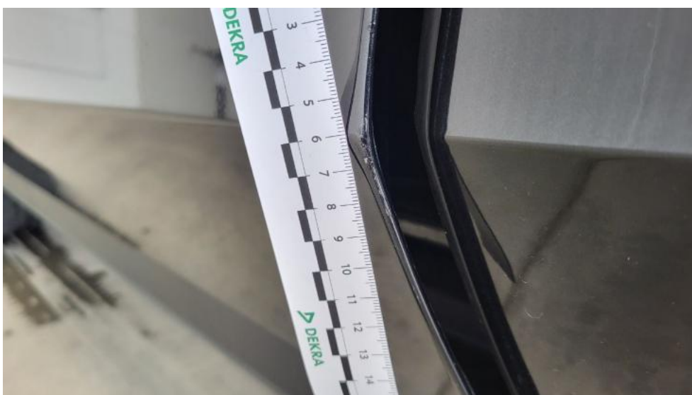
Fot. 56. Drzwi przed L - Rysa/odprysk 1
