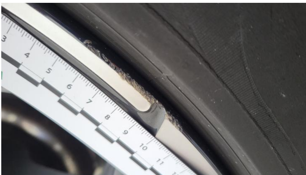
Fot. 42. Felga aluminiowa przednia P - Rysa/odprysk 1
