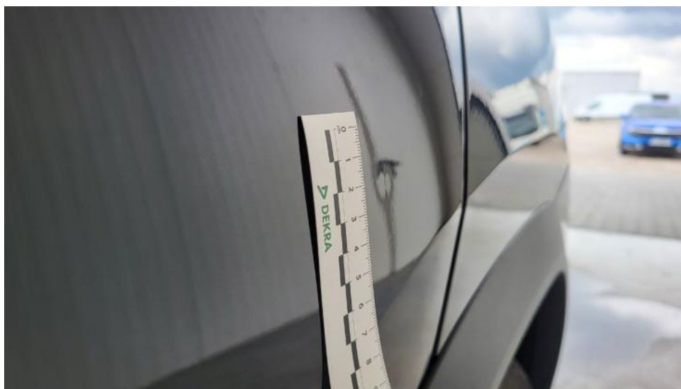
Fot. 59. Drzwi tylne L - Wgniecenie/odkształcenie 1
