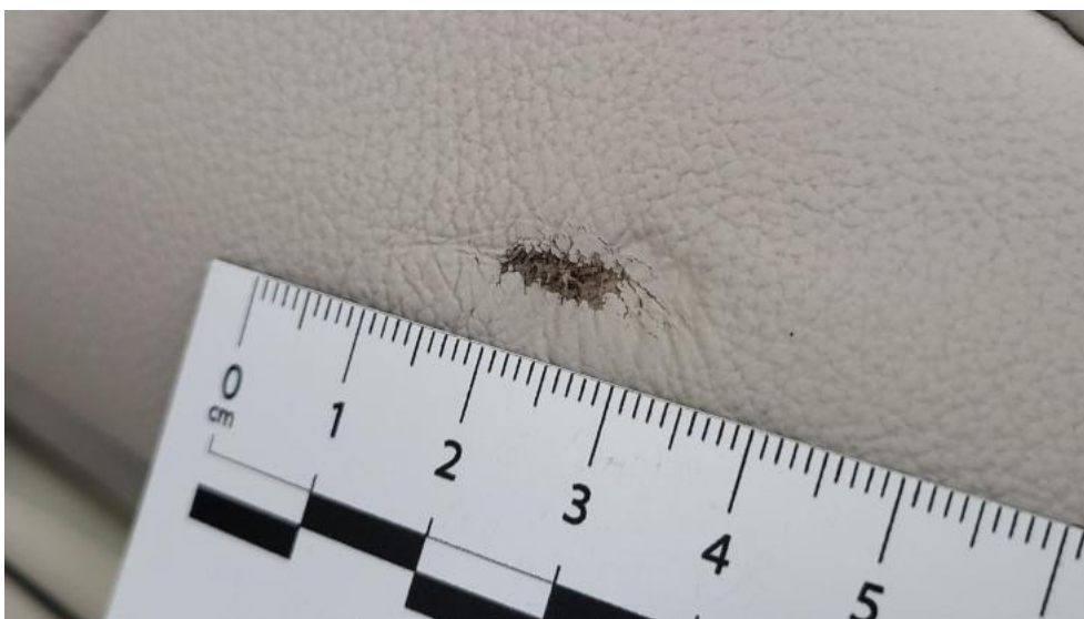
Fot. 62. Kanapa tyl. - Rysa/odprysk 1
