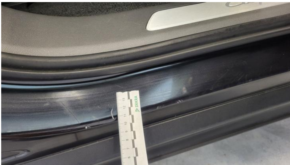
Photo 62. Próg P - Rysa/odprysk 1
