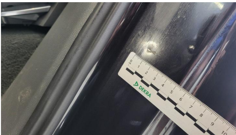
Photo 76. Błotnik tylny L / Ściana boczna L - Wgniecenie/odkształcenie 1
