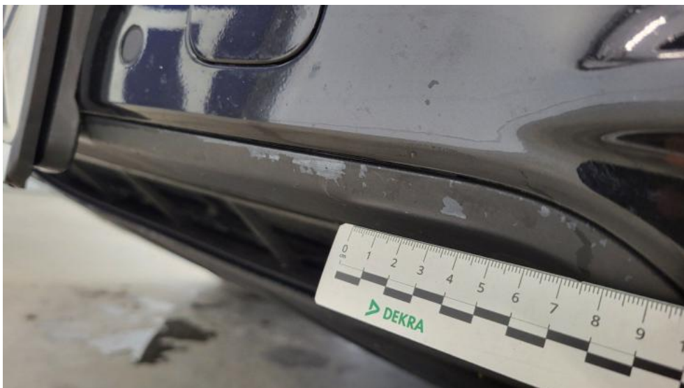
Photo 52. Zderzak przedni cz dolna - Rysa/odprysk 1
