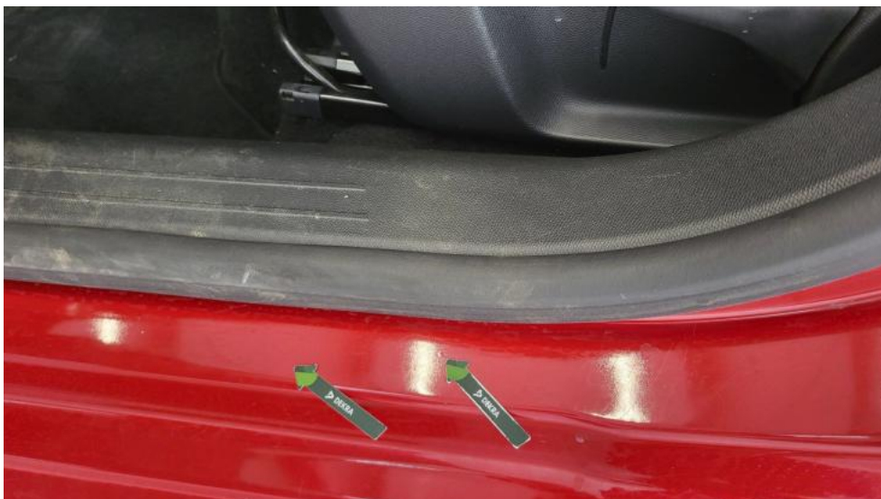
Fot. 69. Próg L - Wgniecenie/odkształcenie 1
