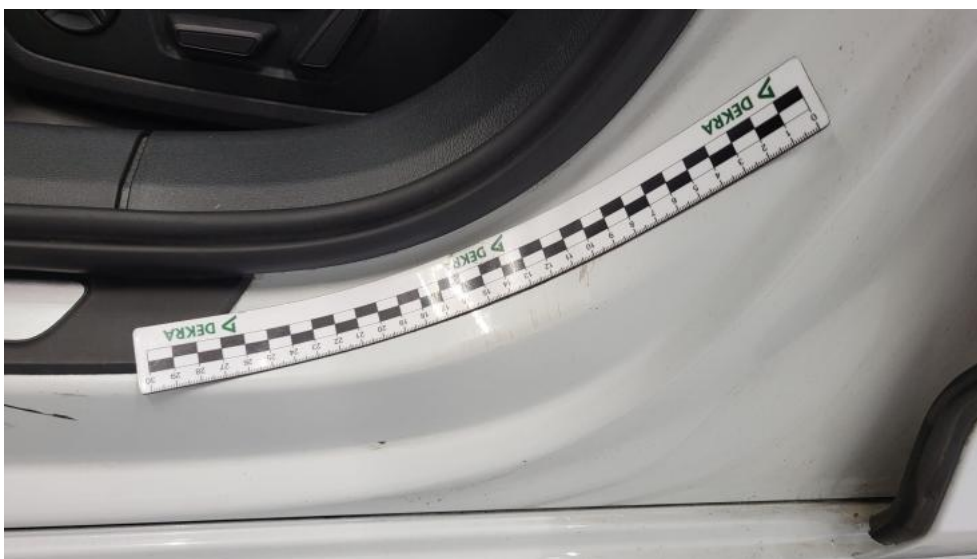
Fot. 65. Próg L - Rysa/odprysk 1
