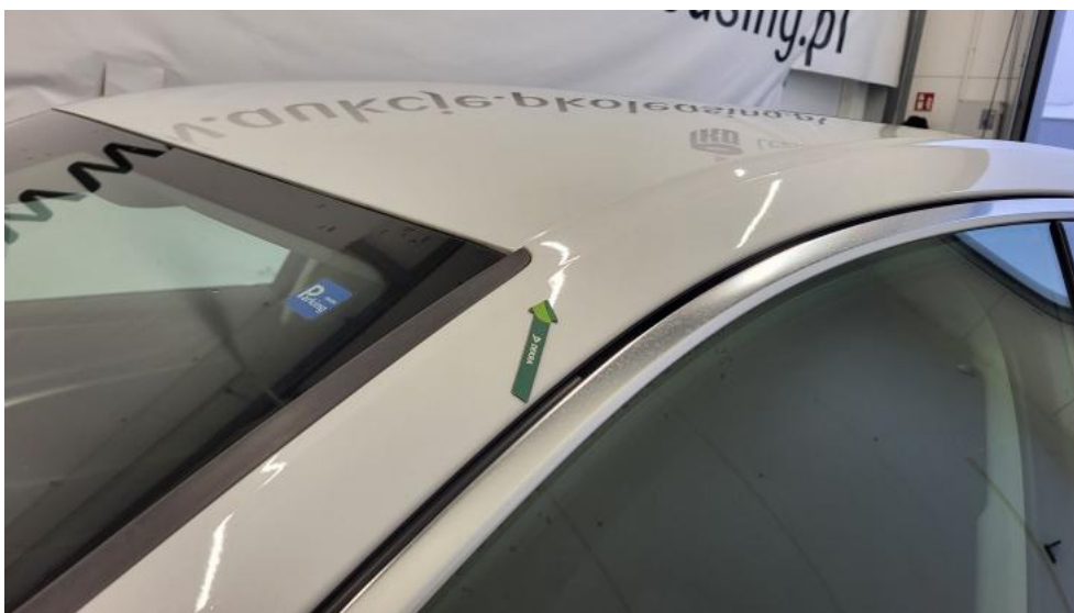
Fot. 66. Słupek przedni L - Wgniecenie/odkształcenie 1
