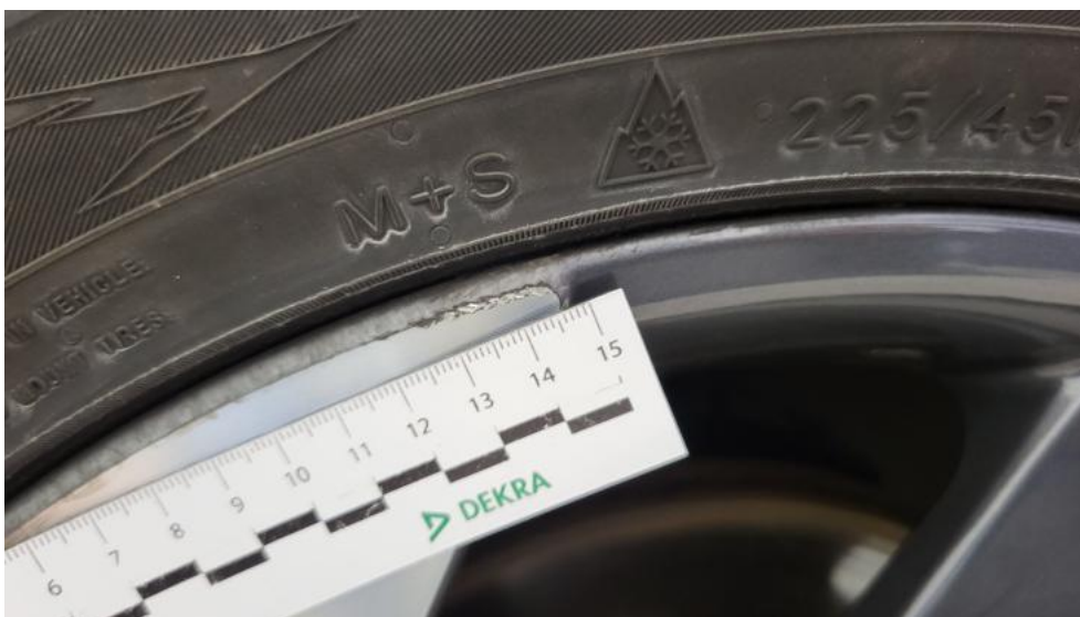
Fot. 38. Felga aluminiowa przednia P - Rysa/odprysk 1
