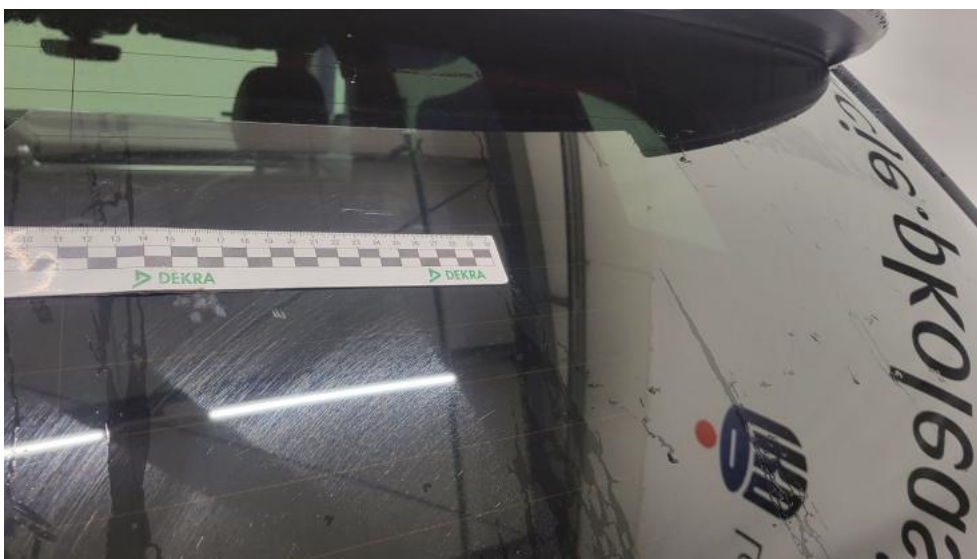
Fot. 63. Szyba tylna - Rysa/odprysk 1
