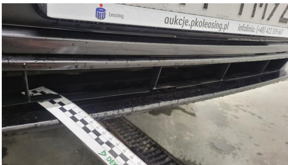
Fot. 46. Kratka zderzaka prz. - Pęknięcie/rozerwanie 1
