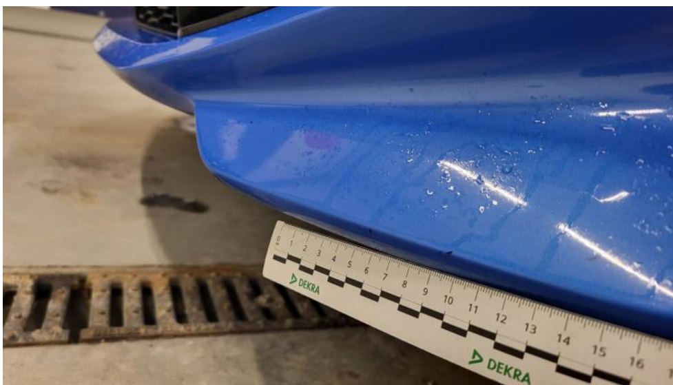
Fot. 41. Zderzak - Rysa/odprysk 1
