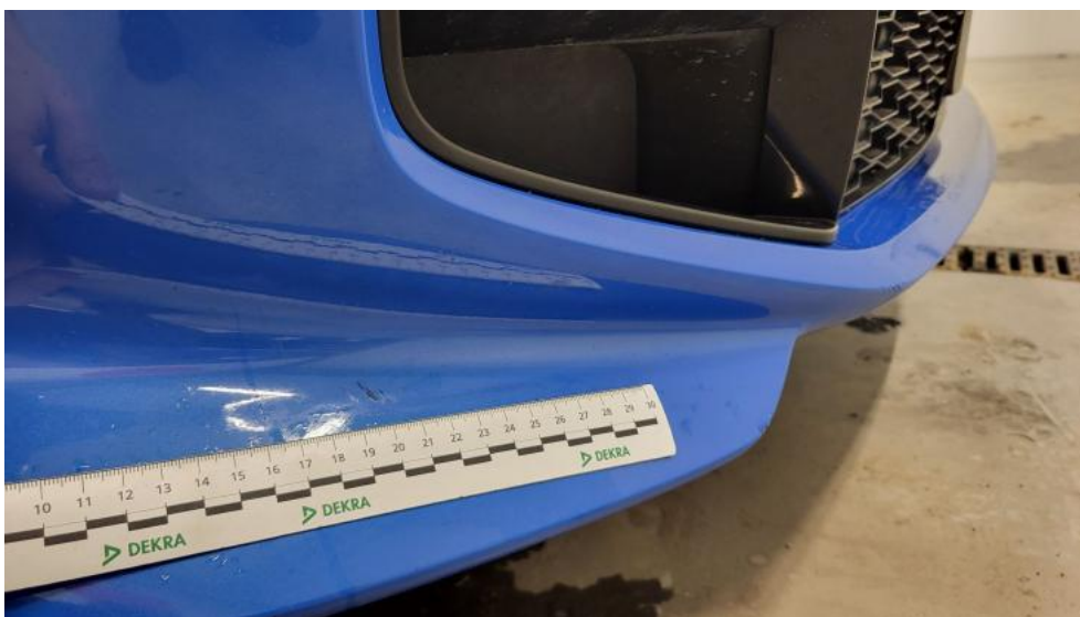
Fot. 43. Zderzak() - Rysa/odprysk 3
