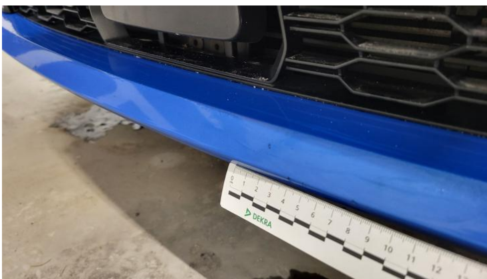
Fot. 42. Zderzak - Rysa/odprysk 2
