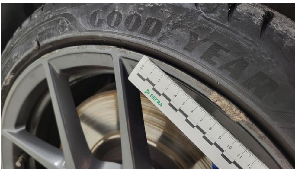
Fot. 44. Felga aluminiowa przednia P - Rysa/odprysk 1
