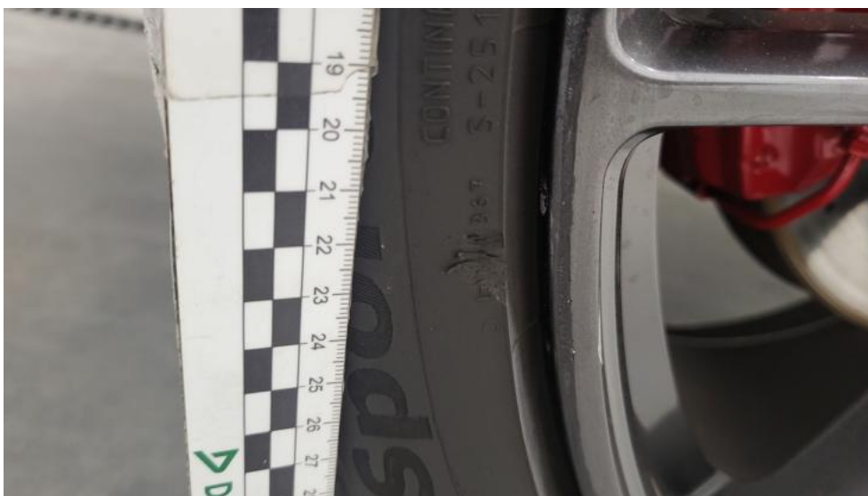
Fot. 60. Opona tylna P - Wgniecenie/odkształcenie 1
