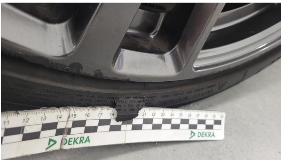
Fot. 61. Opona tylna P - Pęknięcie/rozerwanie 1
