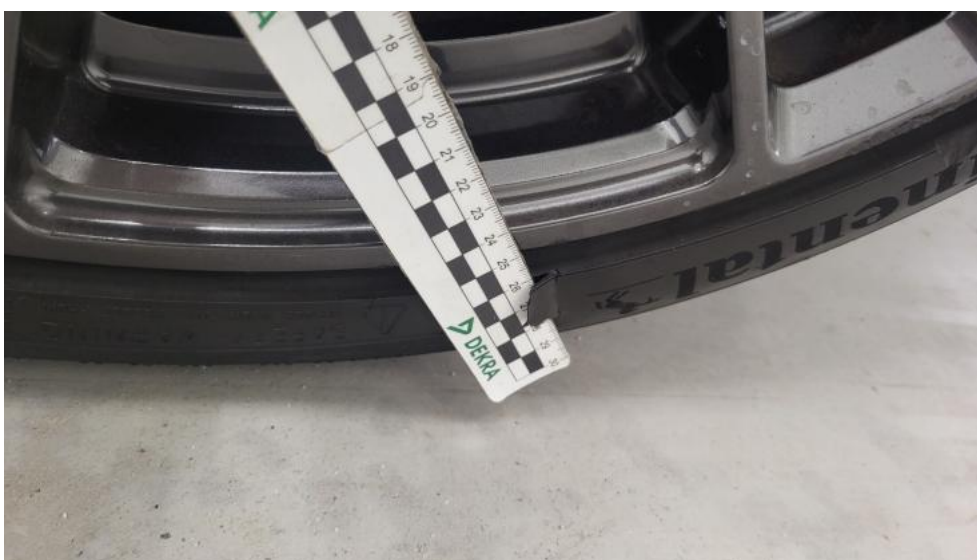
Fot. 72. Opona tylna L - Pęknięcie/rozerwanie 1
