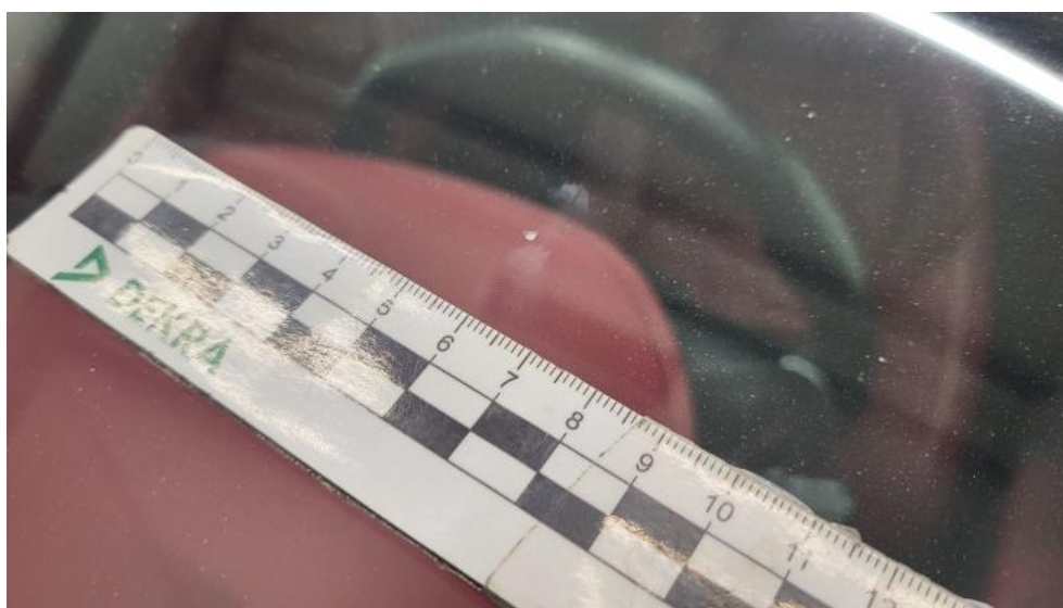
Fot. 52. Szyba czołowa - Rysa/odprysk 1
