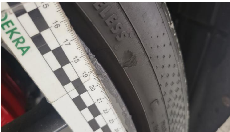
Fot. 71. Opona tylna L - Wgniecenie/odkształcenie 1
