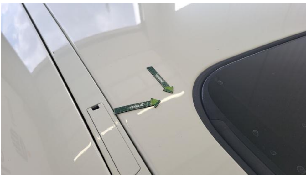
Fot. 64. Dach - Wgniecenie/odkształcenie 1
