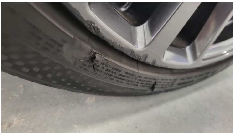
Fot. 62. Opona tylna P - Pęknięcie/rozerwanie 2
