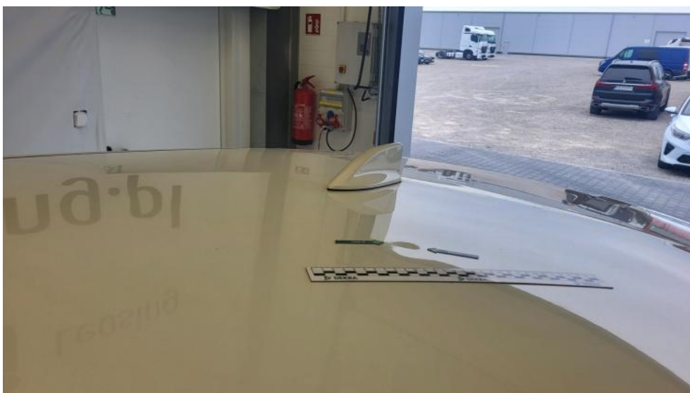
Fot. 46. Dach - Wgniecenie/odkształcenie 1
