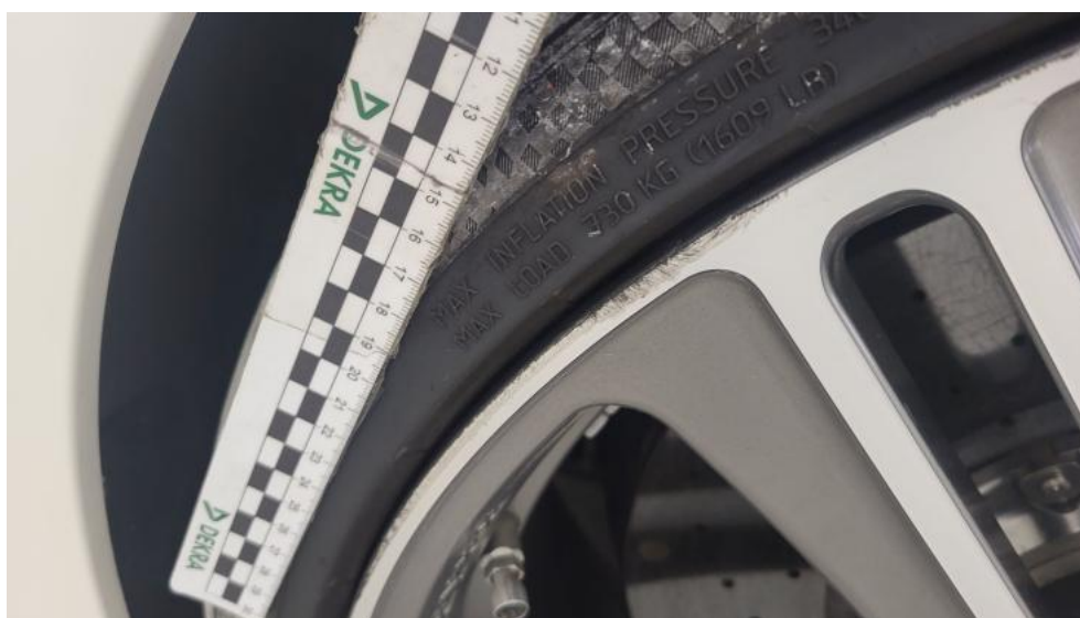
Fot. 72. Felga Aluminiowa przednia L - Rysa/odprysk 2
