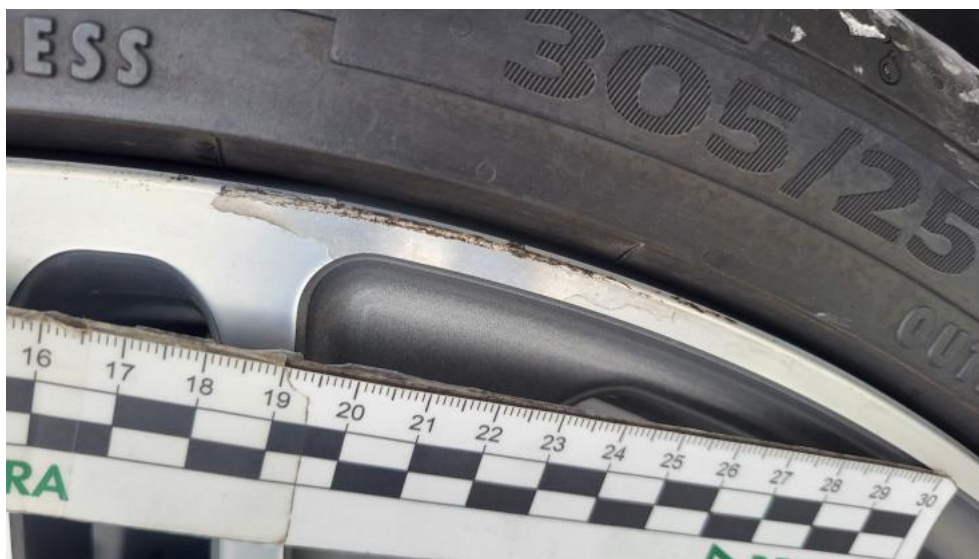
Fot. 69. Felga aluminiowa tylna P - Rysa/odprysk 1
