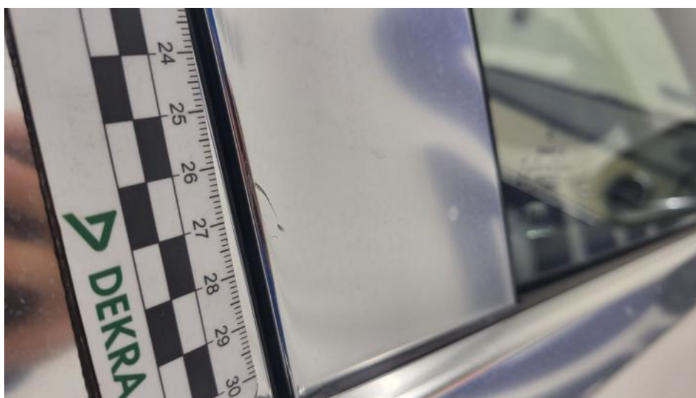
Fot. 66. Drzwi przednie P - Rysa/odprysk 1
