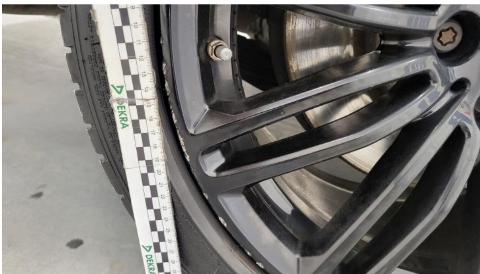
Fot. 63. Felga aluminiowa tylna P - Rysa/odprysk 2
