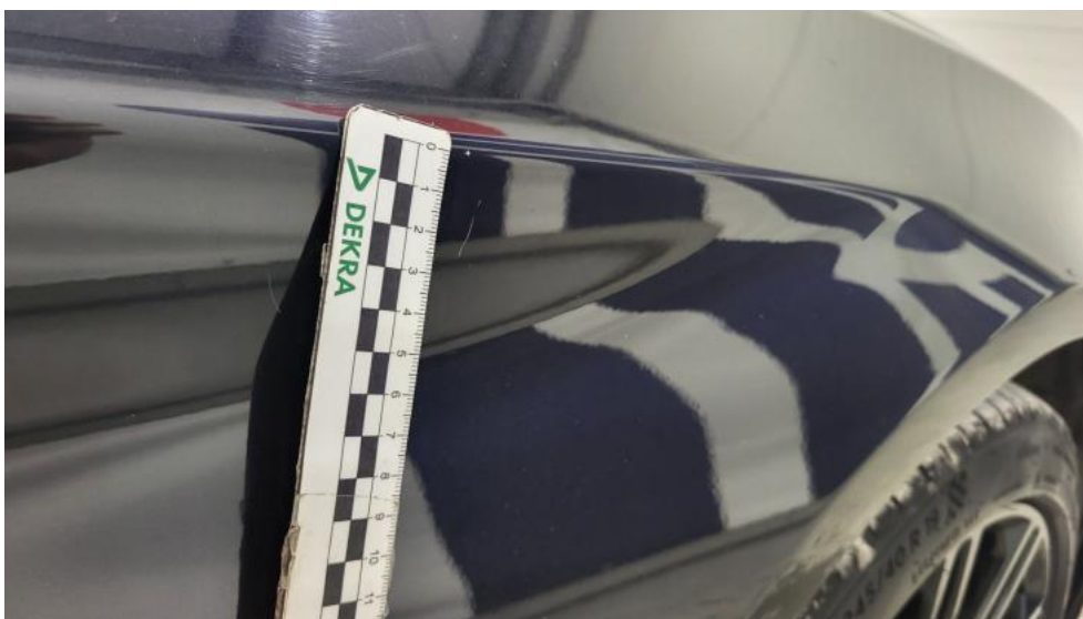
Fot. 54. Błotnik przedni P - Rysa/odprysk 1
