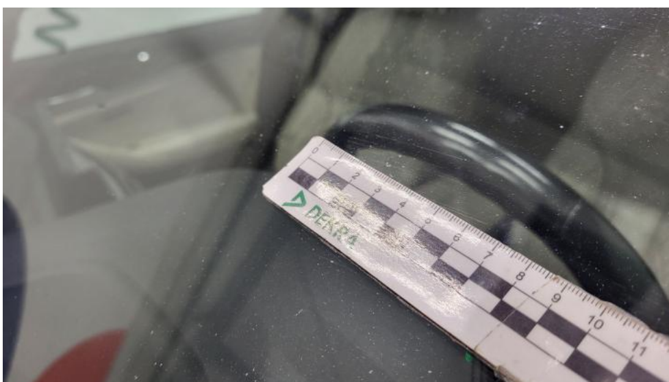
Fot. 44. Szyba czołowa - Rysa/odprysk 1
