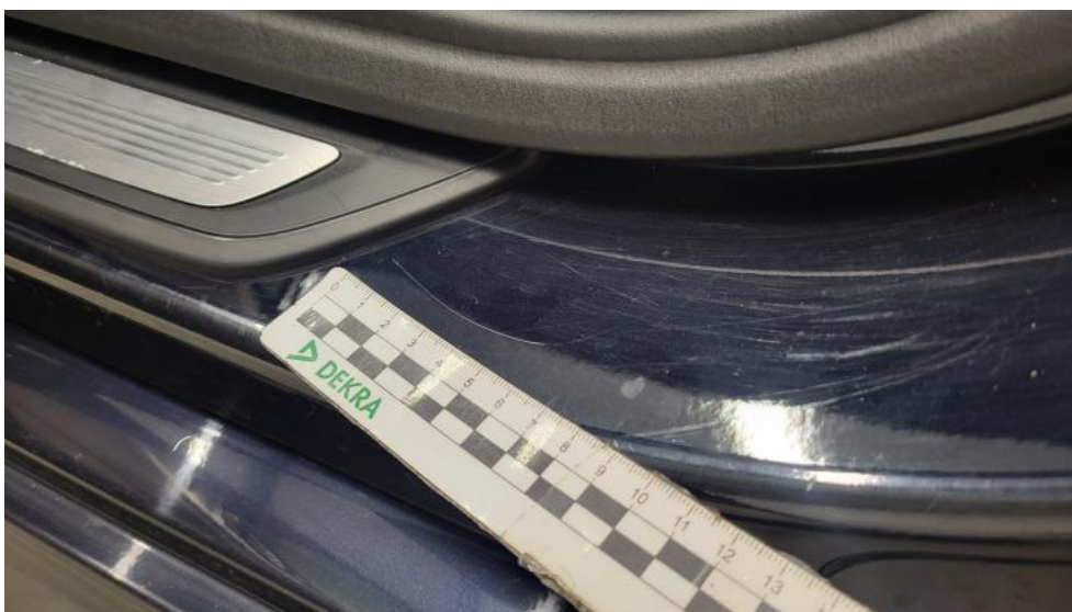
Fot. 72. Próg L - Rysa/odprysk 1
