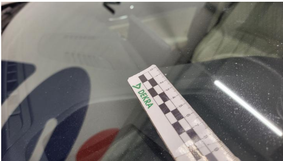
Fot. 45. Szyba czołowa - Rysa/odprysk 2
