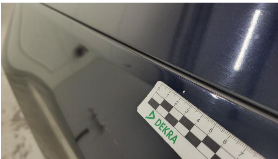
Fot. 74. Błotnik przedni L - Rysa/odprysk 1
