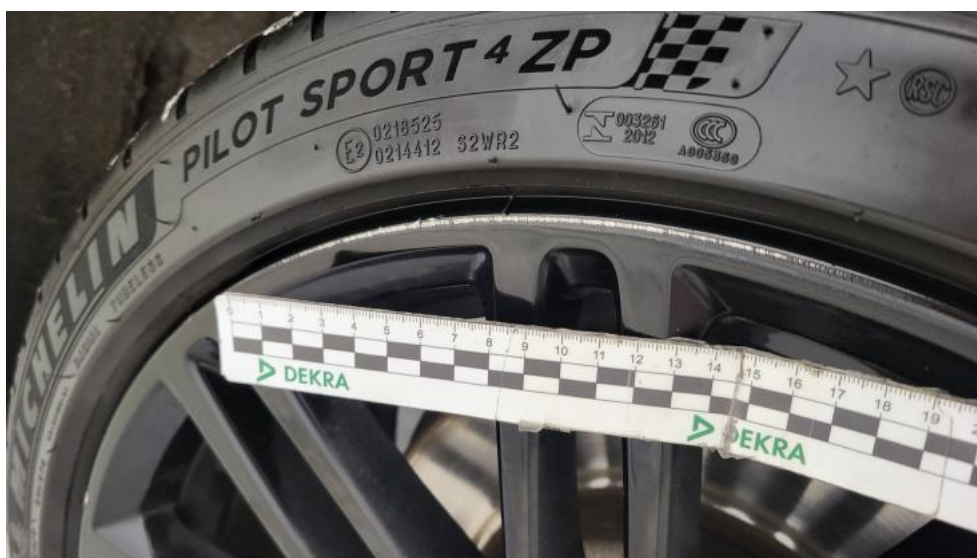
Fot. 62. Felga aluminiowa tylna P - Rysa/odprysk 1
