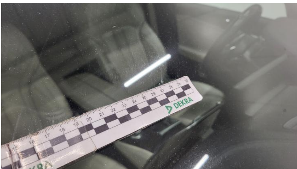
Fot. 46. Szyba czołowa() - Rysa/odprysk 3
