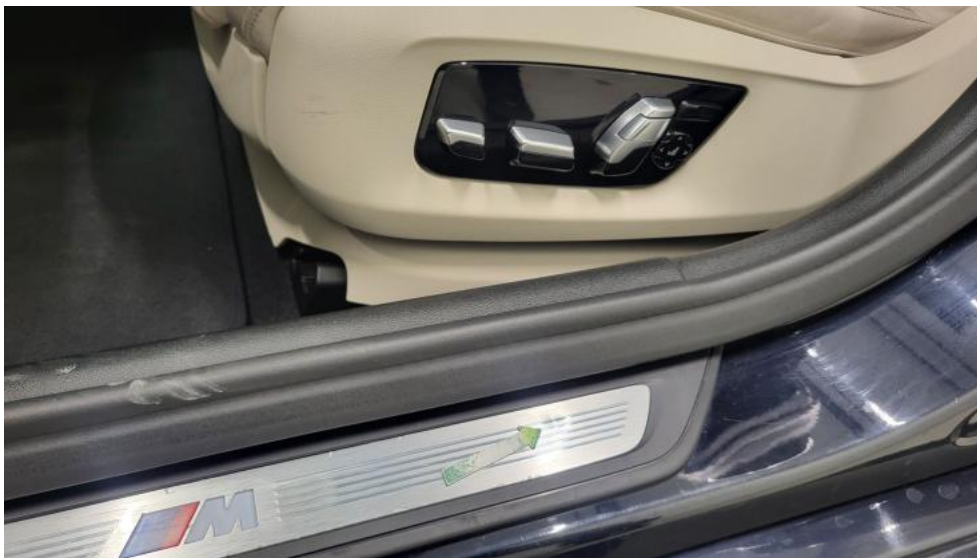
Fot. 73. Próg L - Wgniecenie/odkształcenie 1
