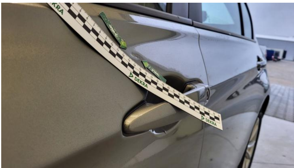
Photo 67. Drzwi przed L - Wgniecenie/odkształcenie 1
