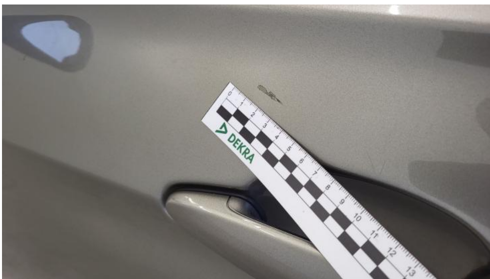
Photo 64. Drzwi przed L - Rysa/odprysk 1
