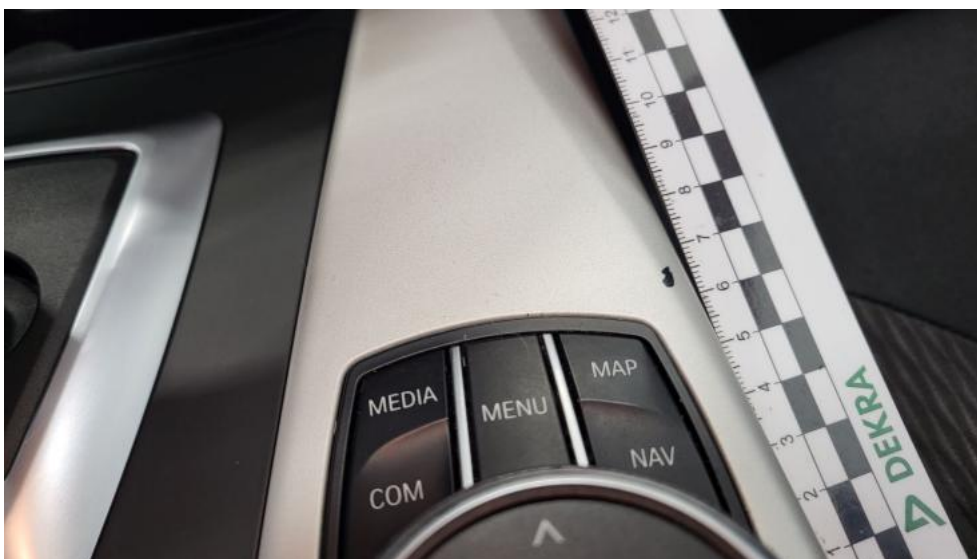
Photo 71. Konsola środkowa - Rysa/odprysk 1
