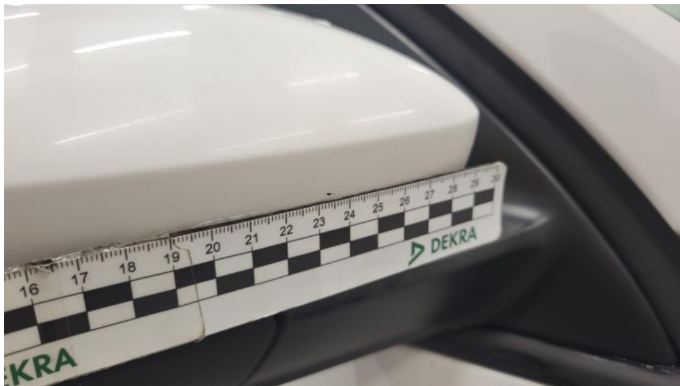
Fot. 39. Lusterko zew P - Rysa/odprysk 1
