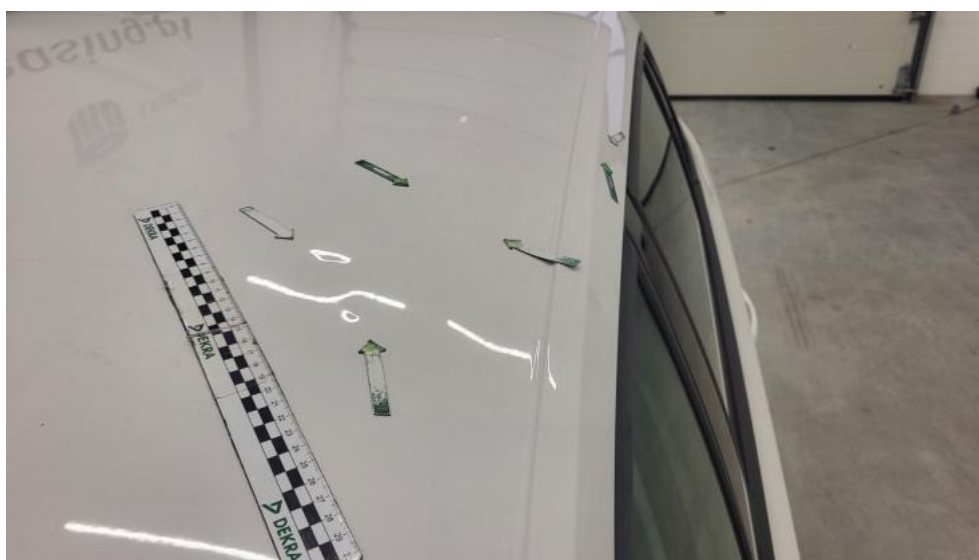
Fot. 46. Dach - Wgniecenie/odkształcenie 1
