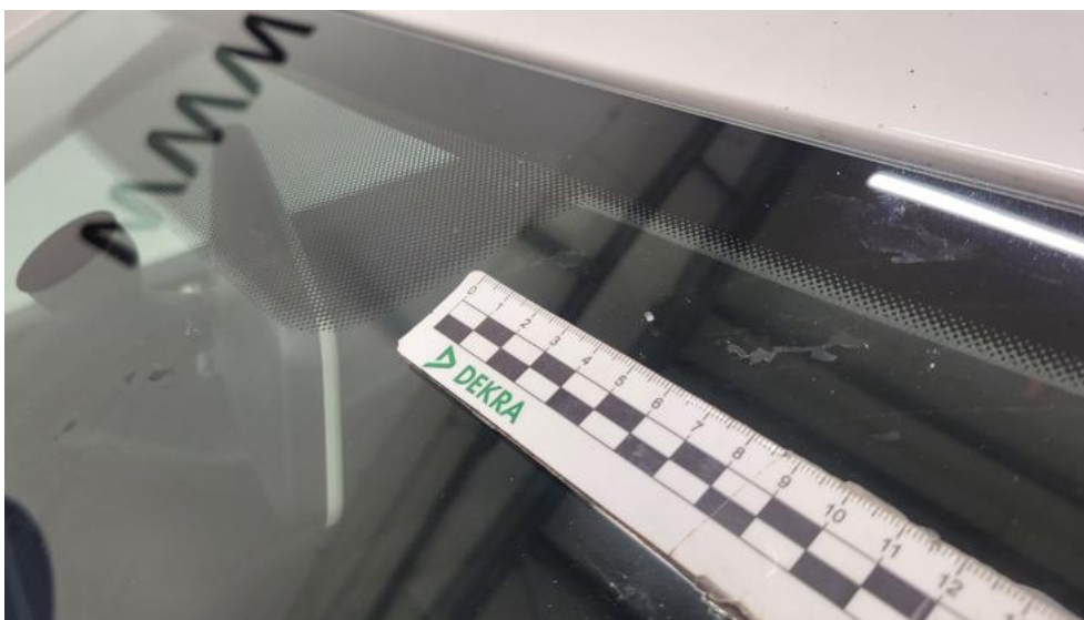
Fot. 33. Szyba czołowa - Rysa/odprysk 1
