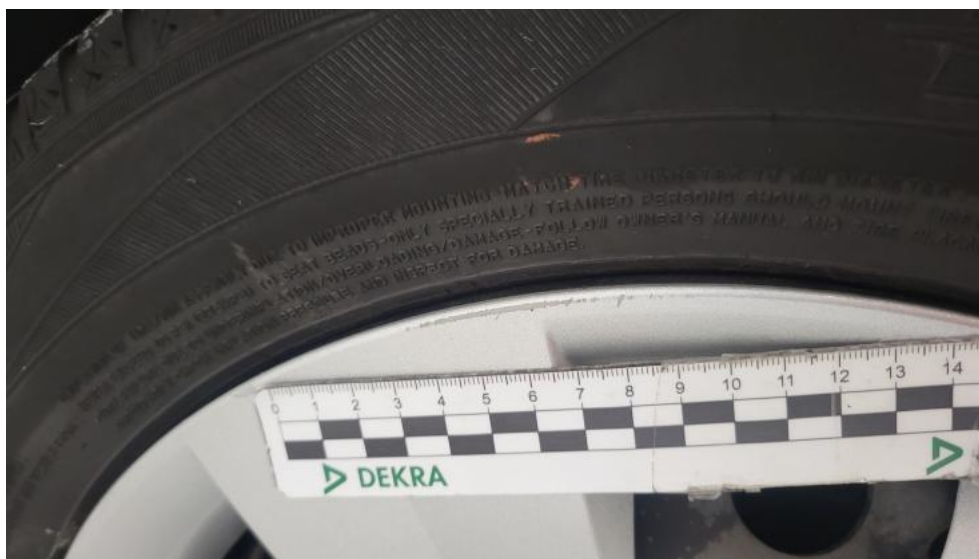
Fot. 43. Kołpak tylny P - Rysa/odprysk 1
