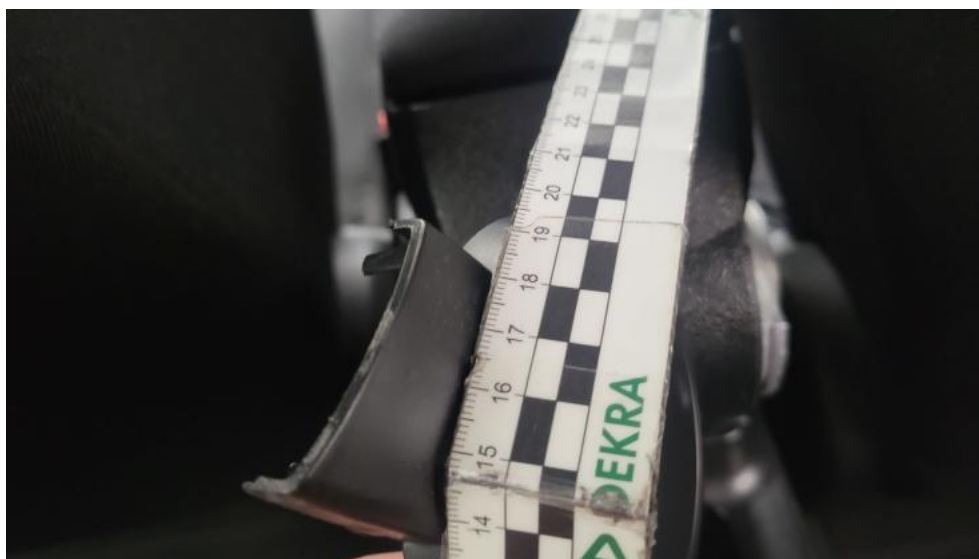
Fot. 63. Podłokietnik środkowy przedni - Pęknięcie/rozerwanie 1
