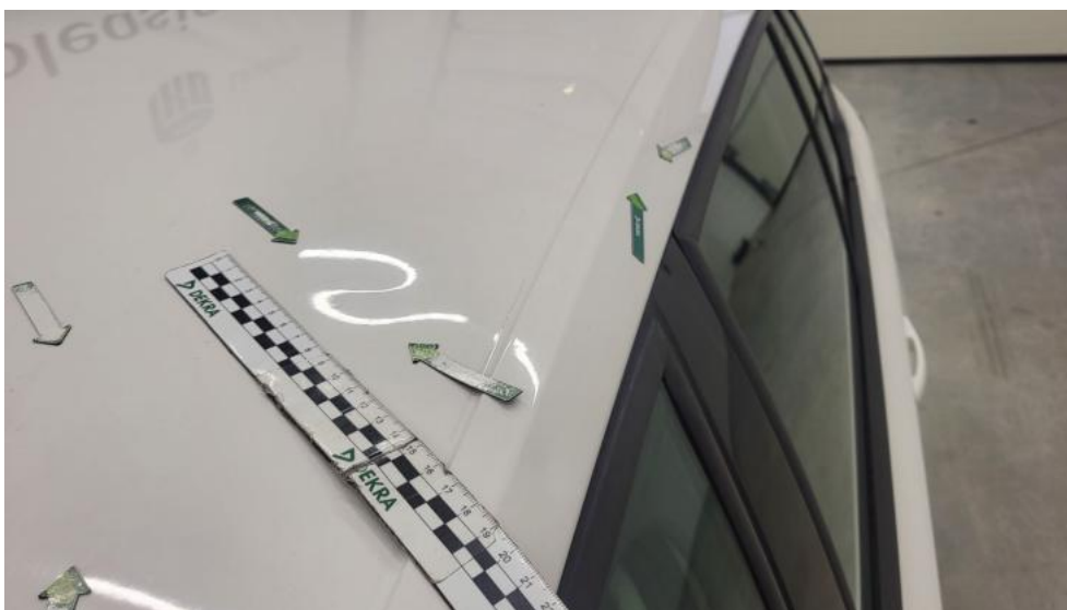
Fot. 47. Dach - Wgniecenie/odkształcenie 2
