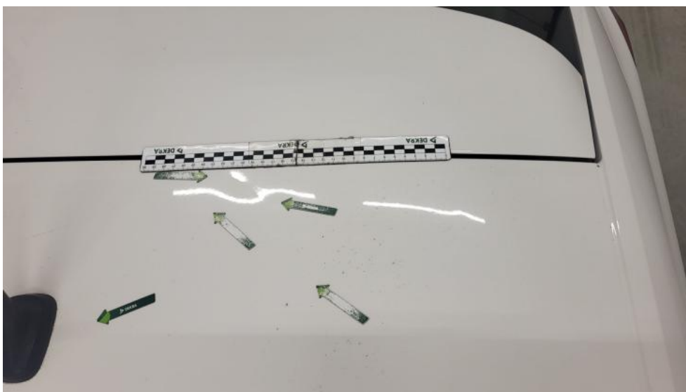
Fot. 48. Dach() - Wgniecenie/odkształcenie 3
