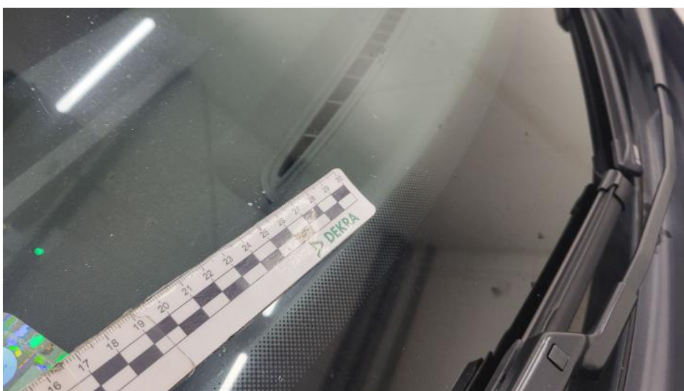
Fot. 34. Szyba czołowa - Rysa/odprysk 2
