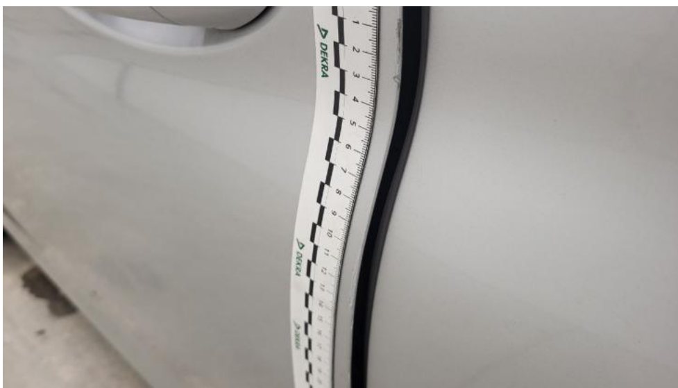
Fot. 65. Drzwi przed L - Rysa/odprysk 1
