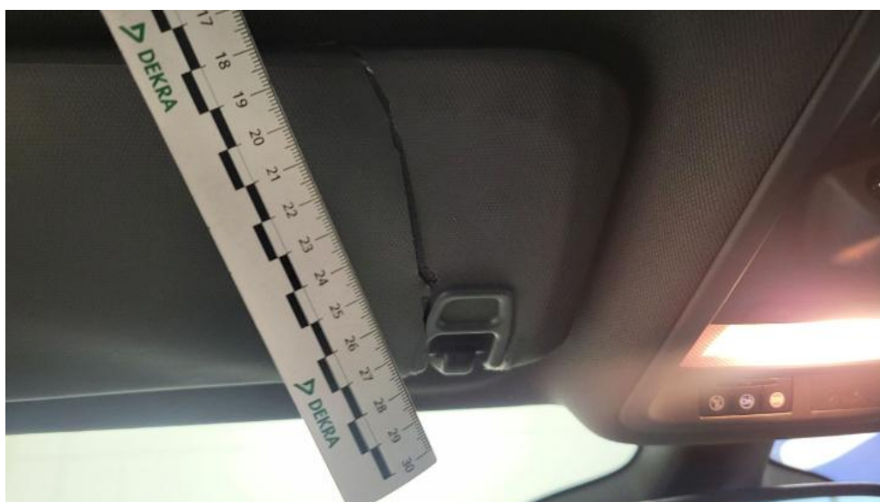
Fot. 80. Osłona p/słoneczna lewa - Pęknięcie/rozerwanie 1
