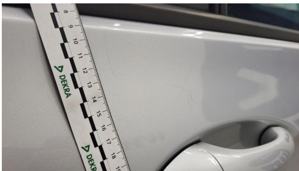
Fot. 46. Drzwi tylne P - Rysa/odprysk 1
