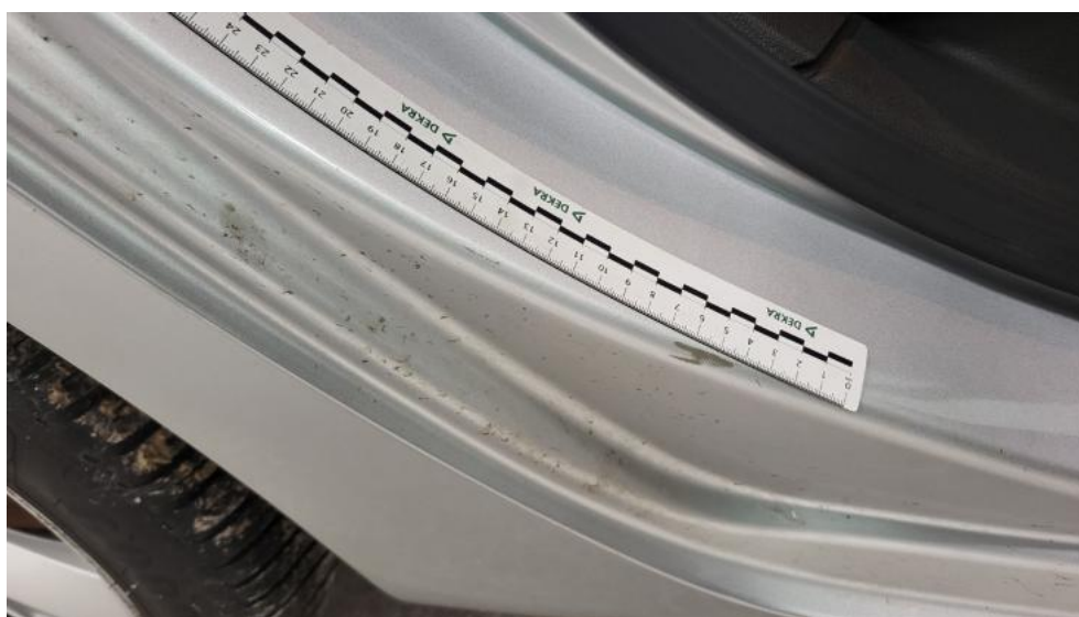
Fot. 50. Błotnik tylny P / Ściana boczna P - Rysa/odprysk 1
