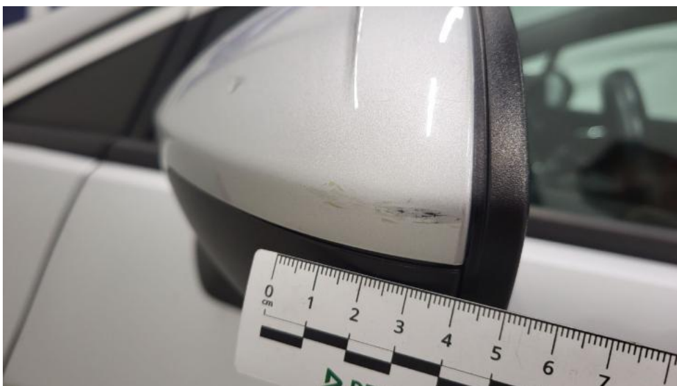
Fot. 70. Lusterko zew L - Rysa/odprysk 1
