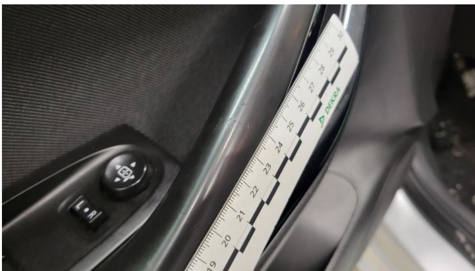
Fot. 78. Uchwyt drzwi prze L - Rysa/odprysk 1
