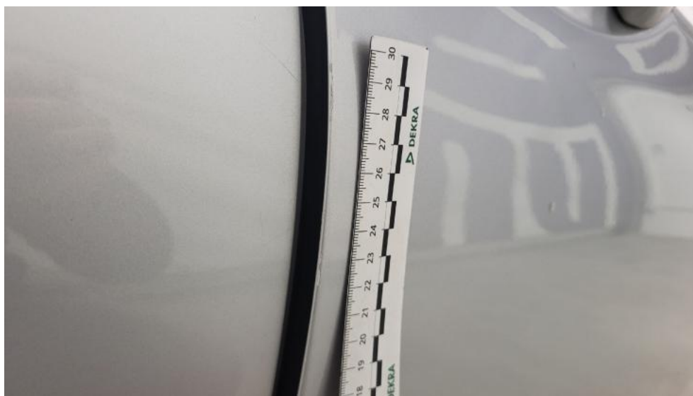
Fot. 45. Drzwi przednie P - Rysa/odprysk 1
