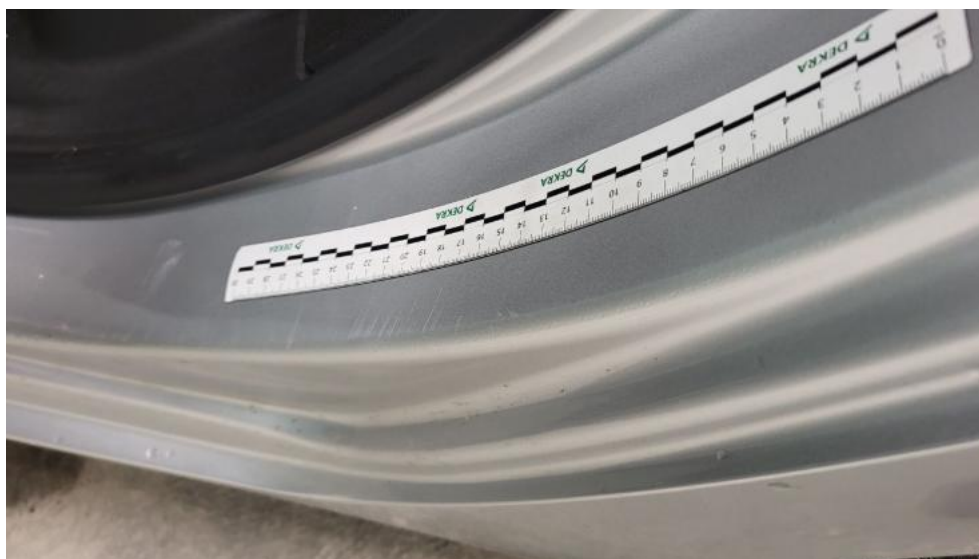
Fot. 61. Błotnik tylny L / Ściana boczna L - Rysa/odprysk 1
