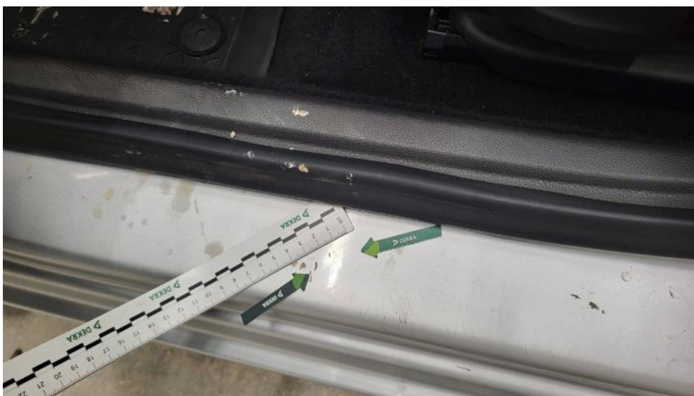
Fot. 72. Próg L - Wgniecenie/odkształcenie 1
