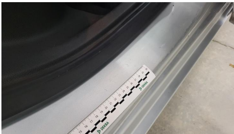
Fot. 49. Próg P - Rysa/odprysk 2
