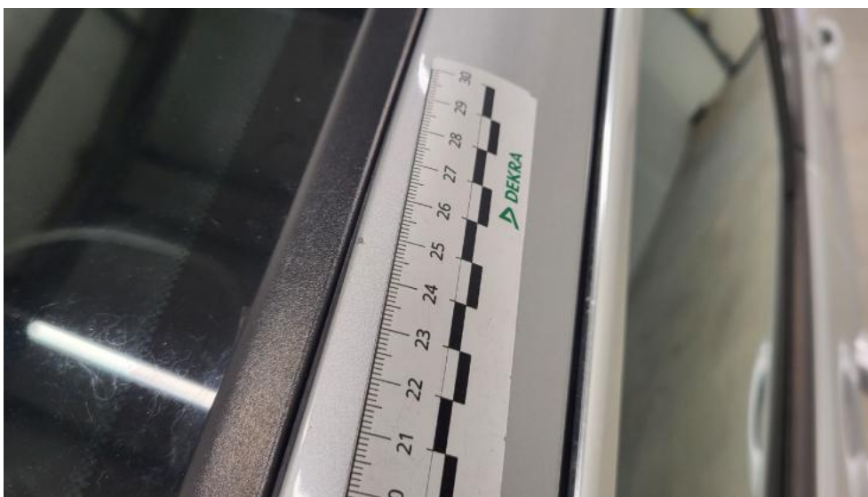
Fot. 73. Słupek przedni L - Rysa/odprysk 1
