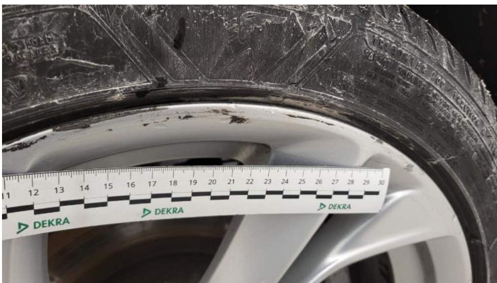
Fot. 64. Felga aluminiowa tylna L - Rysa/odprysk 1
