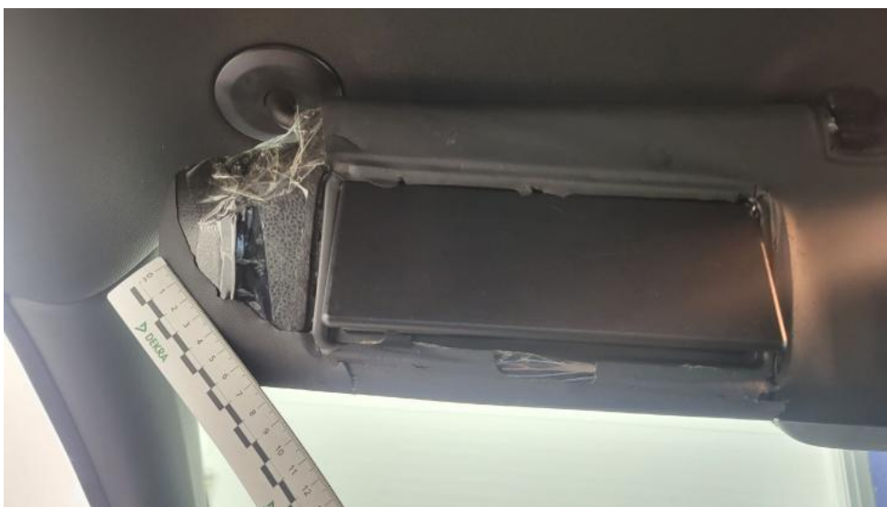
Fot. 81. Osłona p/słoneczna lewa - Pęknięcie/rozerwanie 2
