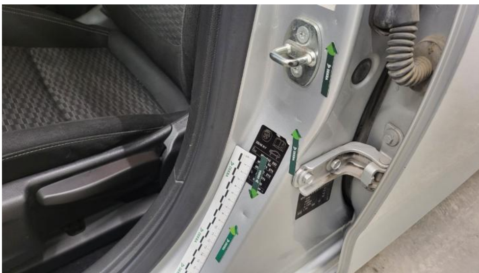
Fot. 74. Słupek środkowy L - Wgniecenie/odkształcenie 1
