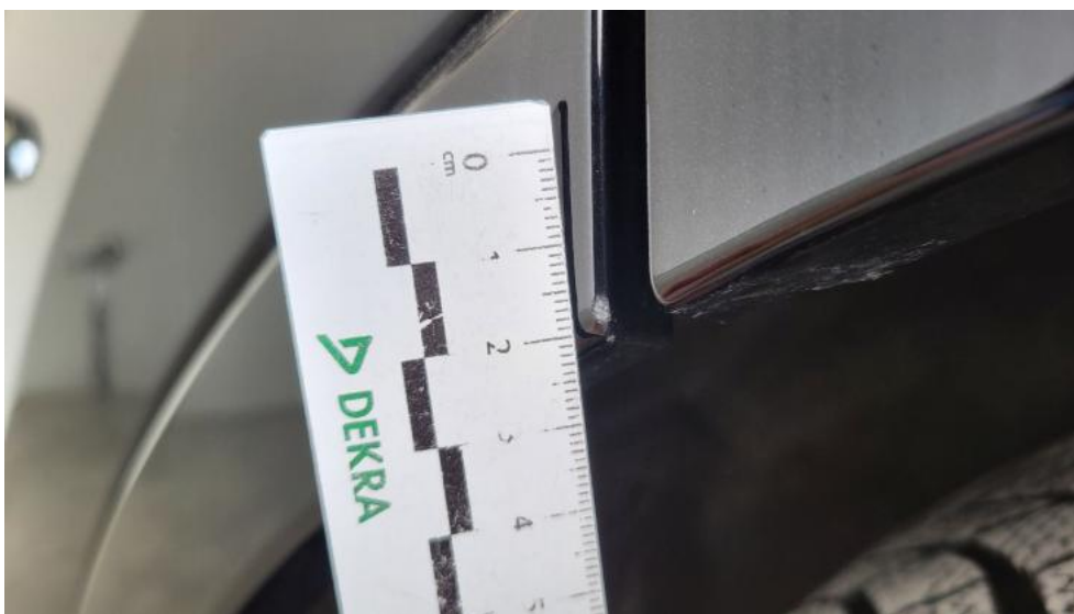
Fot. 47. Listwa drzwi tylnych L - Rysa/odprysk 1
