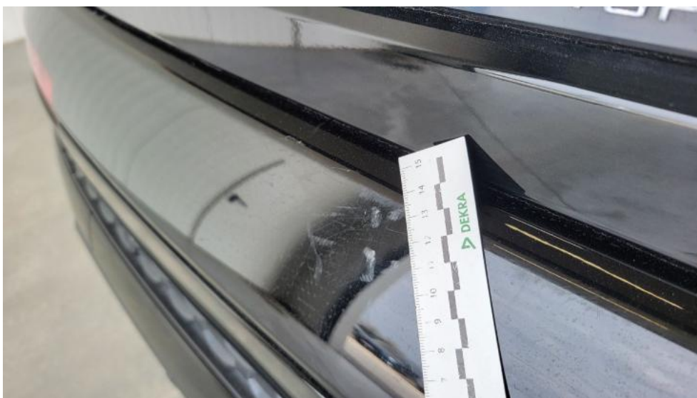
Fot. 44. Zderzak tylny - Rysa/odprysk 1
