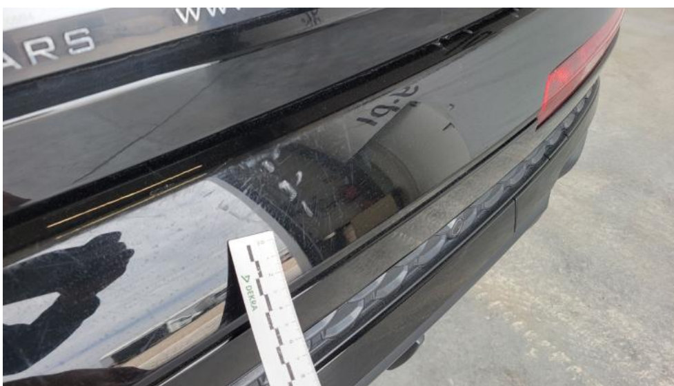
Fot. 46. Zderzak tylny - Wgniecenie/odkształcenie 1
