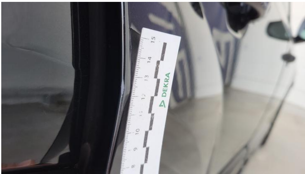
Fot. 43. Drzwi tylne P - Rysa/odprysk 1
