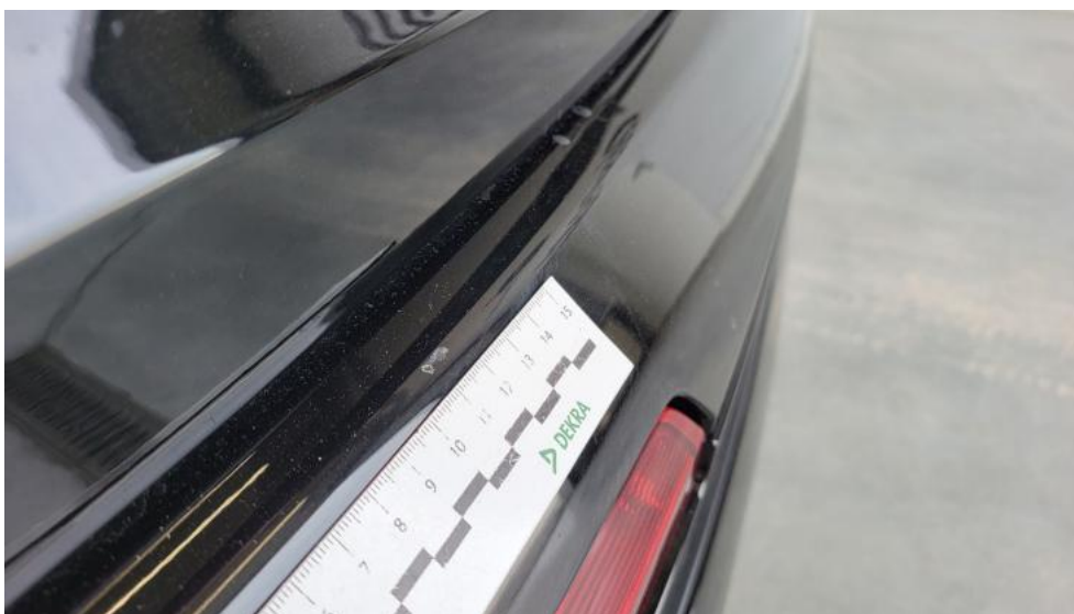
Fot. 45. Zderzak tylny - Rysa/odprysk 2
