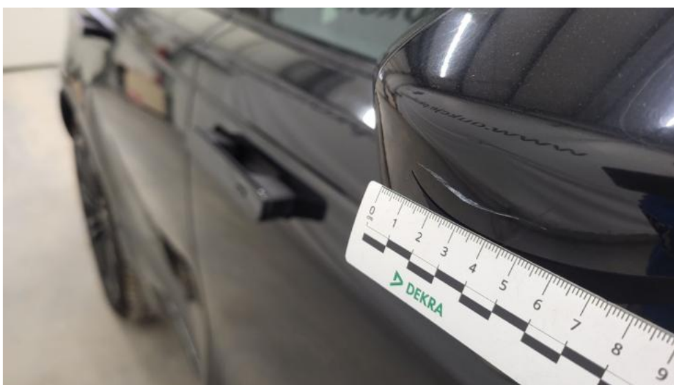
Fot. 56. Lusterko zew P - Rysa/odprysk 1
