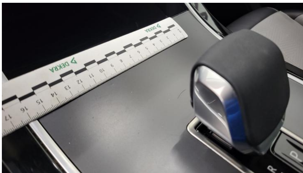
Fot. 72. Konsola tunelu śr. - Rysa/odprysk 1
