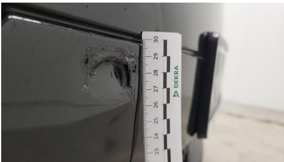
Fot. 48. Zderzak - Pęknięcie/rozerwanie 1
