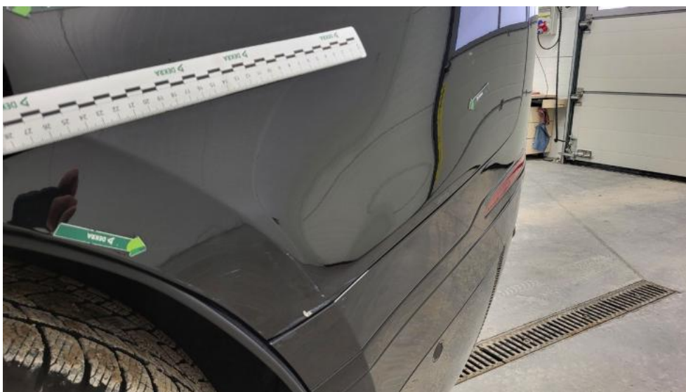
Fot. 64. Błotnik tylny L / Ściana boczna L - Wgniecenie/odkształcenie 1
