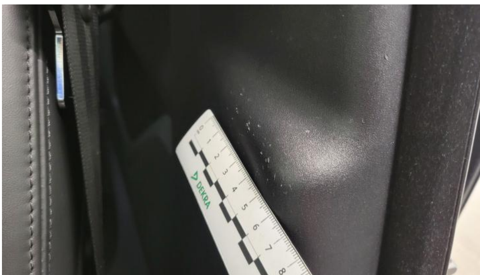
Fot. 77. Wykładzina(y) słupka środkowego L - Rysa/odprysk 1
