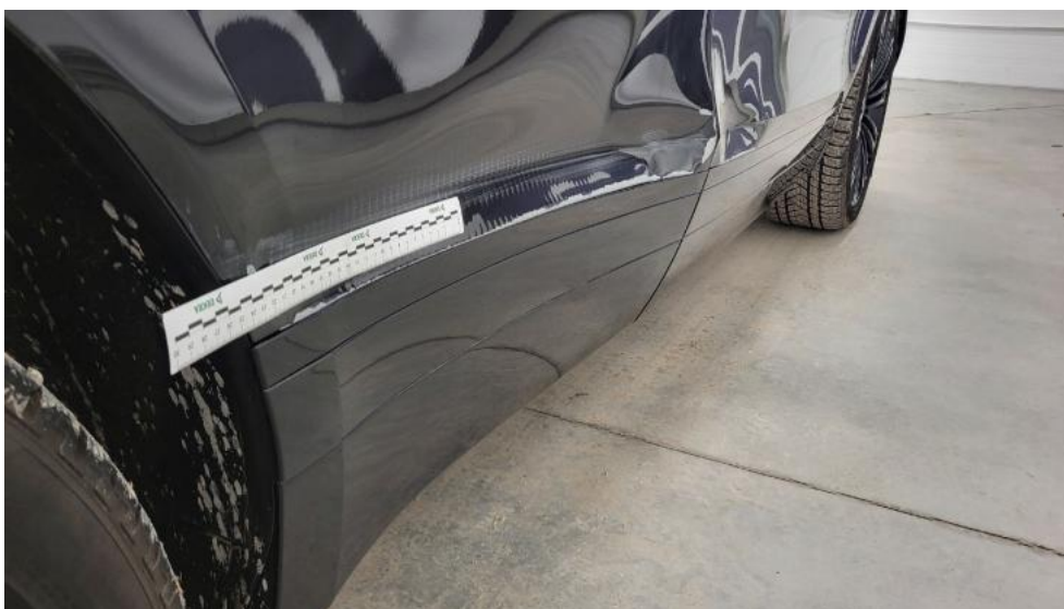
Fot. 55. Listwa drzwi tylnych P - Wgniecenie/odkształcenie 1
