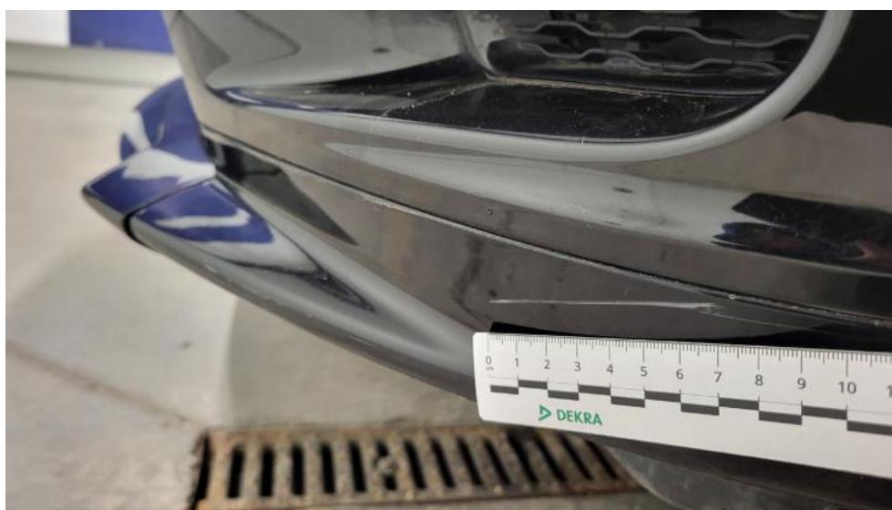
Fot. 50. Zderzak przedni cz L - Rysa/odprysk 1
