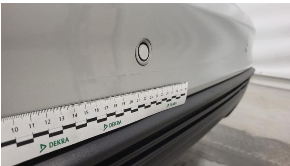
Fot. 58. Zderzak tylny - Pęknięcie/rozerwanie 2
