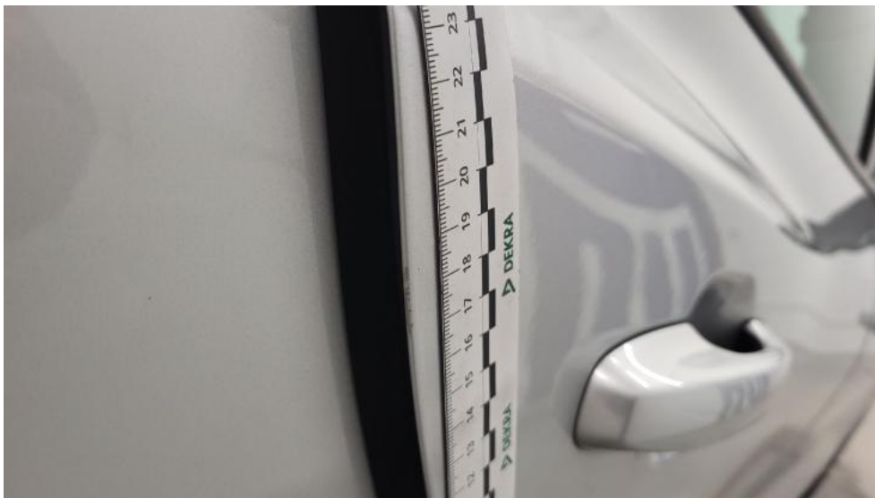
Fot. 51. Drzwi tylne P - Rysa/odprysk 1
