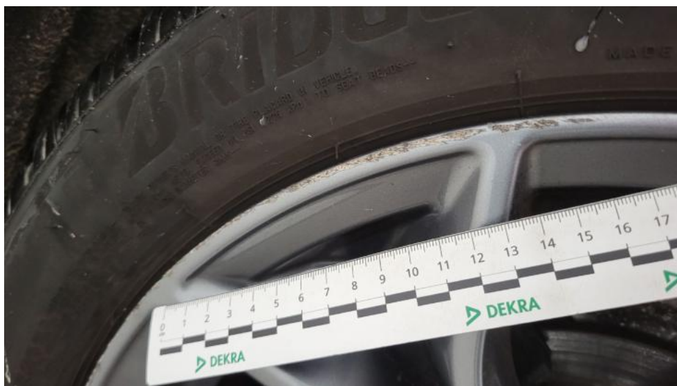
Fot. 53. Felga aluminiowa tylna P - Rysa/odprysk 1
