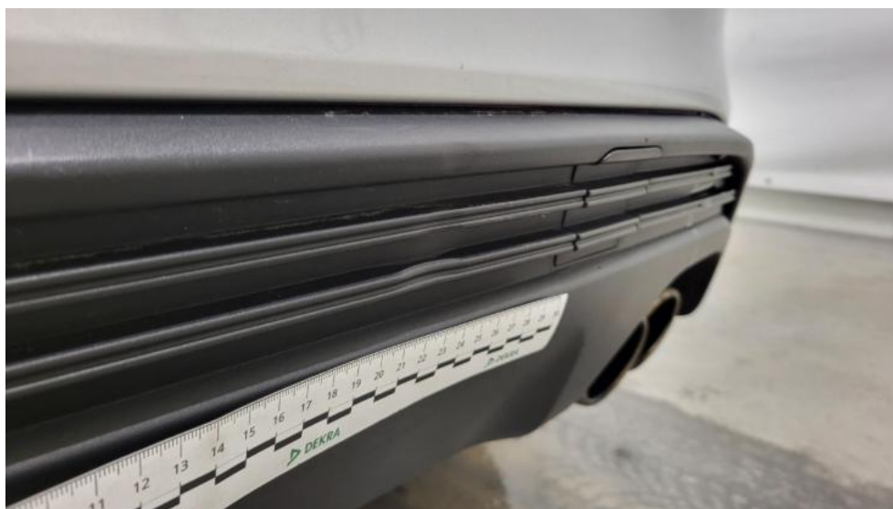
Fot. 60. Zderzak tylny cz dolna - Wgniecenie/odkształcenie 1
