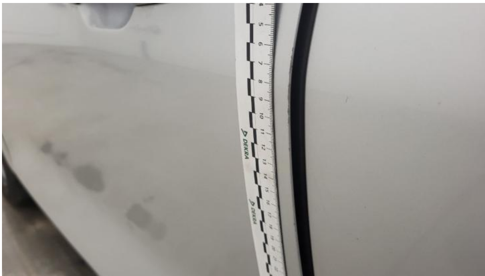
Fot. 63. Drzwi przed L - Rysa/odprysk 1
