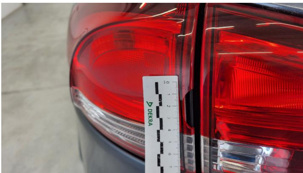
Fot. 54. Lampa tylna zew L - Pęknięcie/rozerwanie 1
