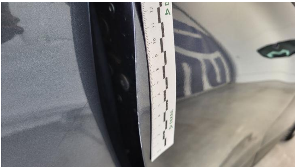
Fot. 43. Drzwi tylne P - Rysa/odprysk 1
