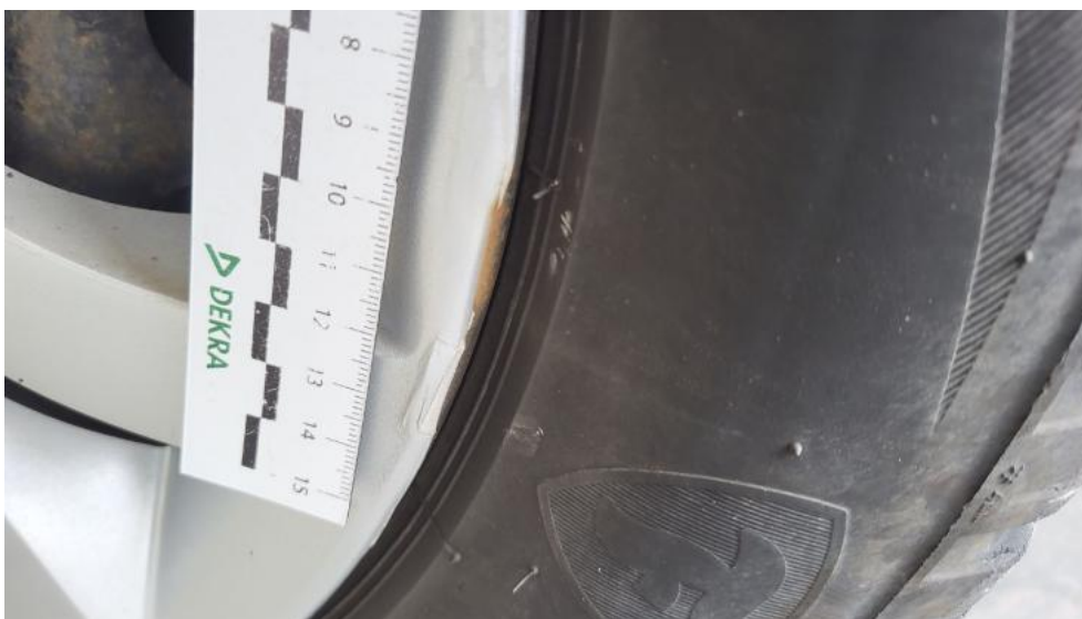
Fot. 53. Kołpak tylny L - Pęknięcie/rozerwanie 1
