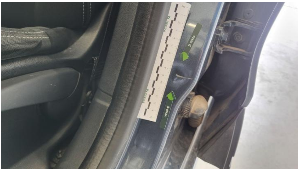
Fot. 59. Słupek środkowy L - Wgniecenie/odkształcenie 1
