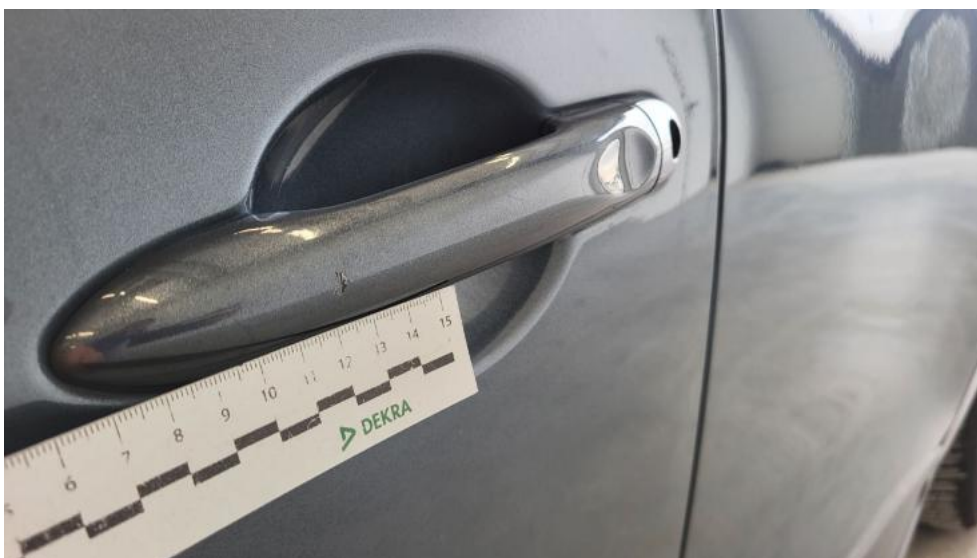
Fot. 58. Klamka drzwi prz L - Rysa/odprysk 1
