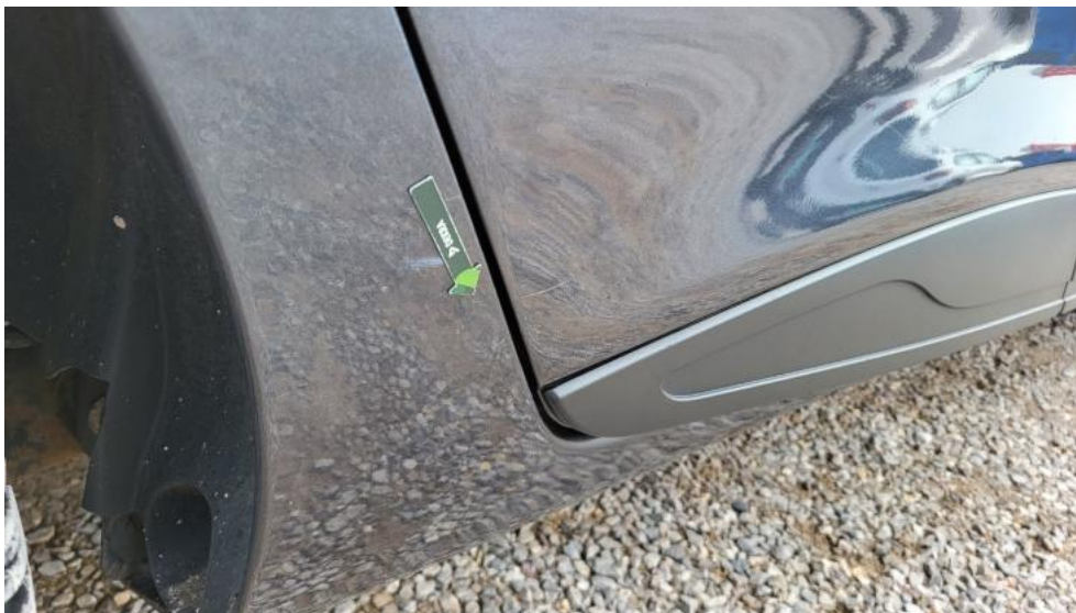
Fot. 47. Błotnik tylny P / Ściana boczna P - Wgniecenie/odkształcenie 2
