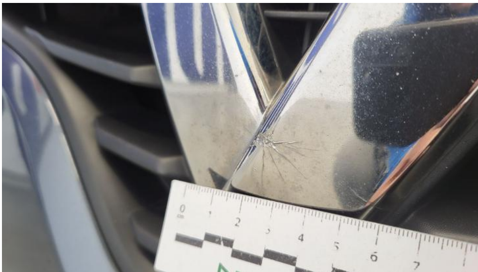
Fot. 35. Emblemat - Pęknięcie/rozerwanie 1
