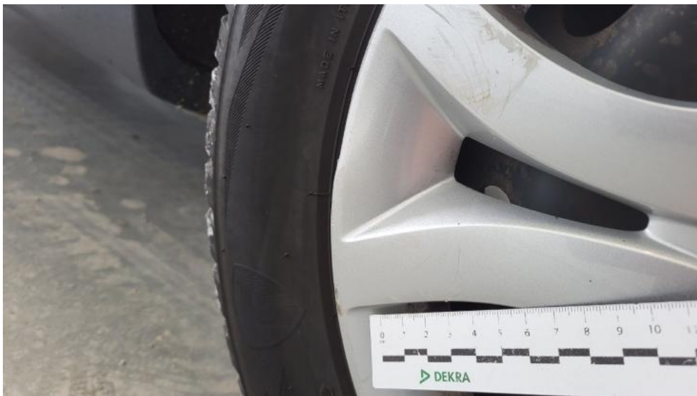
Fot. 39. Kołpak przedni P - Rysa/odprysk 1
