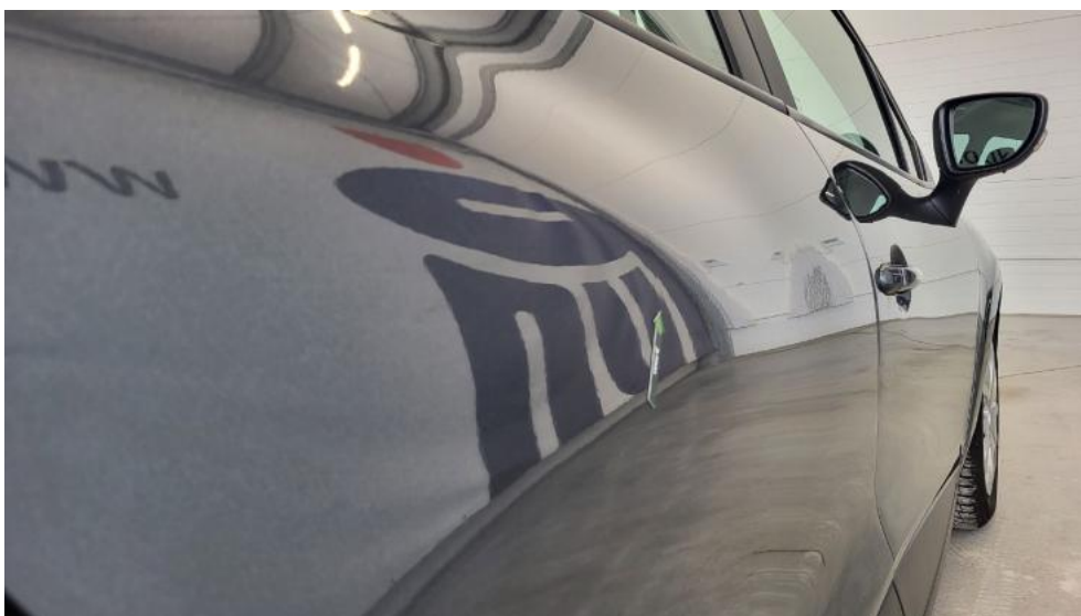
Fot. 44. Drzwi tylne P - Wgniecenie/odkształcenie 1
