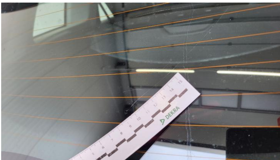
Fot. 49. Szyba tylna - Rysa/odprysk 1
