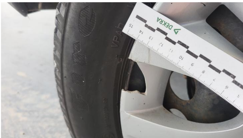
Fot. 48. Kołpak tylny P - Pęknięcie/rozerwanie 1
