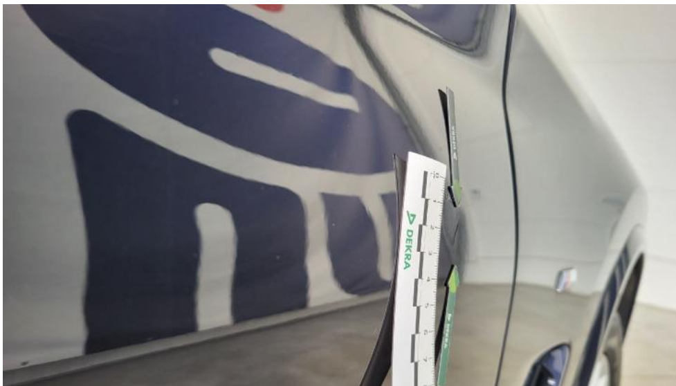
Photo 45. Drzwi przednie P - Wgniecenie/odkształcenie 1
