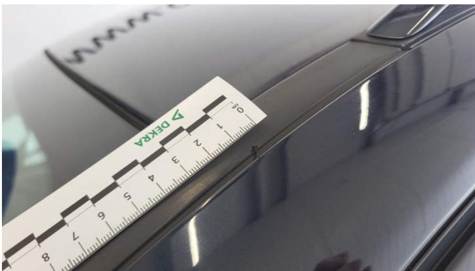
Photo 43. Uszczelka/listwa szyby czołowej - Rysa/odprysk 1
