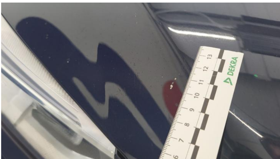
Photo 40. Pokrywa komory silnika - Rysa/odprysk 1
