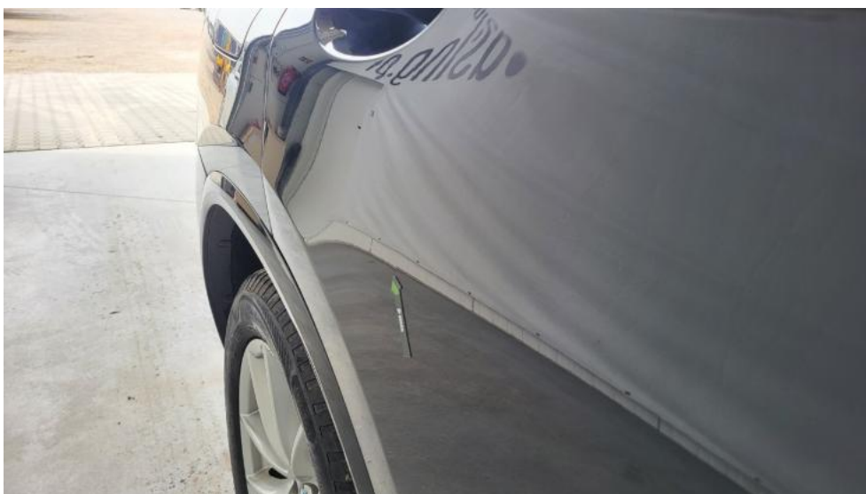
Photo 46. Drzwi tylne P - Wgniecenie/odkształcenie 1
