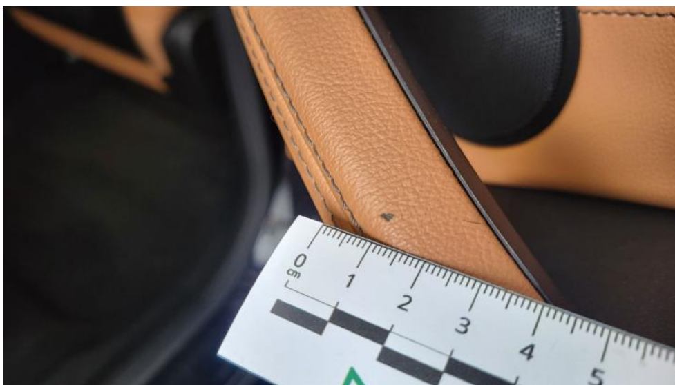
Photo 62. Uchwyt drzwi tyl P - Pęknięcie/rozerwanie 1
