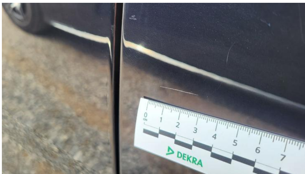
Photo 57. Drzwi tylne L - Rysa/odprysk 2
