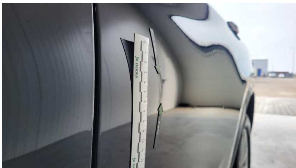
Photo 58. Drzwi tylne L - Wgniecenie/odkształcenie 1
