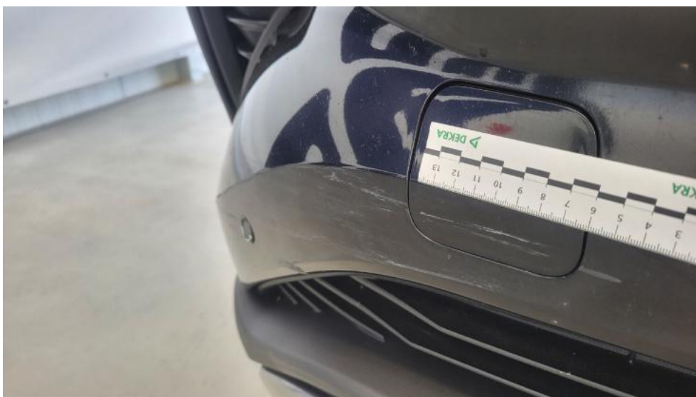
Fot. 47. Zderzak - Rysa/odprysk 2
