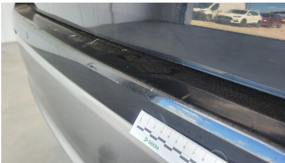
Fot. 65. Zderzak tylny - Rysa/odprysk 2
