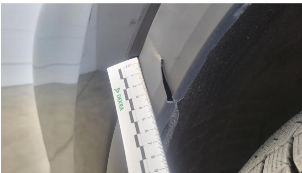
Fot. 72. Listwa błotnika przedniego L - Pęknięcie/rozerwanie 1
