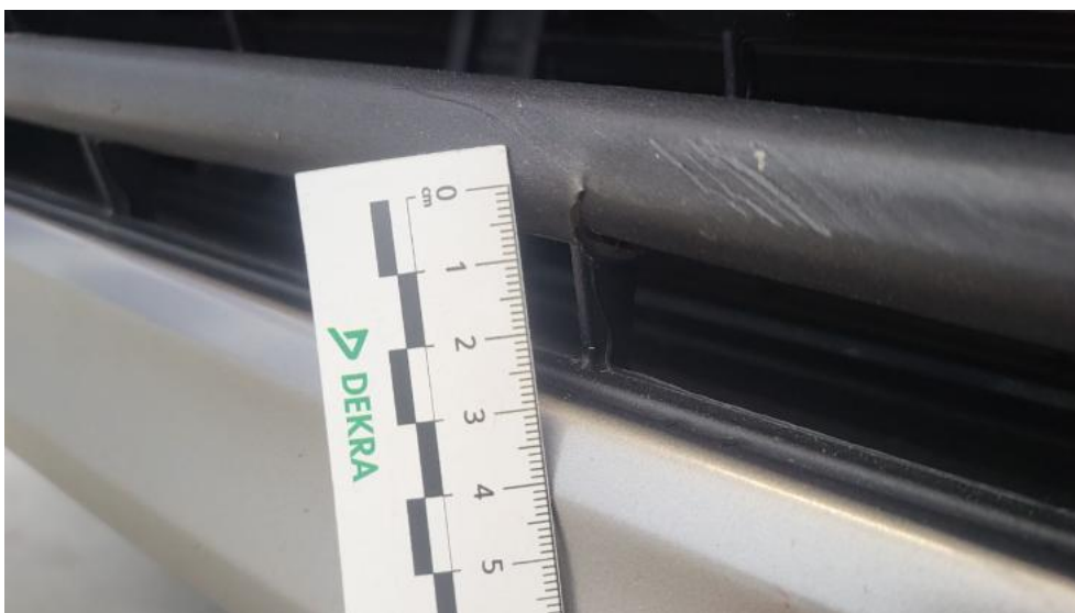
Fot. 50. Zderzak przedni cz dolna - Pęknięcie/rozerwanie 2
