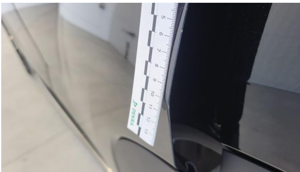
Fot. 71. Drzwi tylne L - Rysa/odprysk 1
