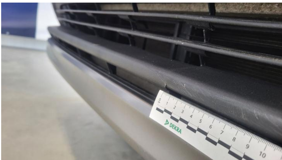
Fot. 48. Zderzak przedni cz dolna - Wgniecenie/odkształcenie 1
