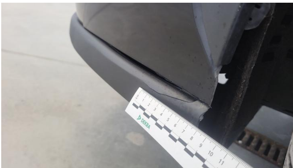
Fot. 49. Zderzak przedni cz dolna - Pęknięcie/rozerwanie 1
