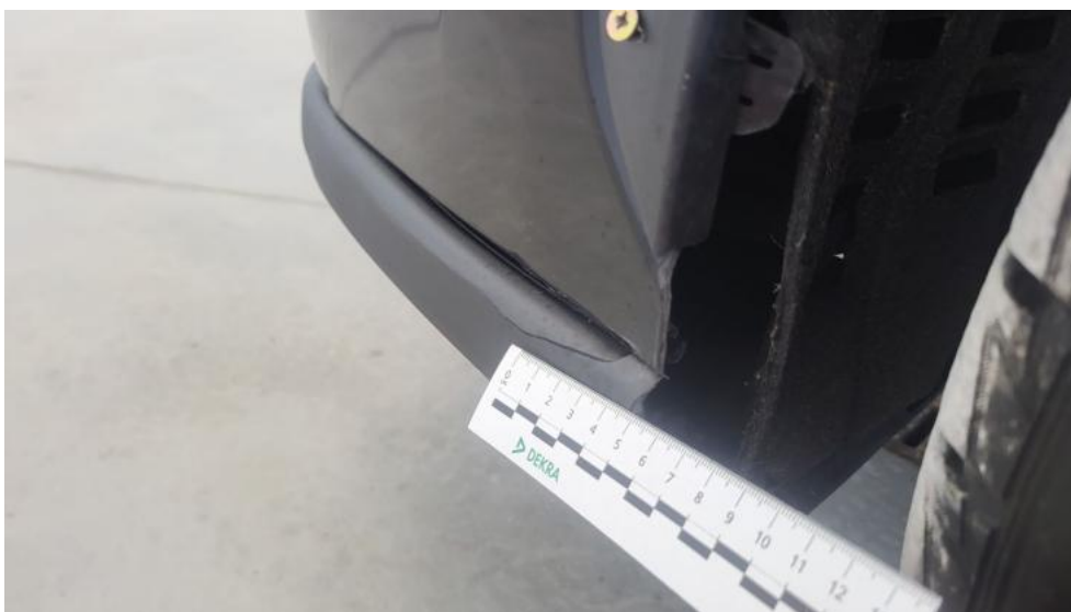
Fot. 45. Spoiler zderzaka przedniego - Pęknięcie/rozerwanie 1
