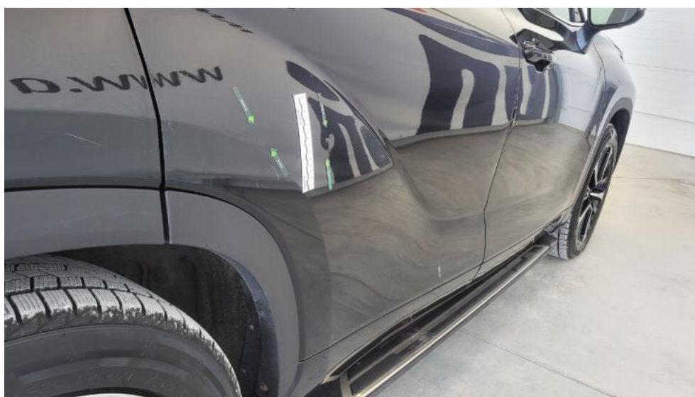
Fot. 56. Drzwi tylne P - Wgniecenie/odkształcenie 1
