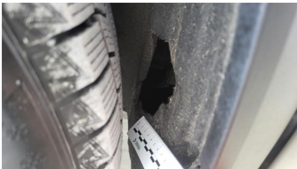
Fot. 52. Nadkole przednie P - Pęknięcie/rozerwanie 1
