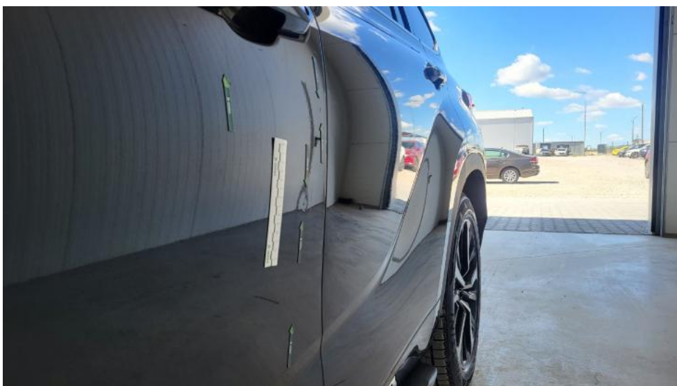
Fot. 70. Drzwi przed L - Wgniecenie/odkształcenie 1
