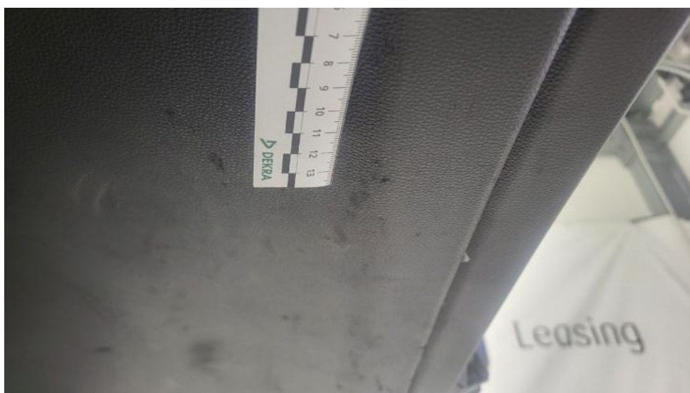
Fot. 78. Wykładzina pokrywy tylnej - Rysa/odprysk 1
