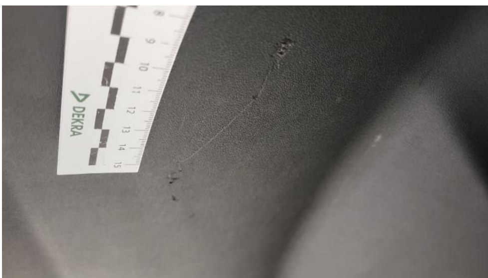
Fot. 70. Wykładzina pokrywy tylnej - Rysa/odprysk 1
