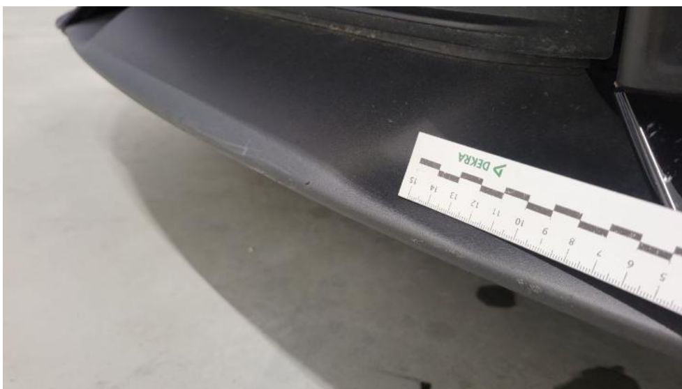
Fot. 58. Spoiler zderzaka przedniego - Rysa/odprysk 1
