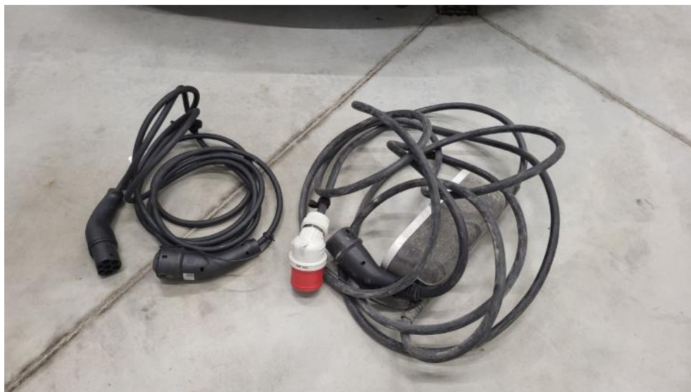
Fot. 34. Przewód ładowania baterii trakcyjnej
