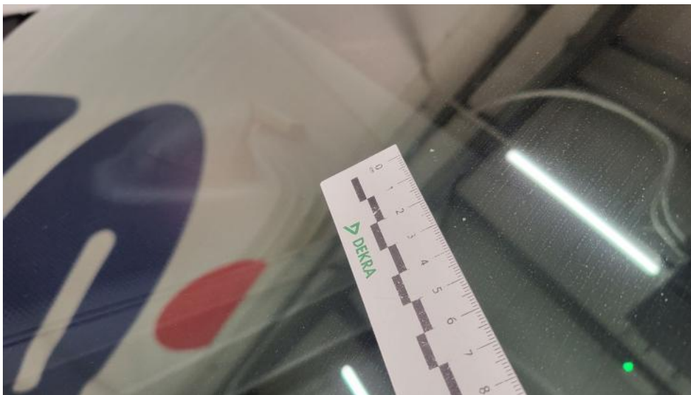
Fot. 59. Szyba czołowa - Rysa/odprysk 1
