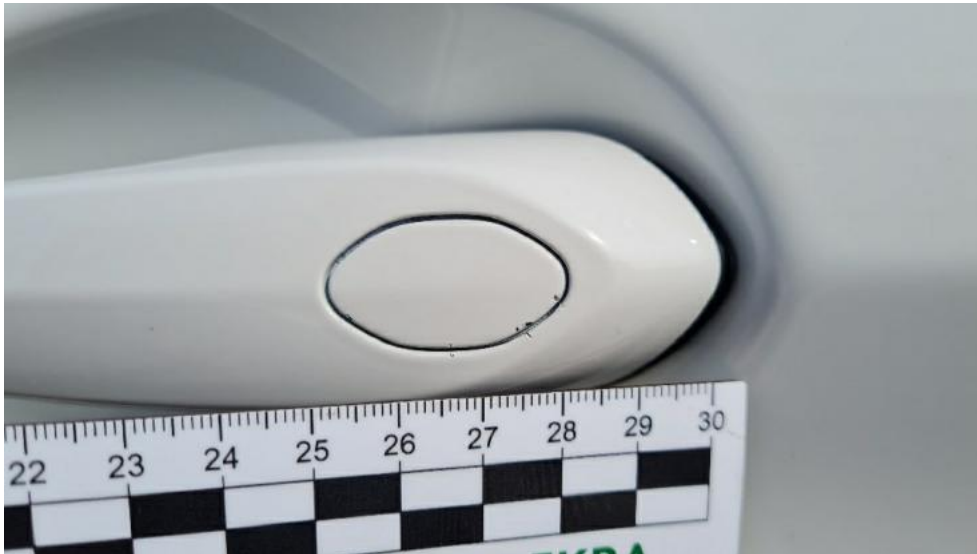
Fot. 33. Klamka drzwi prz. L (Rysa/Odprysk)
