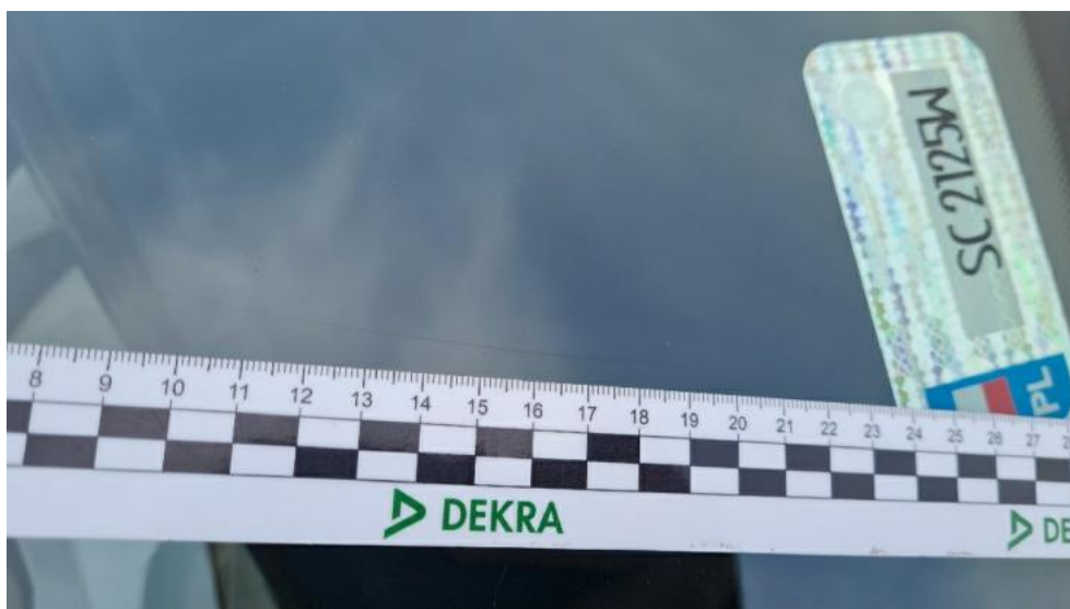
Fot. 27. Szyba czołowa (Rysa/Odprysk)
