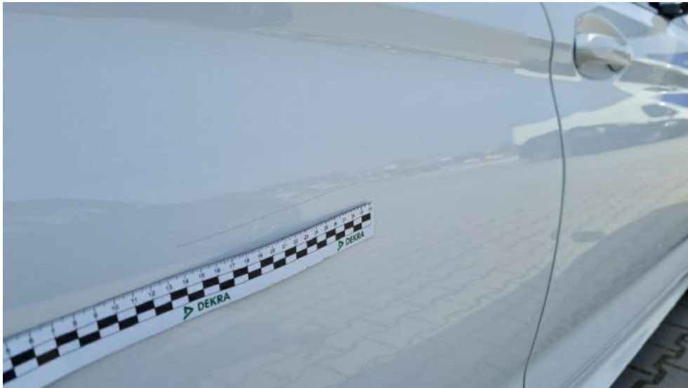
Fot. 31. Drzwi tylne prawe (Rysa/Odprysk)
