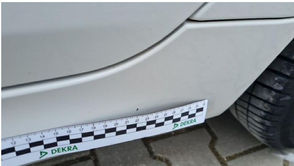
Fot. 32. Próg lewy (Rysa/Odprysk)
