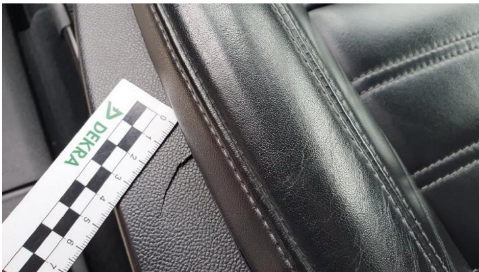
Fot. 35. Fotel lewy (Pęknięcie/Rozerwanie)
