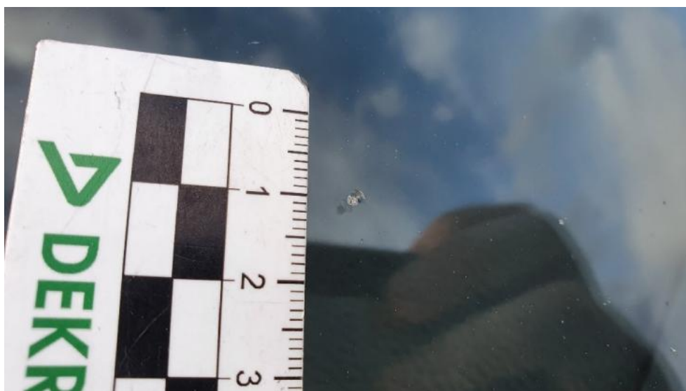
Fot. 27. Szyba czołowa (Pęknięcie/Rozzerwanie)
