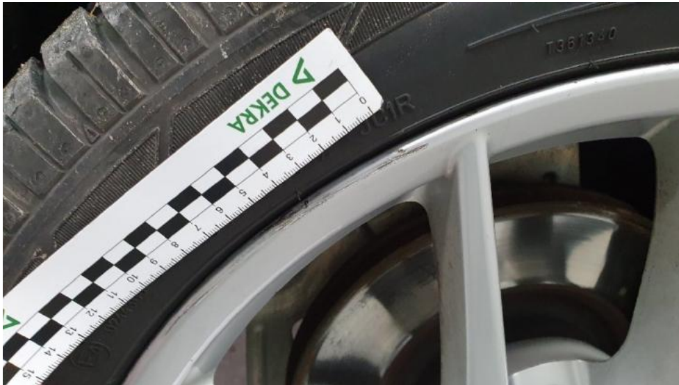
Fot. 33. Felga przednia lewa (Rysa/Odprysk)
