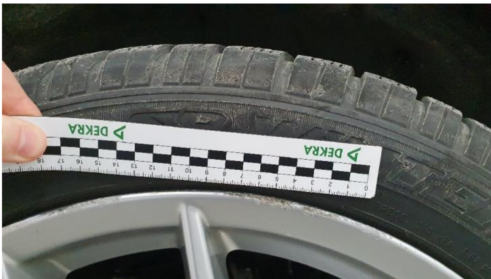
Fot. 29. Felga tylna prawa (Rysa/Odprysk)
