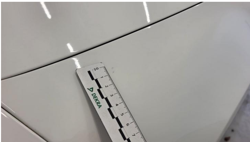
Fot. 75. Błotnik przedni L - Rysa/odprysk 1
