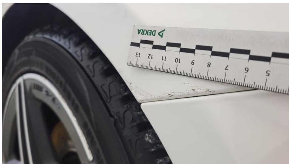
Fot. 46. Błotnik przedni P - Rysa/odprysk 1
