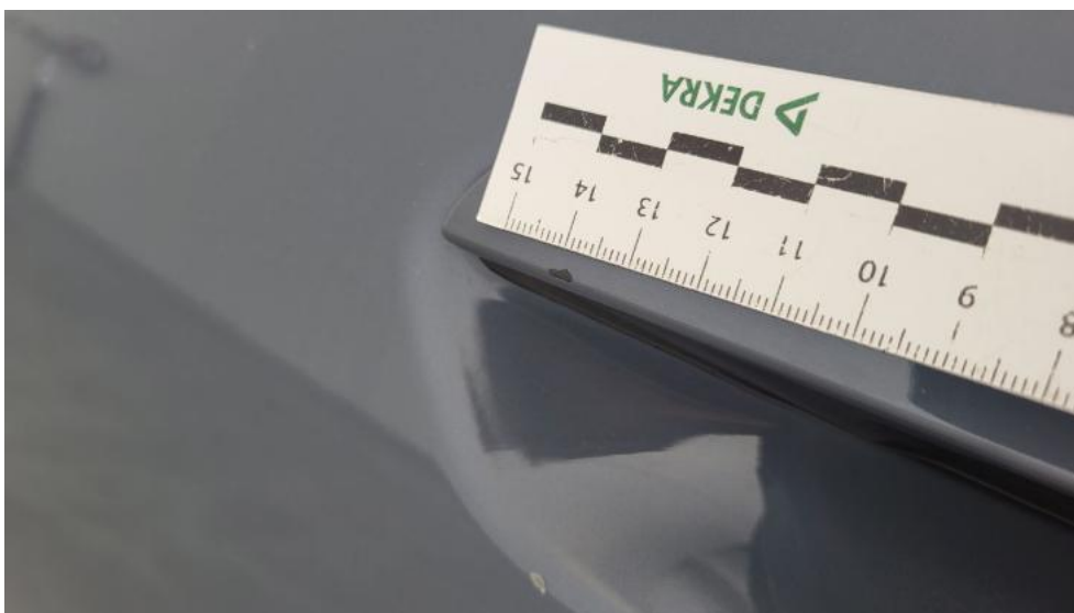
Photo 54. Klamka drzwi prz L - Rysa/odprysk 1
