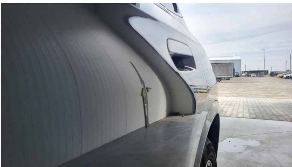
Photo 53. Drzwi tylne L - Wgniecenie/odkształcenie 1
