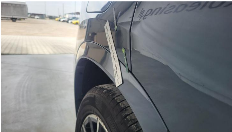
Photo 45. Błotnik tylny P / Ściana boczna P - Wgniecenie/odkształcenie 1
