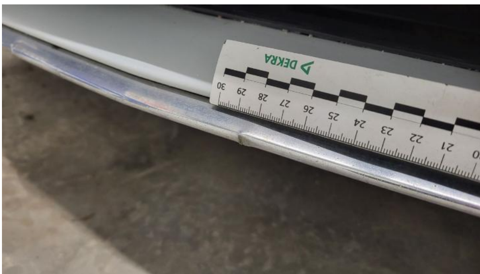
Fot. 43. Spoiler zderzaka przedniego - Wgniecenie/odkształcenie 1
