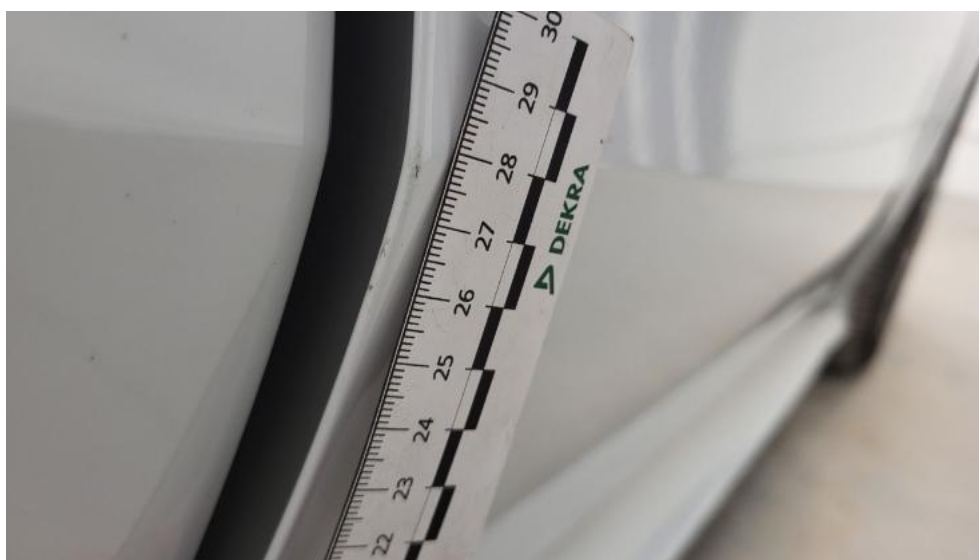
Fot. 46. Drzwi przednie P - Rysa/odprysk 1
