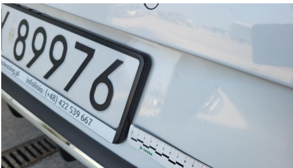
Fot. 52. Zderzak tylny - Wgniecenie/odkształcenie 2
