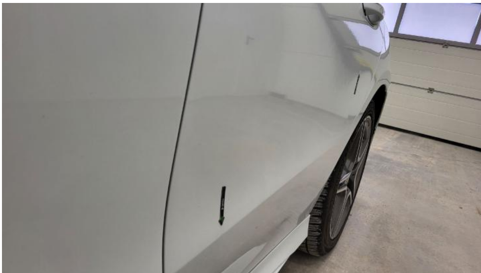
Fot. 57. Drzwi tylne L - Wgniecenie/odkształcenie 1
