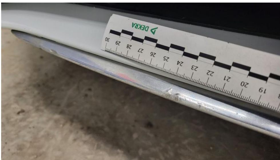
Fot. 44. Spoiler zderzaka przedniego - Wgniecenie/odkształcenie 2
