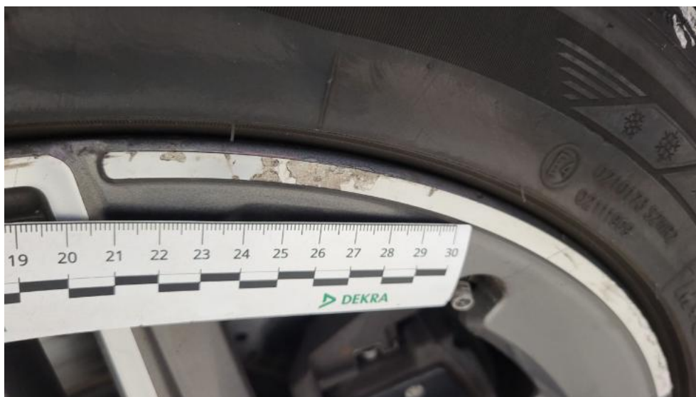
Fot. 45. Felga aluminiowa przednia P - Rysa/odprysk 1
