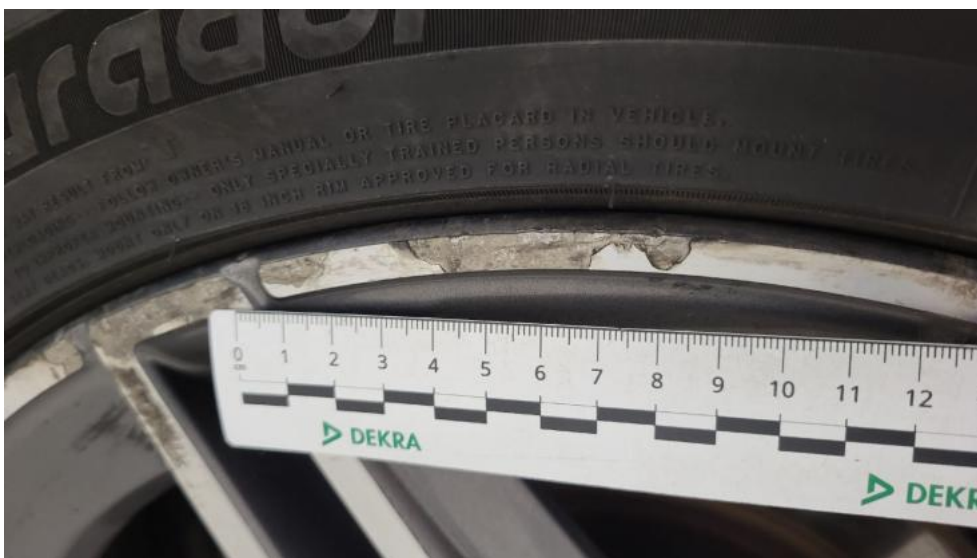
Fot. 48. Felga aluminiowa tylna P - Rysa/odprysk 1
