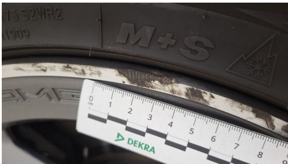
Fot. 59. Felga Aluminiowa przednia L - Rysa/odprysk 1
