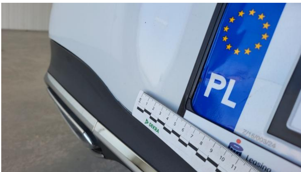
Fot. 51. Zderzak tylny - Wgniecenie/odkształcenie 1
