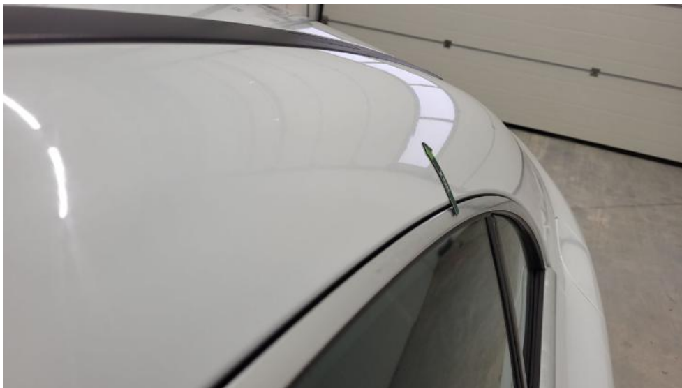
Fot. 53. Błotnik tylny L / Ściana boczna L - Wgniecenie/odkształcenie 1
