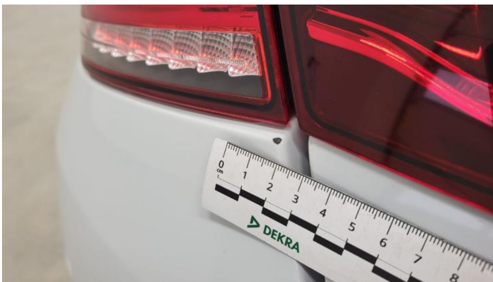
Fot. 49. Zderzak tylny - Rysa/odprysk 1
