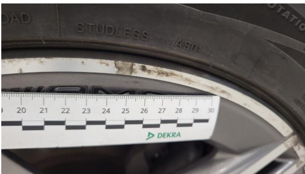
Fot. 54. Felga aluminiowa tylna L - Rysa/odprysk 1
