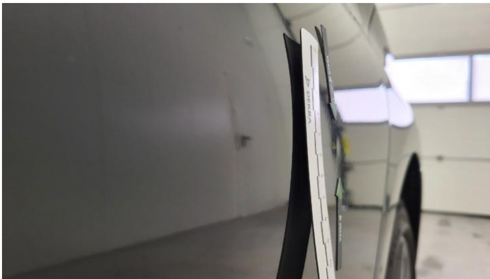
Fot. 67. Drzwi tylne L - Wgniecenie/odkształcenie 1
