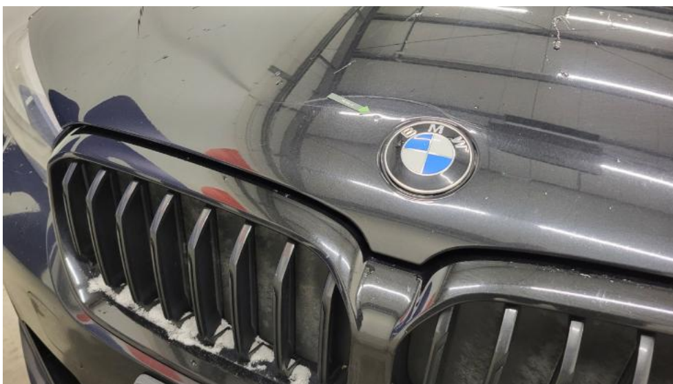
Fot. 42. Pokrywa komory silnika - Wgniecenie/odkształcenie 1
