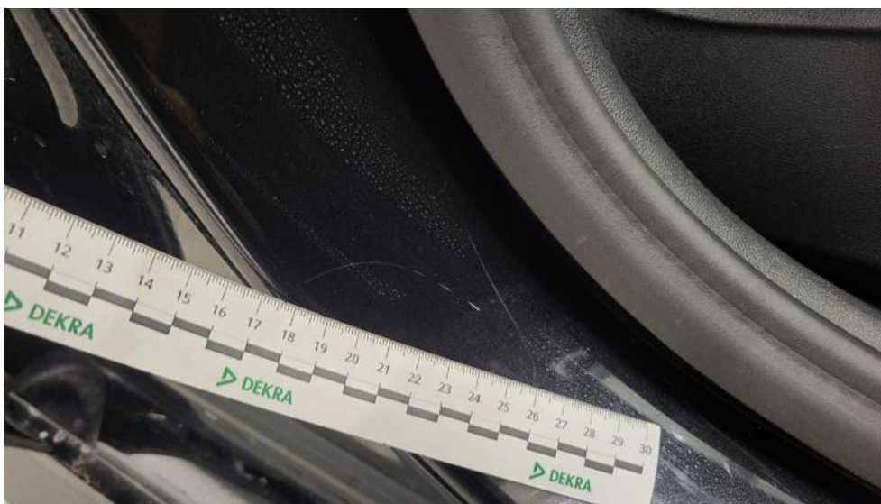
Fot. 57. Słupek środkowy P - Rysa/odprysk 1
