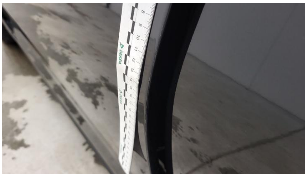
Fot. 66. Drzwi przed L - Rysa/odprysk 1
