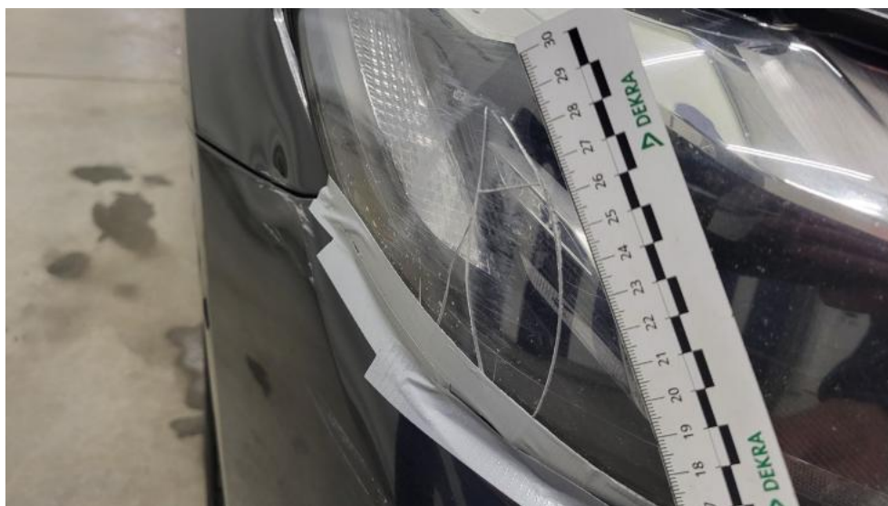
Fot. 52. Reflektor P - Pęknięcie/rozerwanie 1
