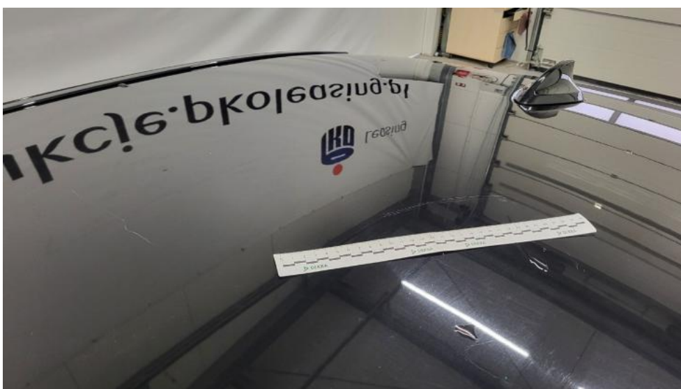
Fot. 64. Dach - Rysa/odprysk 1
