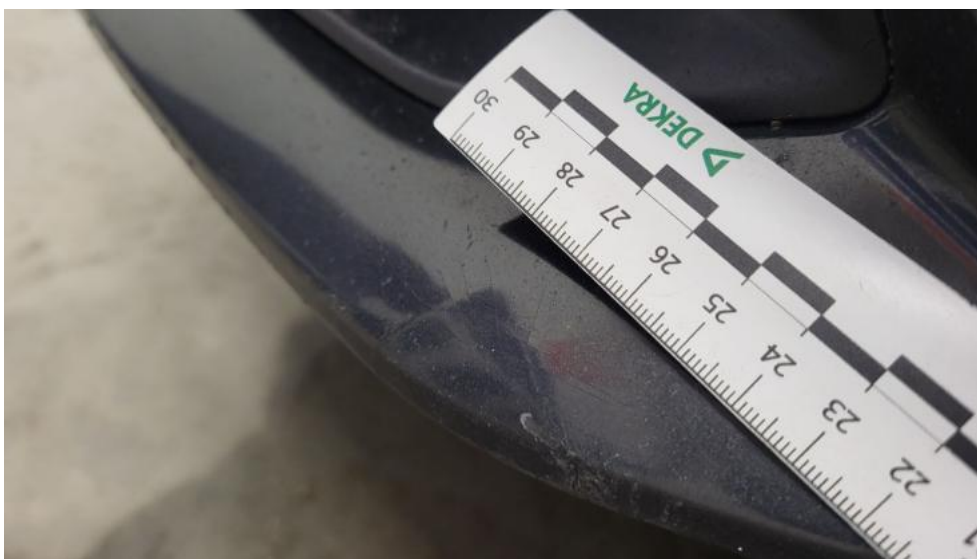
Fot. 49. Zderzak - Pęknięcie/rozerwanie 1
