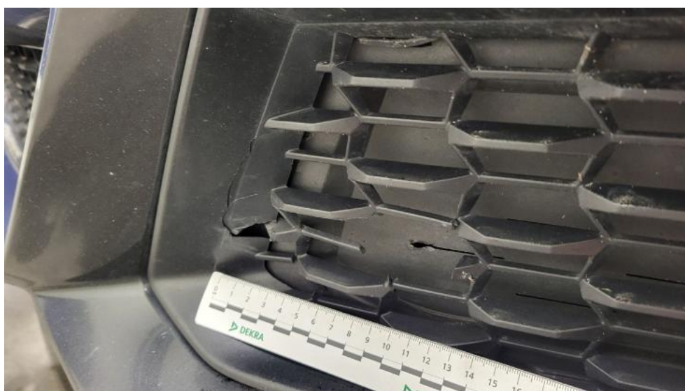
Fot. 40. Kratka/zaślepka halogenu L - Pęknięcie/rozerwanie 1
