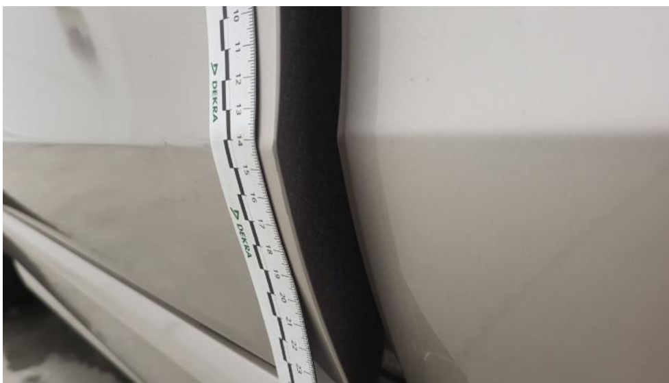
Fot. 67. Drzwi przed L - Rysa/odprysk 1
