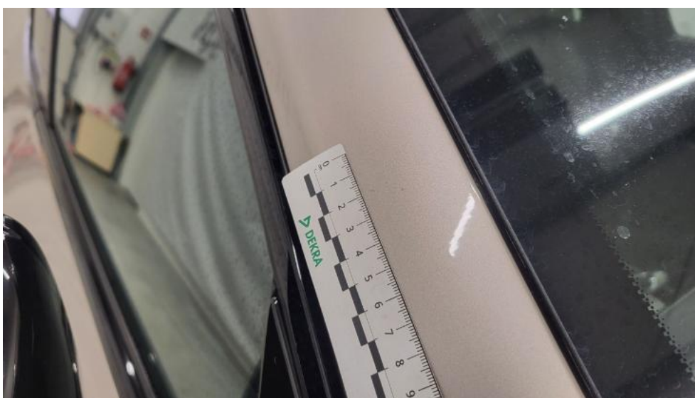
Fot. 56. Słupek przedni P - Rysa/odprysk 1
