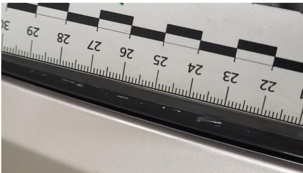
Fot. 73. Reflektor L - Pęknięcie/rozerwanie 1
