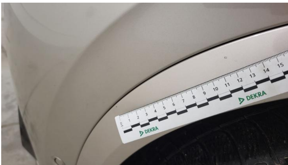
Fot. 71. Listwa błotnika przedniego L - Rysa/odprysk 1
