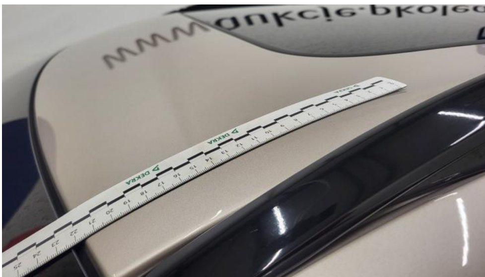
Fot. 63. Dach - Rysa/odprysk 1
