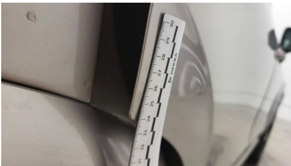
Fot. 54. Drzwi tylne P - Rysa/odprysk 1
