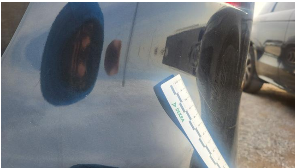
Fot. 65. Zderzak tylny - Rysa/odprysk 1
