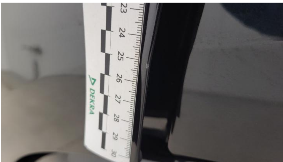
Fot. 71. Drzwi tylne L - Rysa/odprysk 1
