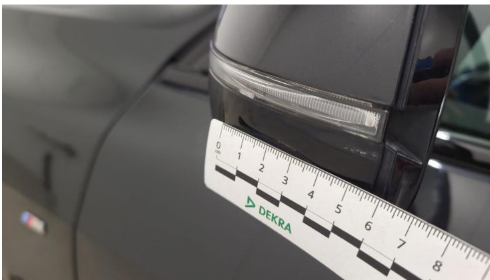
Fot. 72. Lusterko zew L - Rysa/odprysk 1
