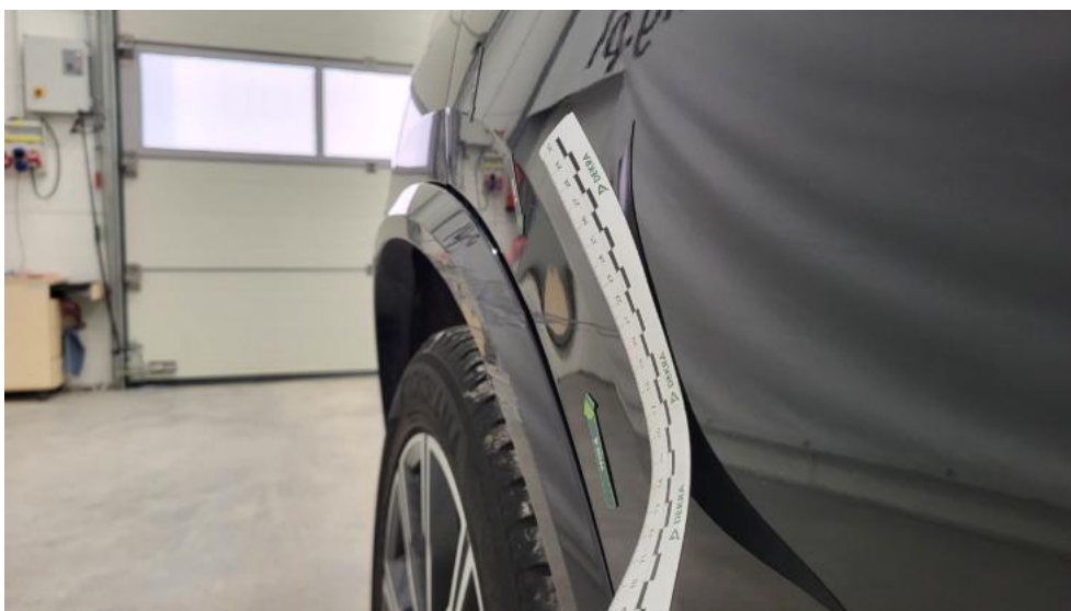
Fot. 58. Drzwi tylne P - Wgniecenie/odkształcenie 1
