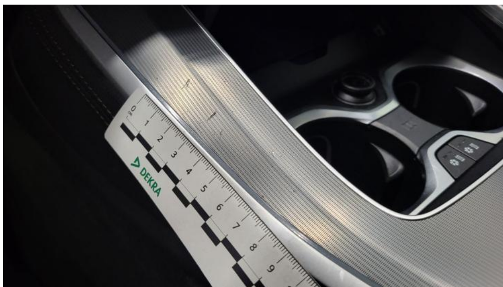
Fot. 76. Konsola tunelu śr. - Rysa/odprysk 1
