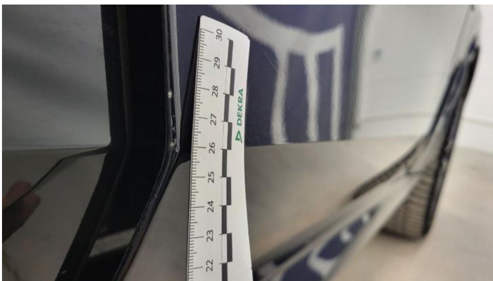
Fot. 54. Drzwi przednie P - Rysa/odprysk 2
