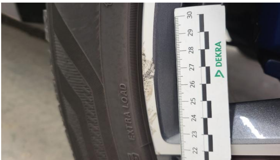
Fot. 68. Felga aluminiowa tylna L - Rysa/odprysk 1
