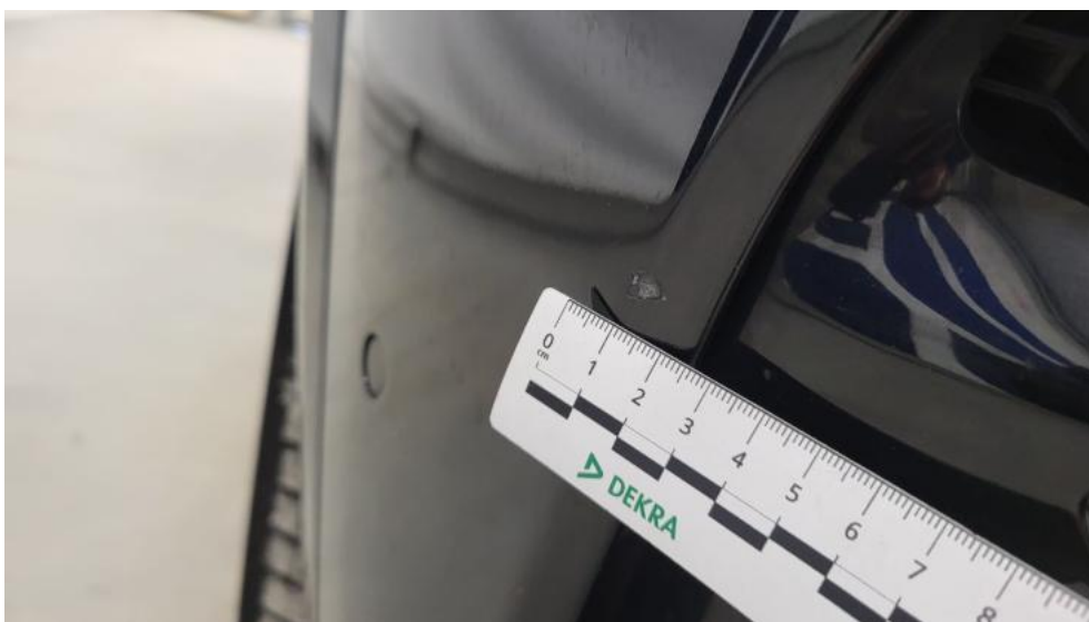
Fot. 47. Zderzak - Rysa/odprysk 2
