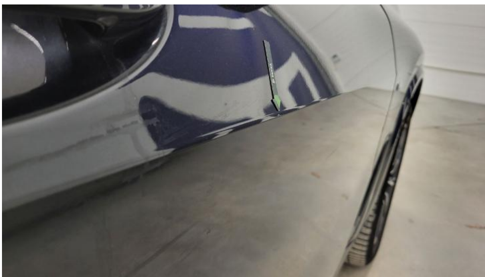
Fot. 55. Drzwi przednie P - Wgniecenie/odkształcenie 1
