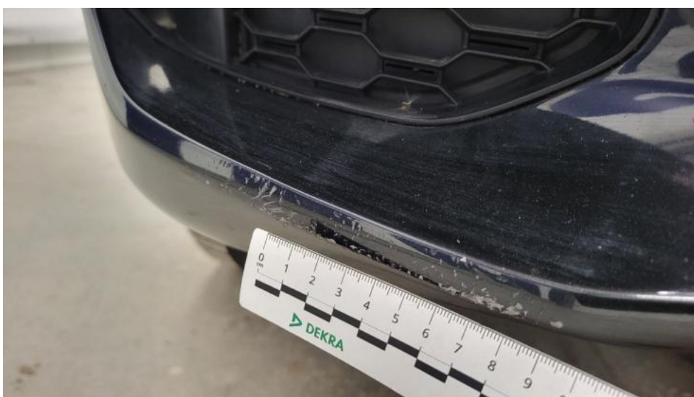
Fot. 48. Zderzak() - Rysa/odprysk 3
