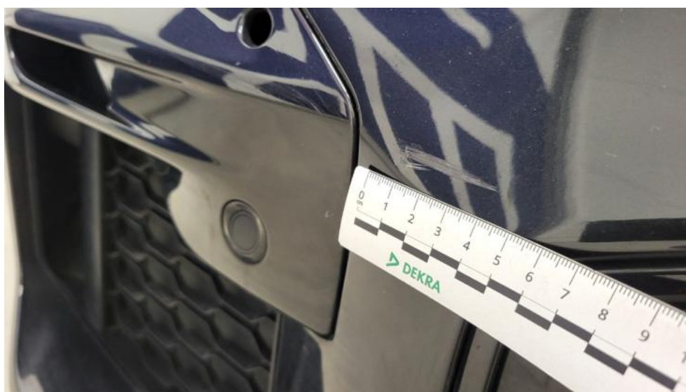
Fot. 46. Zderzak - Rysa/odprysk 1
