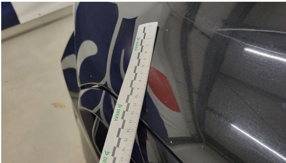
Fot. 43. Pokrywa komory silnika - Rysa/odprysk 1
