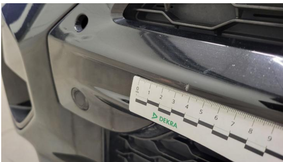
Fot. 42. Kratka/zaślepka halogenu L - Rysa/odprysk 1
