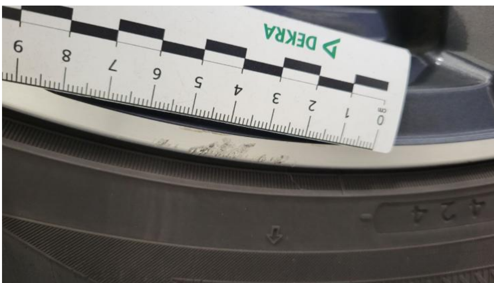
Fot. 50. Felga aluminiowa przednia P - Rysa/odprysk 1
