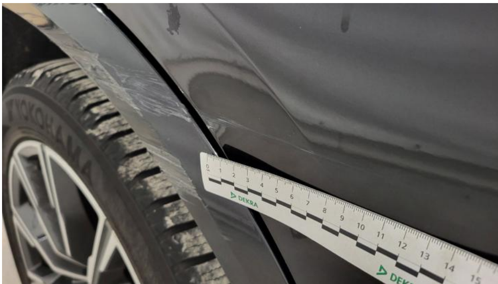
Fot. 57. Drzwi tylne P - Rysa/odprysk 2
