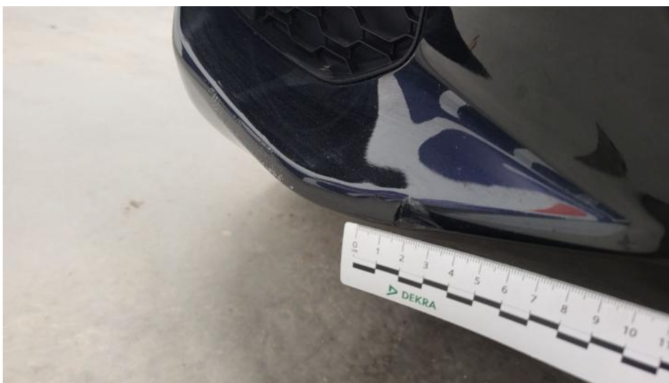
Fot. 49. Zderzak - Wgniecenie/odkształcenie 1
