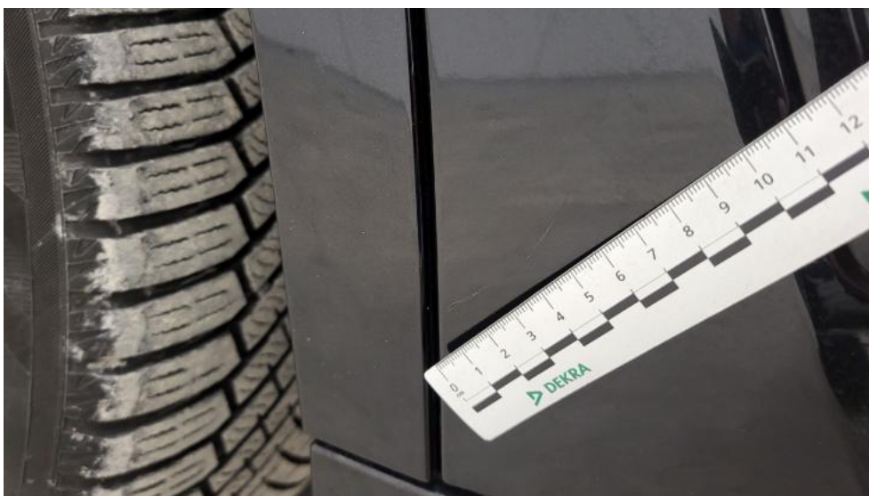
Fot. 74. Błotnik przedni L - Rysa/odprysk 1
