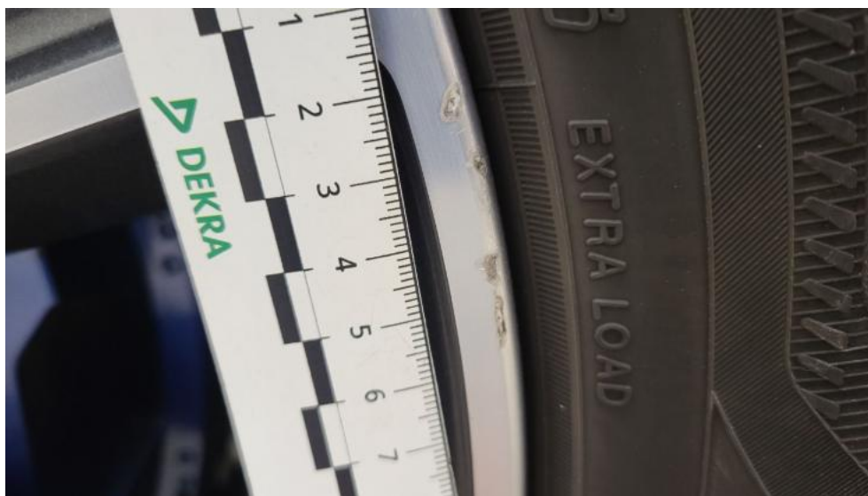
Fot. 75. Felga Aluminiowa przednia L - Rysa/odprysk 1
