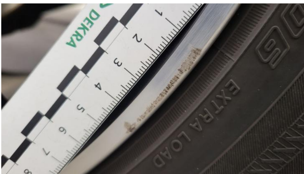
Fot. 60. Felga aluminiowa tylna P - Rysa/odprysk 1
