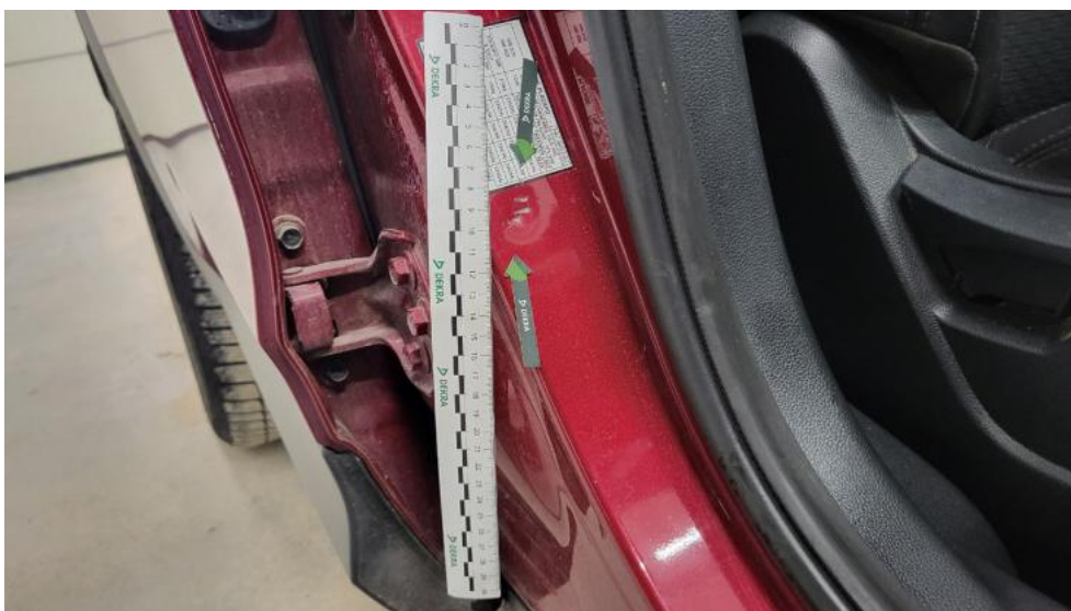
Fot. 46. Stupek środkowy P - Wgniecenie/odkształcenie 1
