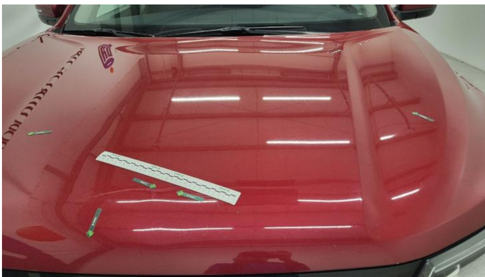
Fot. 38. Pokrywa komory silnika - Wgniecenie/odkształcenie 1
