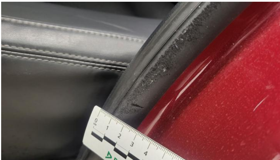
Fot. 65. Uszczelka drzwi tylnych L - Rysa/odprysk 1
