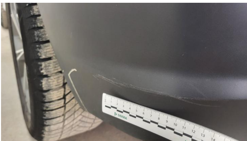
Fot. 54. Zderzak tylny cz dolna - Rysa/odprysk 1
