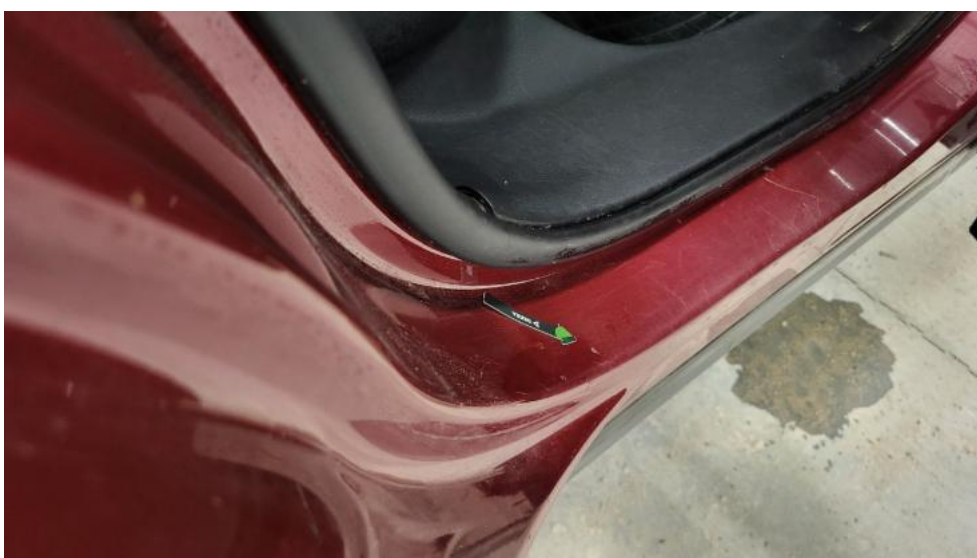
Fot. 44. Próg P - Wgniecenie/odkształcenie 1
