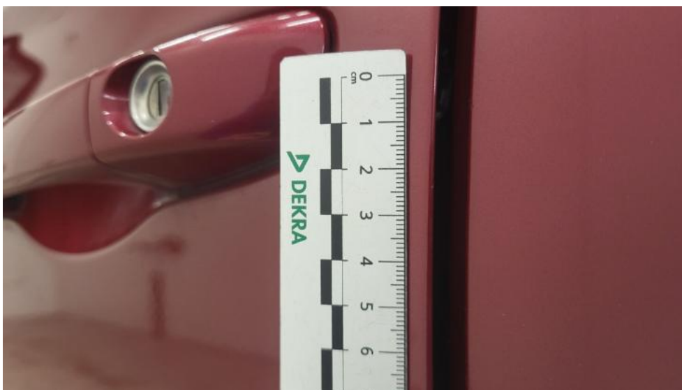
Fot. 57. Drzwi przed L - Rysa/odprysk 1
