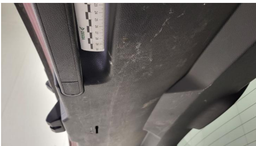
Fot. 72. Wykładzina pokrywy tylnej - Rysa/odprysk 1
