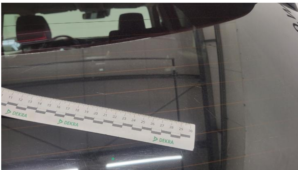
Fot. 51. Szyba tylna - Rysa/odprysk 1
