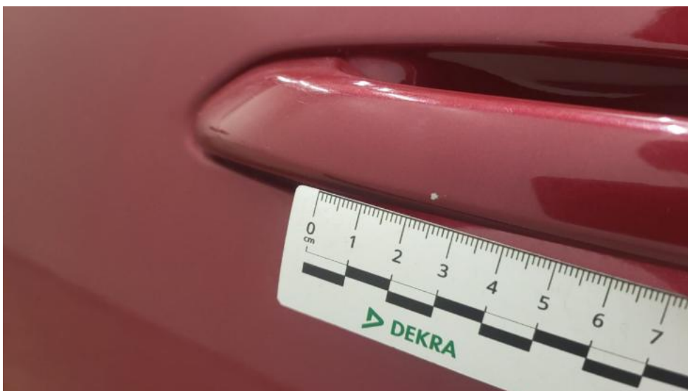
Fot. 60. Klamka drzwi tyl L - Rysa/odprysk 1
