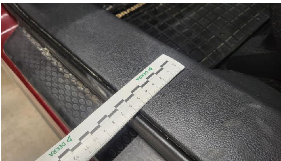
Fot. 71. Listwy progowe lew. - Rysa/odprysk 1
