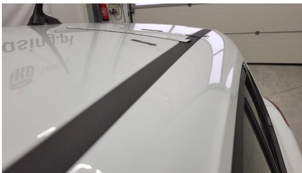
Fot. 50. Dach - Wgniecenie/odkształcenie 1
