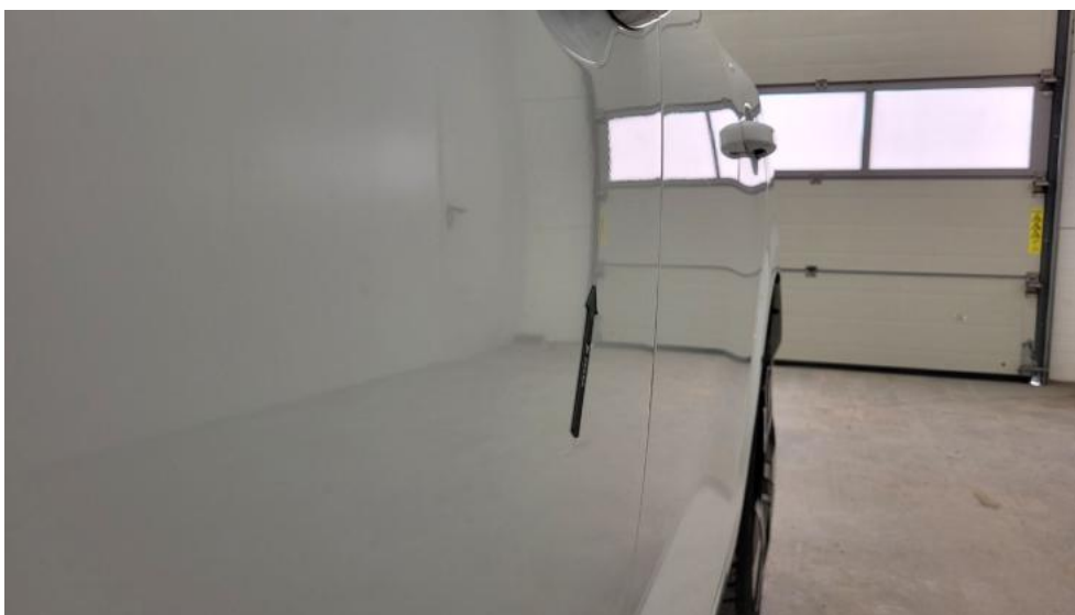
Fot. 55. Drzwi przed L - Wgniecenie/odkształcenie 1
