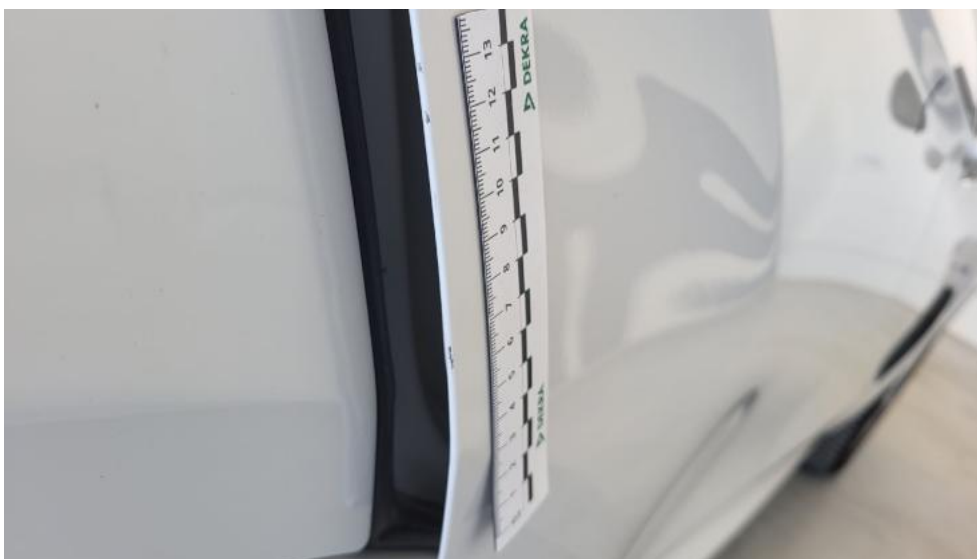
Fot. 47. Drzwi tylne P - Rysa/odprysk 1
