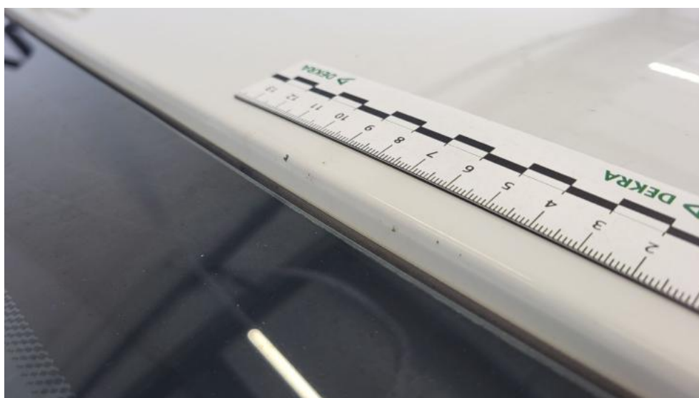
Fot. 52. Dach - Rysa/odprysk 1
