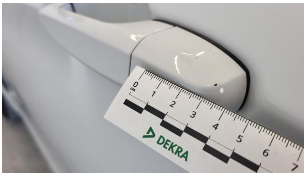
Fot. 57. Klamka drzwi prz L - Rysa/odprysk 1
