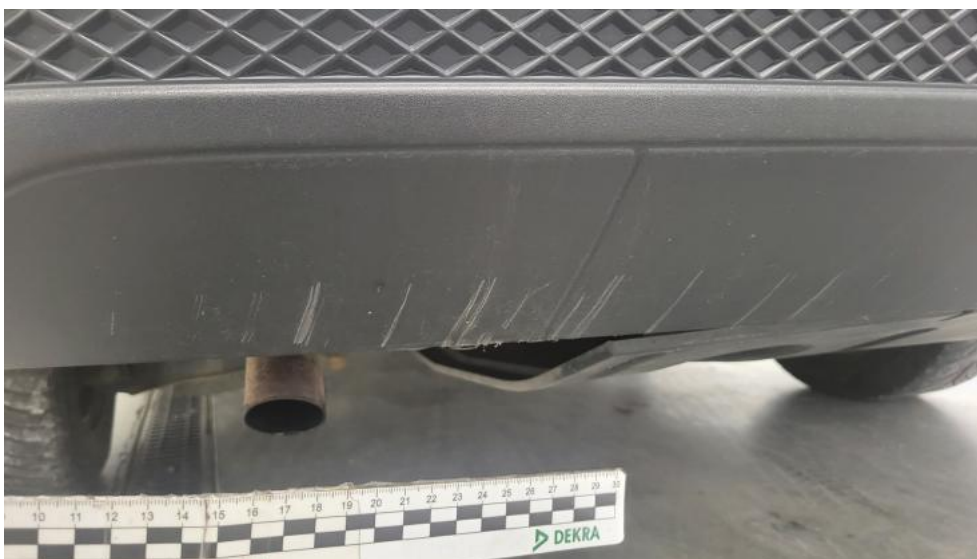
Photo 51. Zderzak tylny - Rysa/odprysk 1
