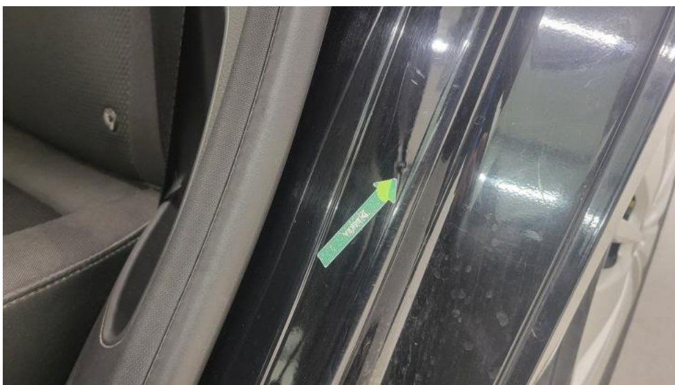
Photo 52. Błotnik tylny L / Ściana boczna L - Wgniecenie/odkształcenie 1
