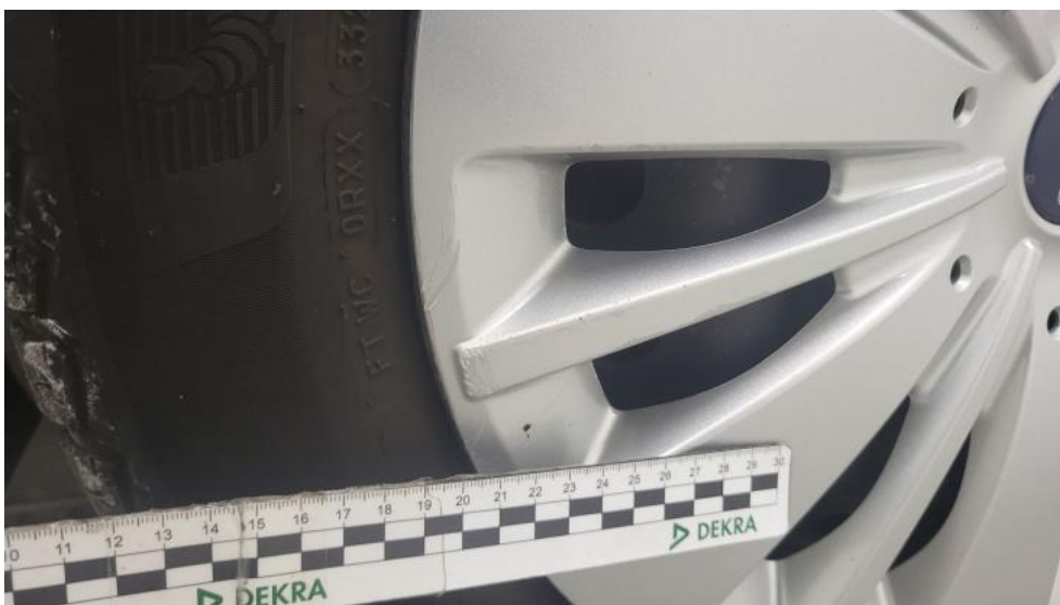
Photo 60. Kołpak przedni L - Rysa/odprysk 1
