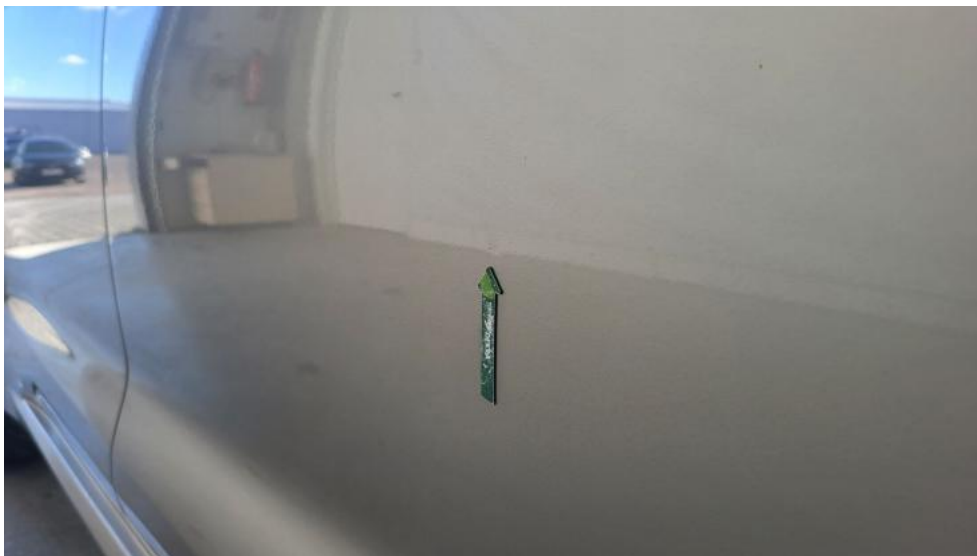
Fot. 45. Drzwi przednie P - Wgniecenie/odkształcenie 1
