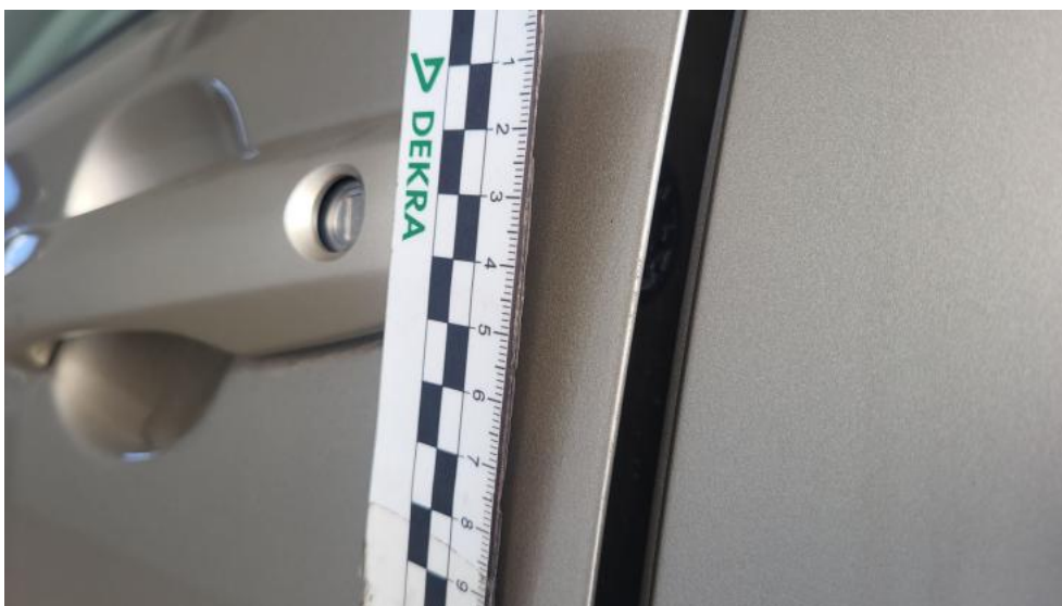
Fot. 48. Drzwi przed L - Rysa/odprysk 1
