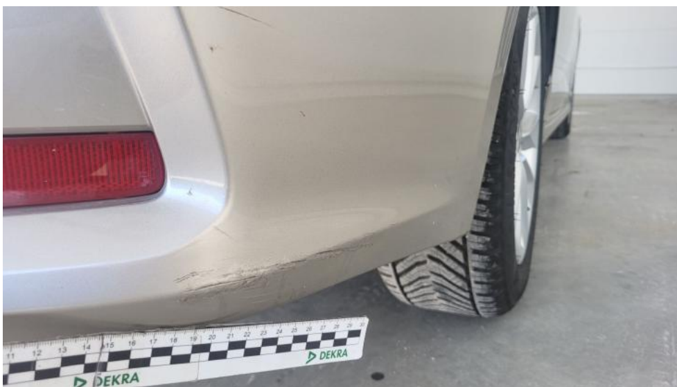
Fot. 47. Zderzak tylny - Rysa/odprysk 2
