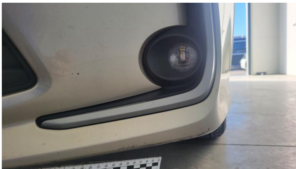
Fot. 42. Zderzak - Rysa/odprysk 1
