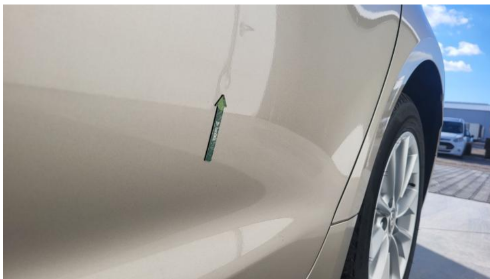
Fot. 50. Drzwi tylne L - Wgniecenie/odkształcenie 1
