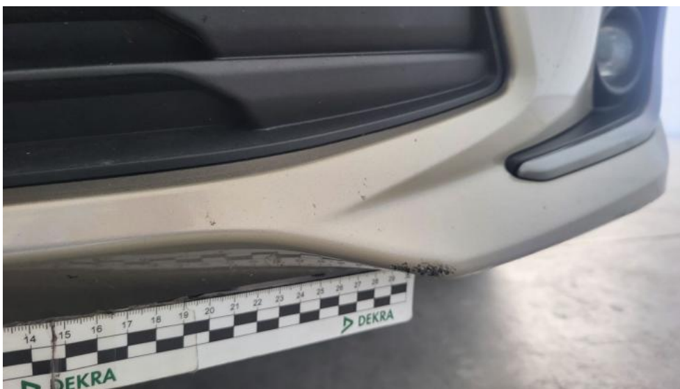
Fot. 43. Zderzak - Rysa/odprysk 2
