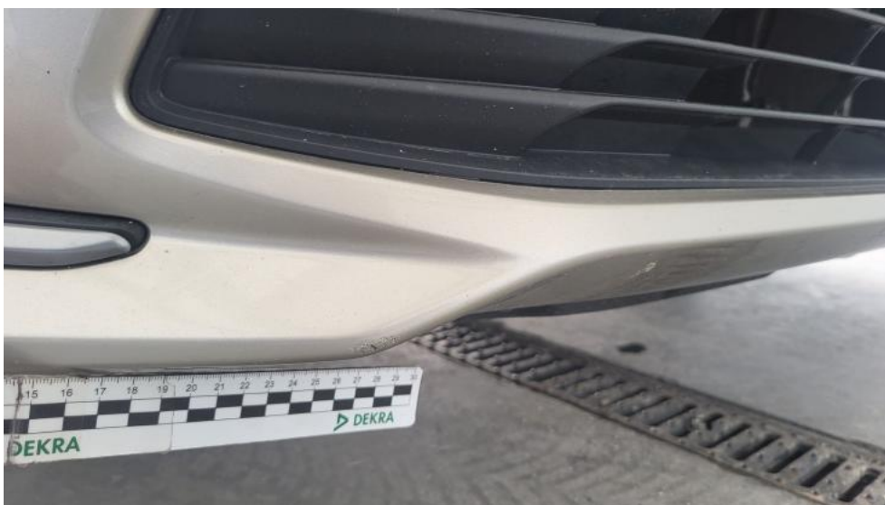
Fot. 44. Zderzak() - Rysa/odprysk 3
