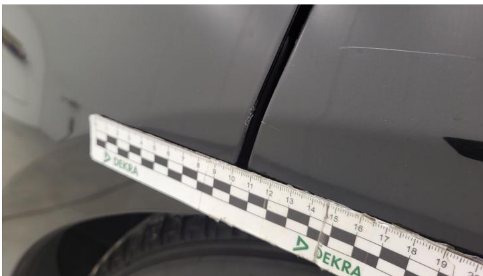
Photo 64. Drzwi tylne L - Rysa/odprysk 1
