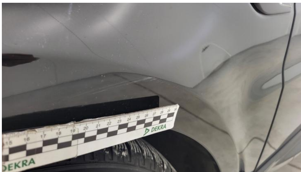
Photo 67. Błotnik przedni L - Rysa/odprysk 1
