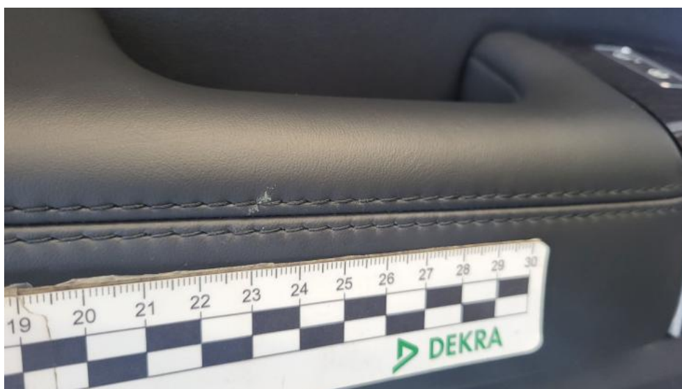
Photo 68. Tapicerka drzwi tylnych L - Rysa/odprysk 1
