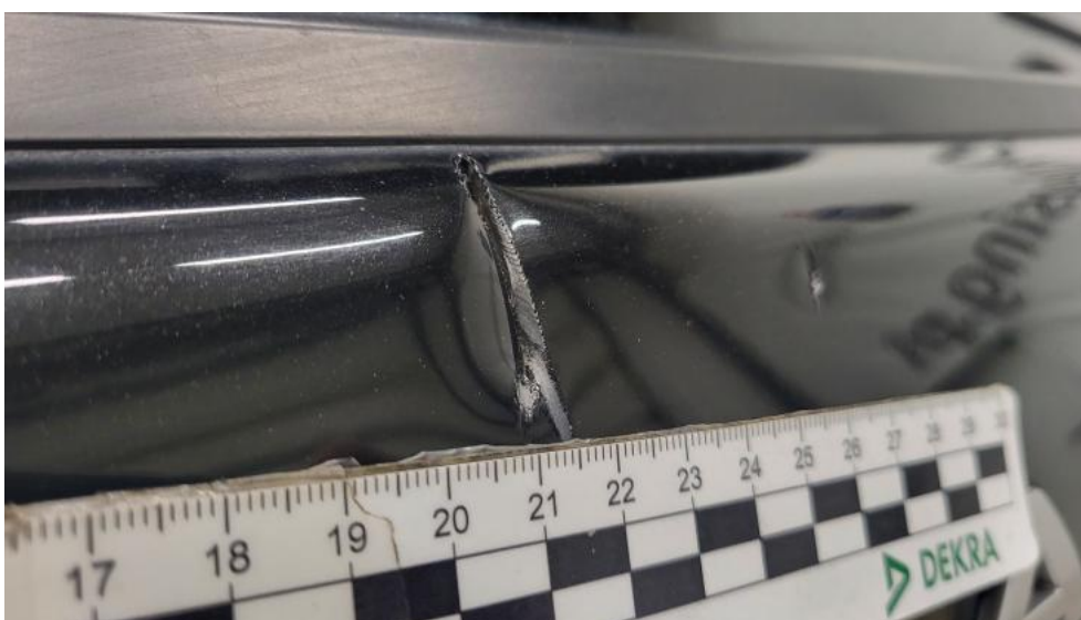
Photo 52. Pokrywy bagażnika - Pęknięcie/rozerwanie 1
