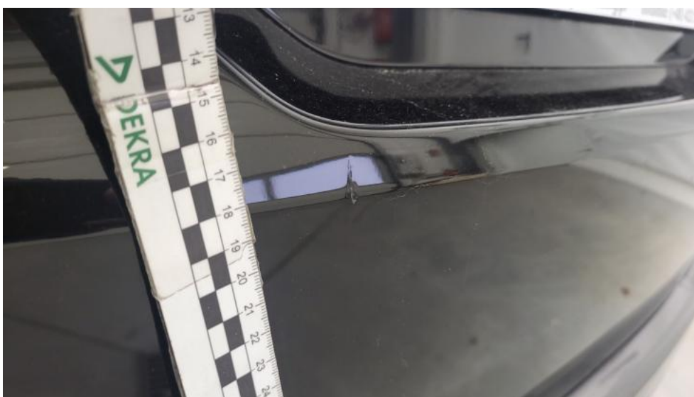
Photo 48. Pokrywy bagażnika - Rysa/odprysk 2
