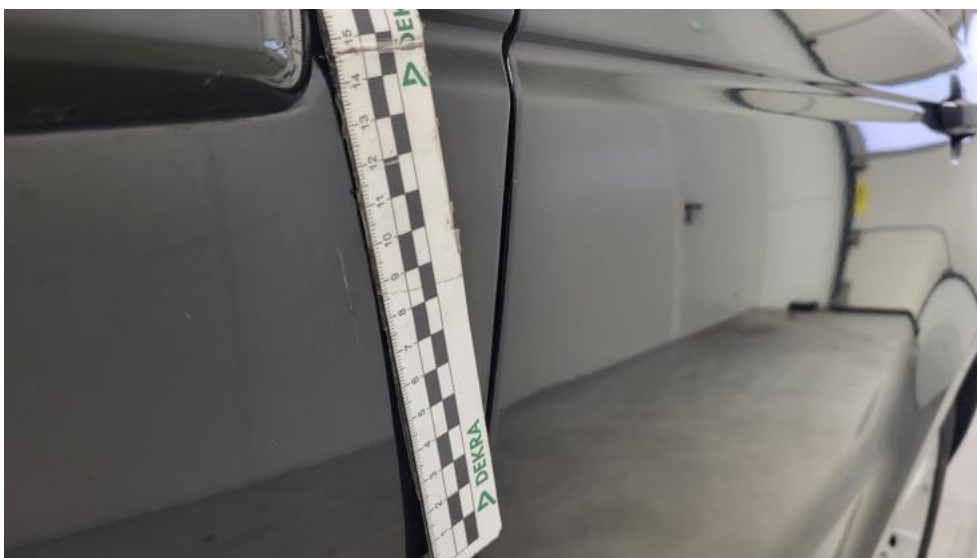
Photo 62. Drzwi przed L - Rysa/odprysk 1
