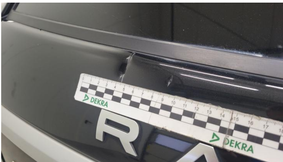
Photo 47. Pokrywy bagażnika - Rysa/odprysk 1
