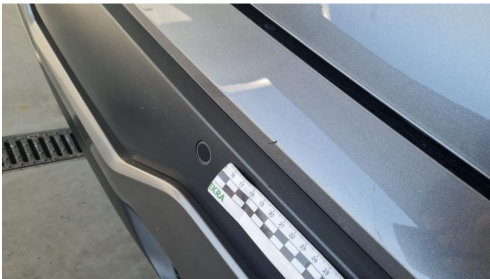
Fot. 37. Zderzak tylny - Rysa/odprysk 2
