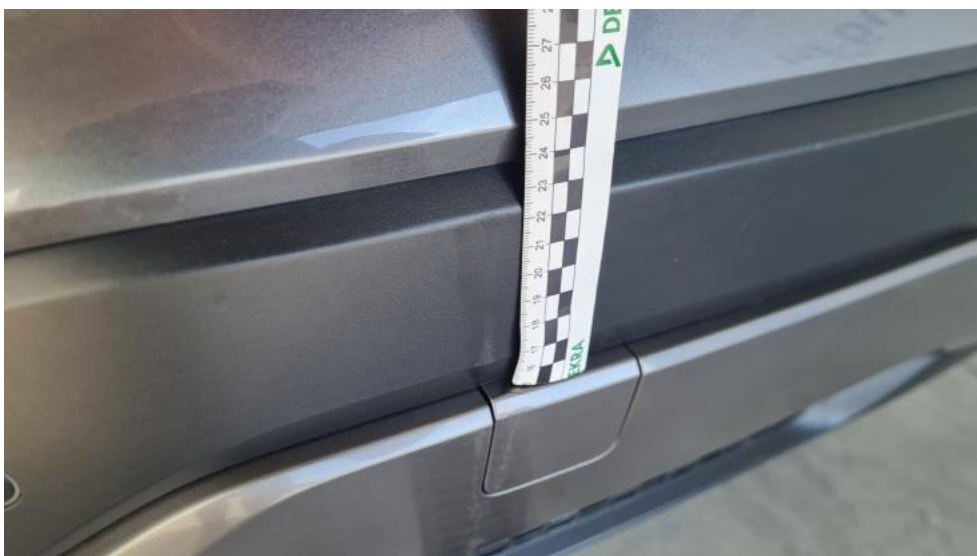
Fot. 38. Zderzak tylny() - Rysa/odprysk 3
