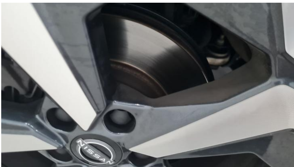
Fot. 18. Tarcza hamulcowa przednia lewa
