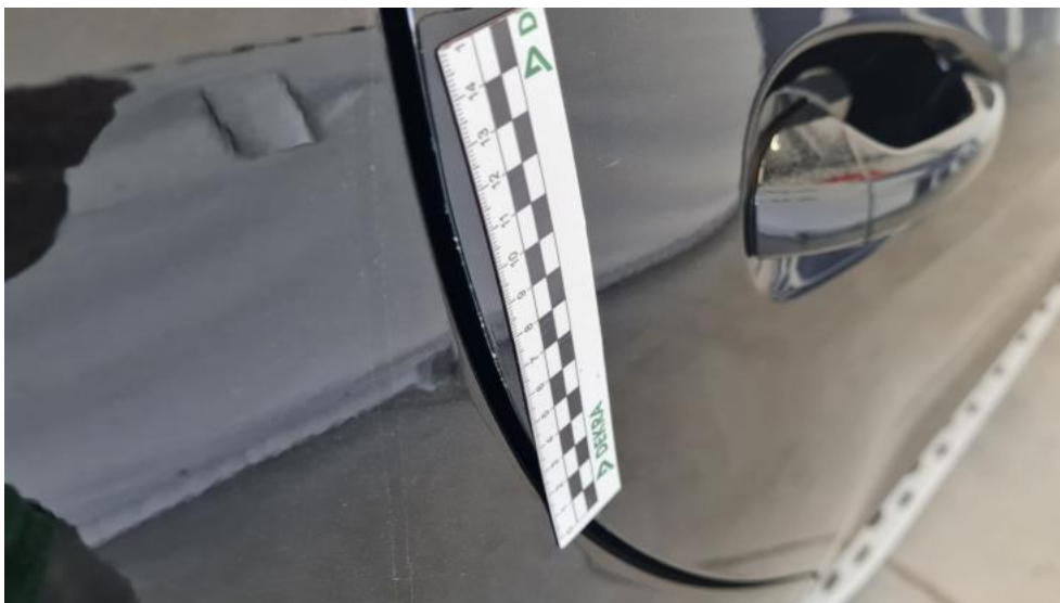
Fot. 45. Drzwi tylne P - Rysa/odprysk 1
