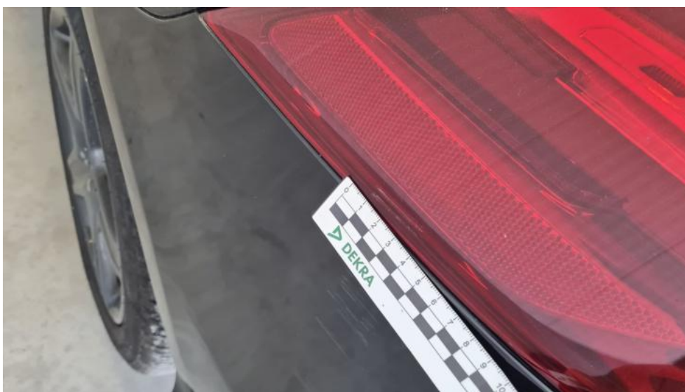
Fot. 59. Lampa tylna zew L - Rysa/odprysk 1
