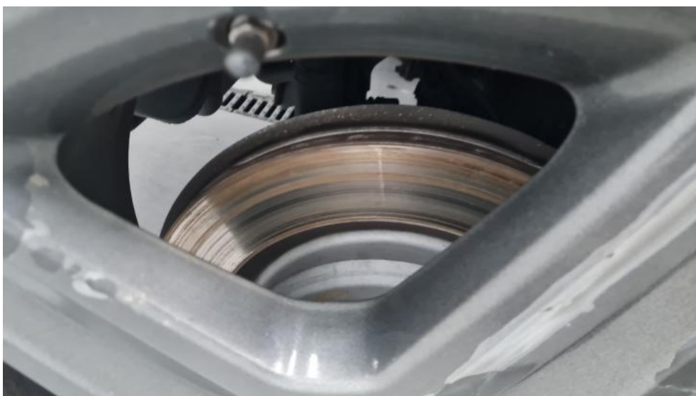
Fot. 16. Tarcza hamulcowa tylna prawa
