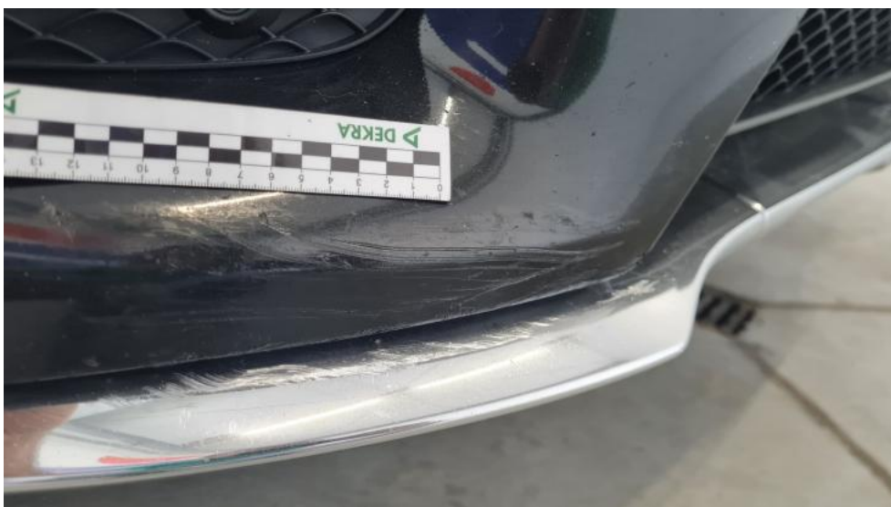
Fot. 42. Zderzak - Rysa/odprysk 1
