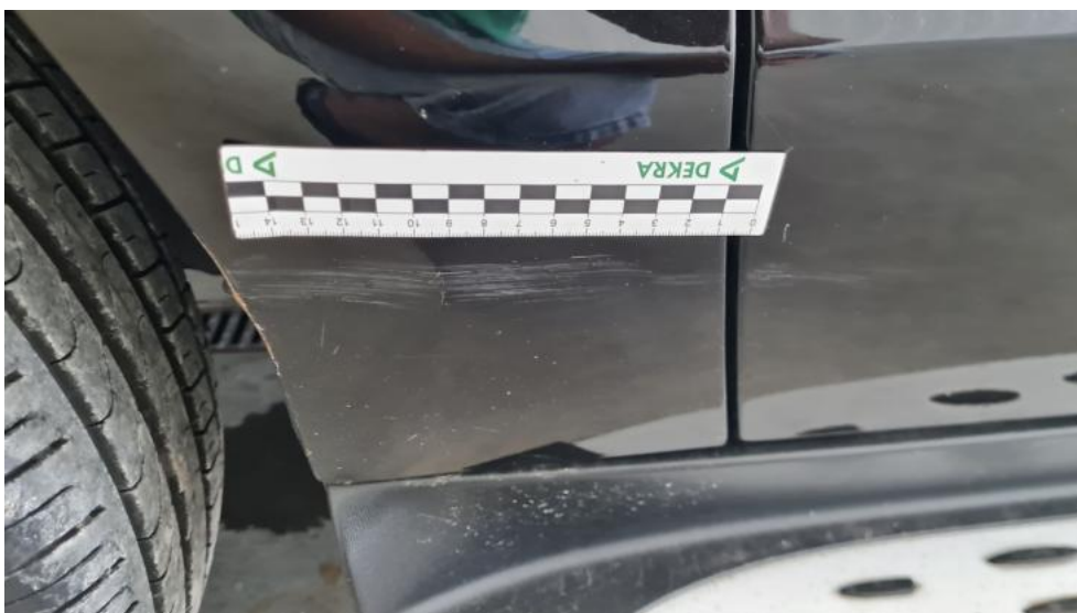
Fot. 68. Błotnik przedni L - Rysa/odprysk 1
