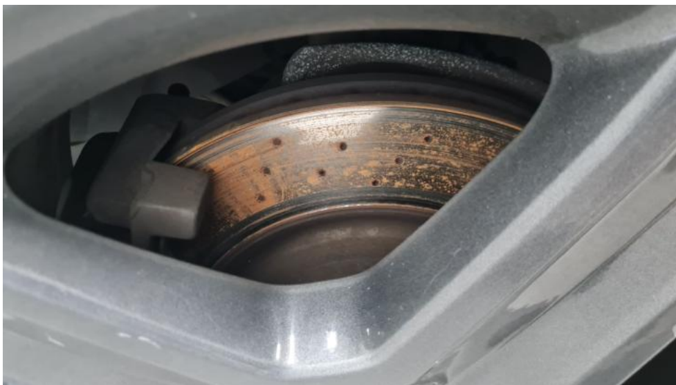
Fot. 15. Tarcza hamulcowa przednia prawa
