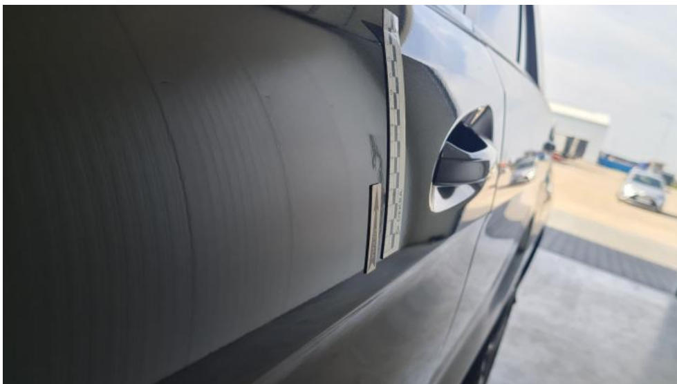
Fot. 63. Drzwi przed L - Wgniecenie/odkształcenie 1
