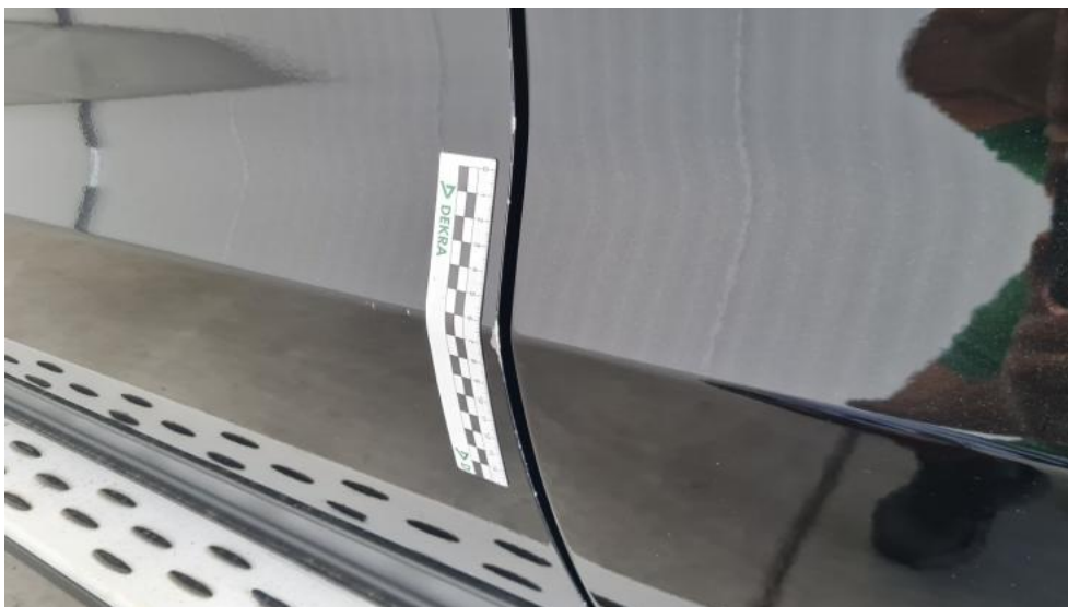
Fot. 61. Drzwi przed L - Rysa/odprysk 1
