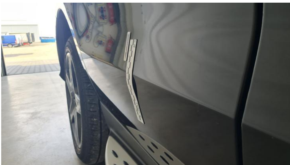
Fot. 46. Drzwi tylne P - Wgniecenie/odkształcenie 1
