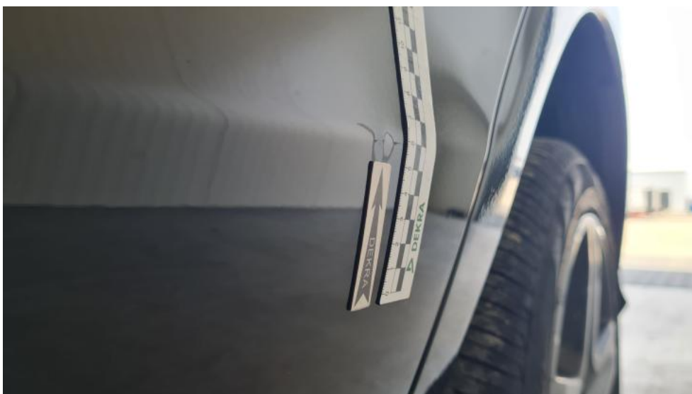
Fot. 66. Drzwi tylne L - Wgniecenie/odkształcenie 1
